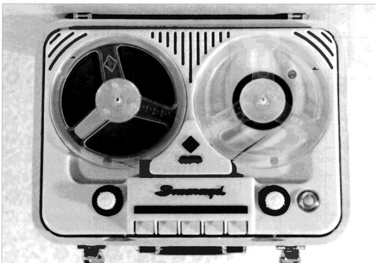
Bild 1: BG 20 „Smaragd“, eines der ersten Geräte mit hellem Gehäuse und ohne Umschalter für die zweite Geschwindigkeit.
