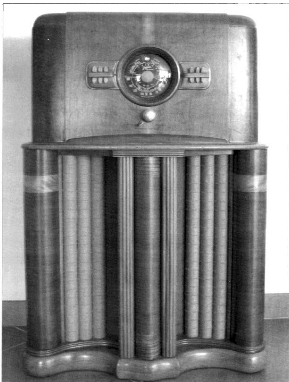
Bild 2: Elf-Röhren-Superhetrorodyne Empfänger mit „Wavemagnet“-Antenne, „Radioorgan“ Klangregister, Stationstasten und 12-inch-Lautsprecher nach der Restaurierung.
