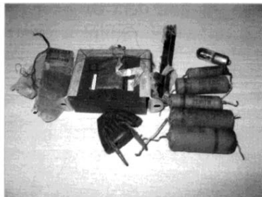
Bild 15: Defekter NF-Trafo, Skalenlampe, Netzstecker und Koppelkondensatoren, die vor der Inbetriebnahme ausgetauscht wurden.
