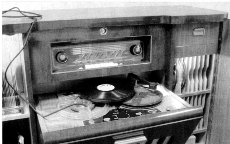
Bild 6: Das kombinierte Magnettonband-Plattenspielgerät wird nach vorn herausgeklappt.
