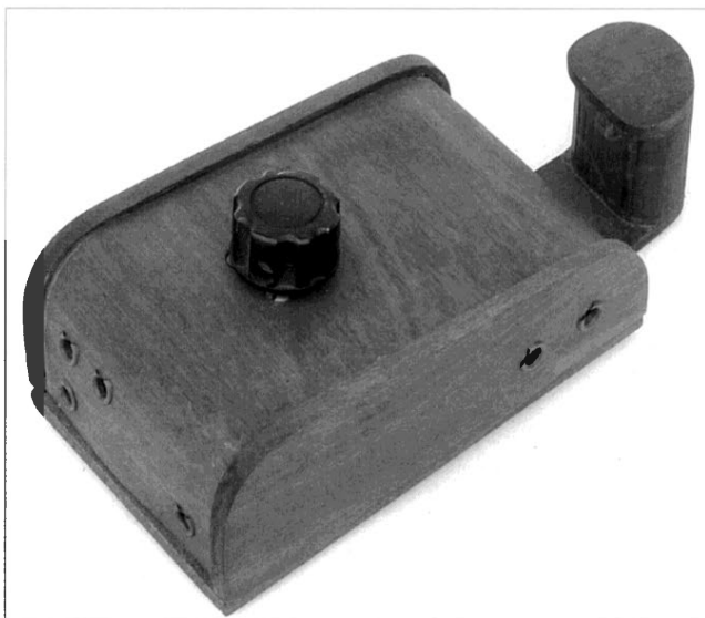
Bilder 11 bis 13: Wanddetektor mit winzigem Kristall-detektor.
