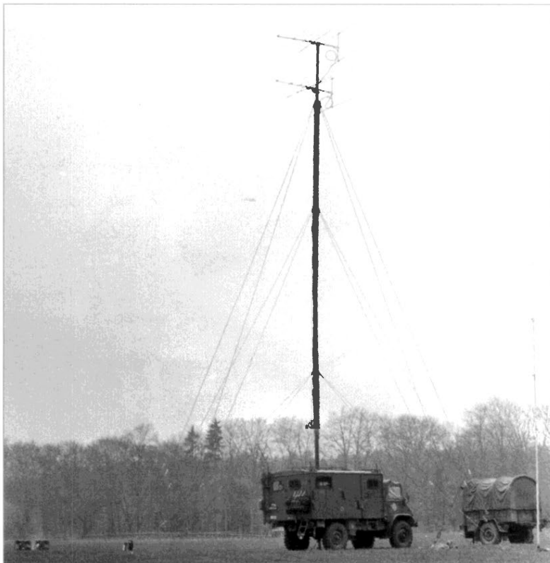
Bild 7: Kommandosendestelle einer HF-FmAufkl-Zentrale mit Kunststoffsteckmast KSM 18 und zwei zusammenschalteten Yagi-Antennen 50–70 MHz.
