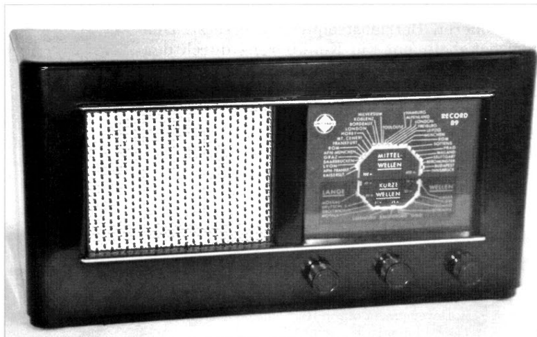
Bilde 1: EMUD Wechselstrom-Gerät Record 89 WKN. Einkreis für K-M-L-Empfang mit Pentoden-Audion sowie Vierfarb-Skala von 1950.
