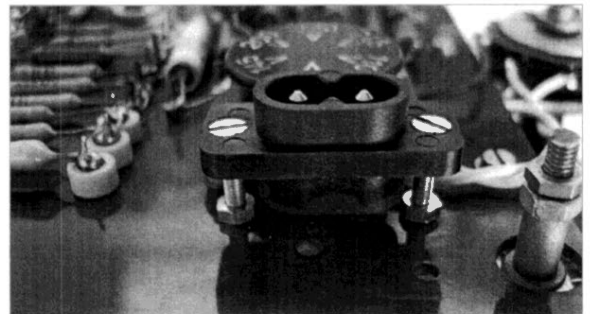
Bild 2: Die neu eingebaute Netzbuchse.
