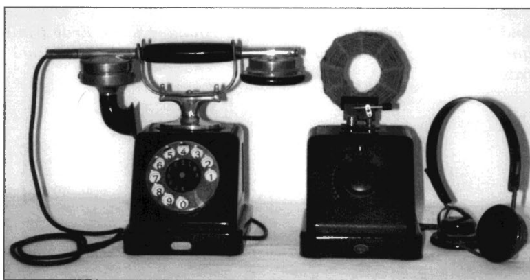
Bild 1: Tischfernsprecher ZB SA 24 von 1924 und TEFAG Detektor-Apparat von 1926 in nahezu gleichen pultförmigen Metall-Gehäusen.
