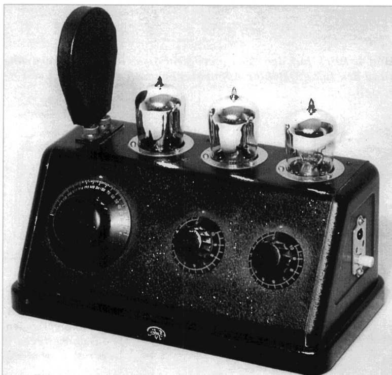
Bild 2: TEFAG Dreiröhren-Audion-Empfänger von 1926 im etwa dreifach verbreiterten Metall-Gehäuse des Fernsprechers ZB SA 24.
