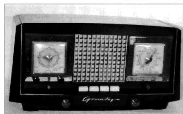
**Bild 2:** GRUNDIG Wechselstrom-Gerät Heinzelmann 1. Uhrenradio mit el. Synchron-Schaltuhr und Superhet für UKW- sowie M-L-Empfang.
