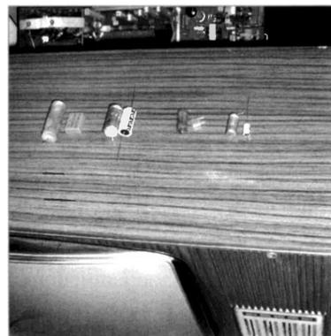
**Bild 4:** Die ersetzten Kondensatoren im Hochspannungsteil.
