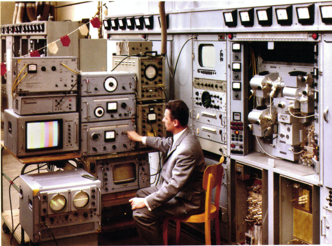
Bild 11: Großer messtechnischer Aufwand im Rahmen der sog. Farb-nachrüstung von SEL-Fernsehse-ndern mit Tetroden-verstärkern.
