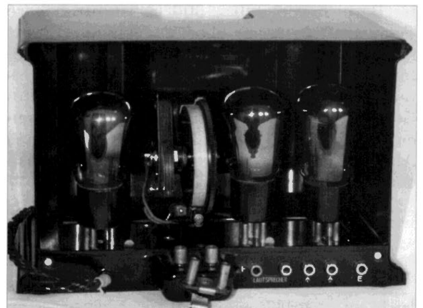
Bild 2: Innenleben des BLAUPUNKT VIII mit drei Röhren sowie Drehkondensator mit Trommelantrieb zur Sendereinstellung.
