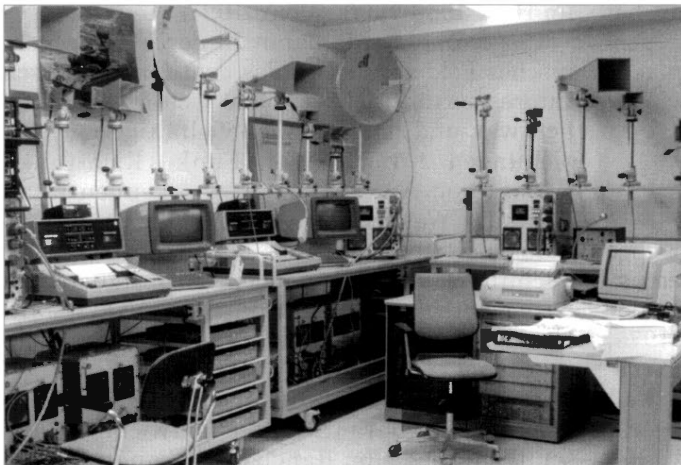
Bild 10 a und b: Zwei Ansichten des Lehrsaals für Elo-Aufklärung in der Fernmeldeschule: Links die „Simulator-Seite“ mit Antekna-Simulator (Steuerung links)
