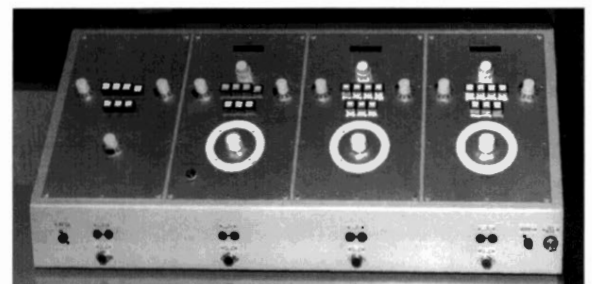
Bild 7: „Übungsgerät Peilfunkausbildung“ der Firma C. Plath zur Simulation von drei Sendern unterschiedlicher Art und Richtung.
