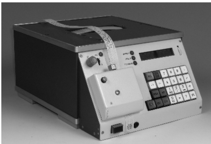
Bild 6: Sprach-Morse-Generator zum Modulieren eines KW-Senders. Dieser wird über Tastatur, Lochstreifen oder Computerschnittstelle programmiert. Er ist englisch beschriftet, weil er an viele „Bruderorgane“ geliefert wurde.
