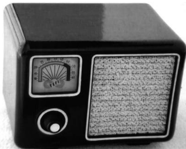
Bild 8: Der TEFI Zwerg GWZ 131 fand auf der Leipziger Frühjahrsmesse 1947 größtes Interesse. Den 3-Röhren-Einkreiser für MW- und LW-Empfang gab es anfangs nur auf Bezugschein für Bergleute.
