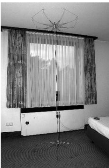
Bild 19: Im Hotelzimmer aufgebaute Regenschirmantenne.
