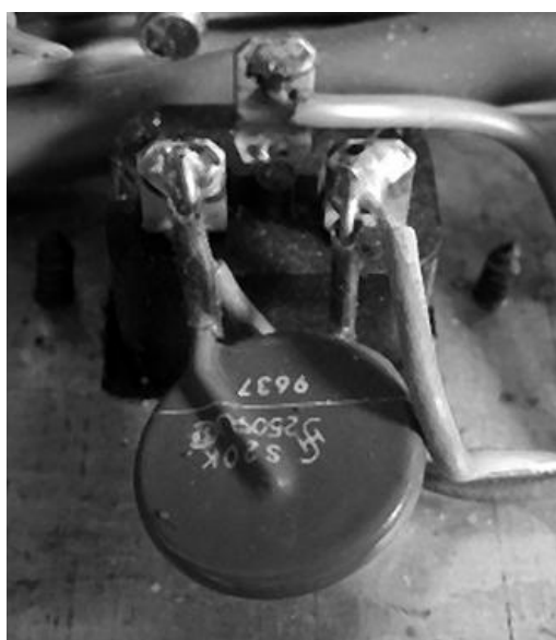
Bild 9: Varistoren schützen das Gerät, aber auch Siliziumgleichrichter vor Überspannungen.
