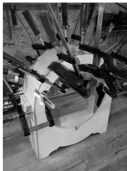
Bild 3 (links): Zusammenbau: Die Rundung wird aus Biegesperrholz angefertigt. Zum Verleimen benötigt man viele Zwingen und Klammern.
