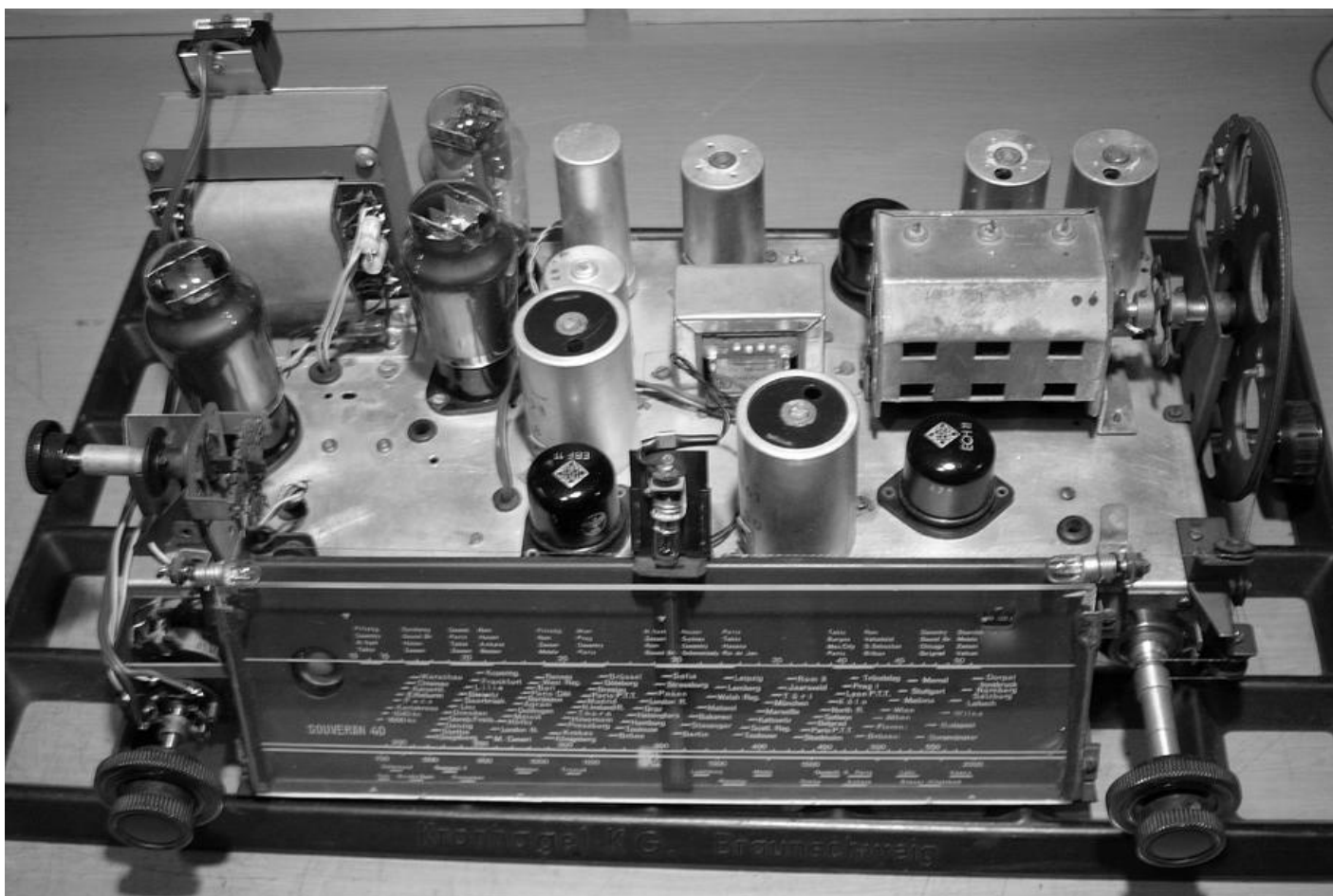
Bild 2: Typisch für Hornyphon-Geräte: übersichtliche Verdrahtung und gute Zugänglichkeit der Bauelemente.
