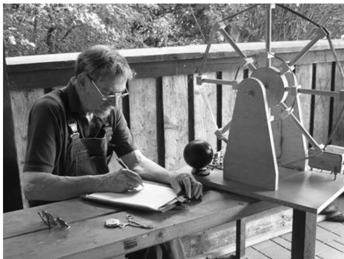
Bild 22: M. Neuss beim SAQ-Empfang mit entdämpfter Rahmenantenne nach DL6OBJ in einer Grillhütte. Bild: P. Balzer
