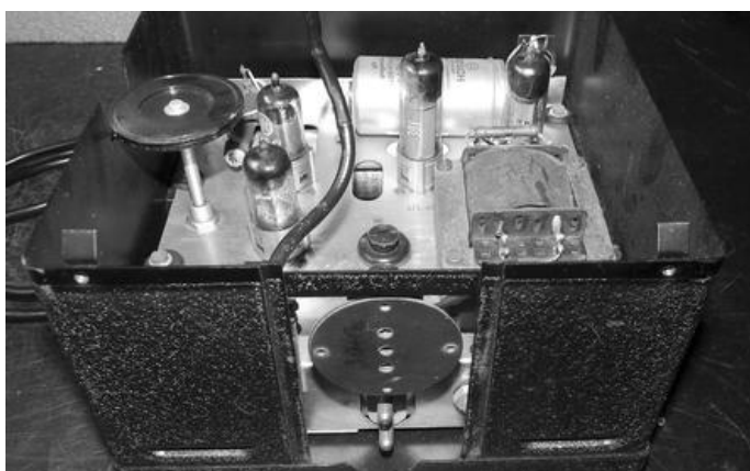
Bild 9: Das geöffnete Gehäuse. Neben den Anschlüssen gibt es nur einen Lautstärkereglер.
