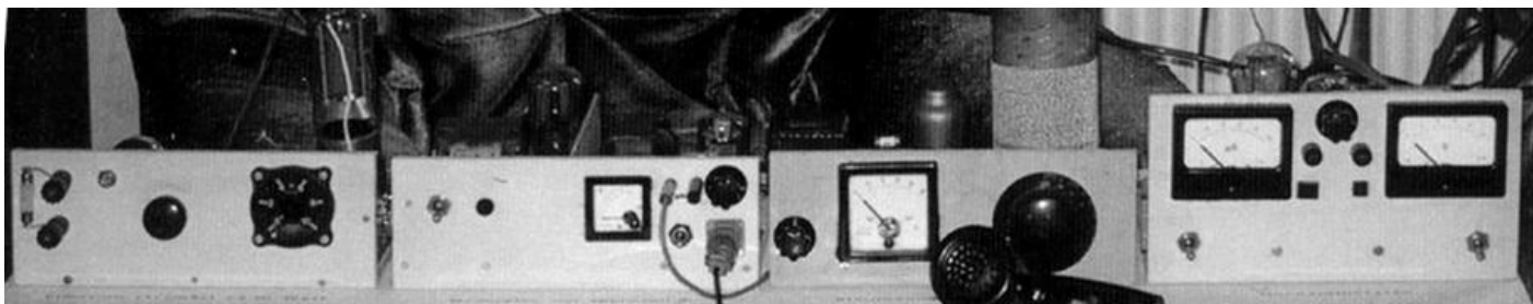
So sind die Module zum Sender zusammengestellt (von links nach rechts): HF-Endstufe, Modulator, Steuersender, Hochspannungsnetzteil. Davor der abgesägte Telefonhörer als Mikrofon.
