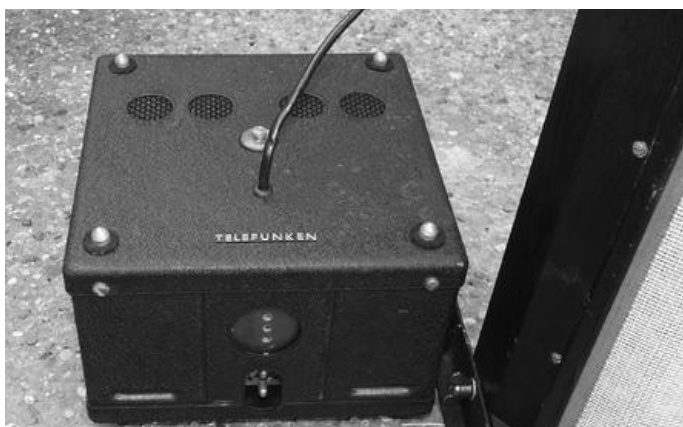
Bild 8: Der Verstärker ist eine schnörkellose Blechkiste mit der Aufschrift „Telefunken“.
