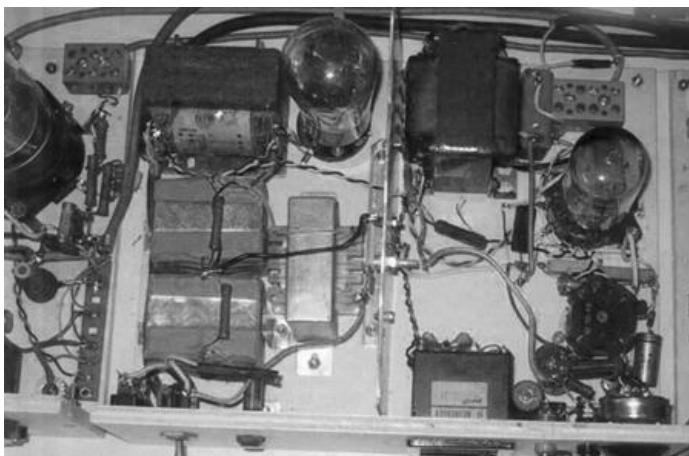
Der Modulator mit RL12P10 und RV12P2000(rechts) und eigenem Netzteil (links).
