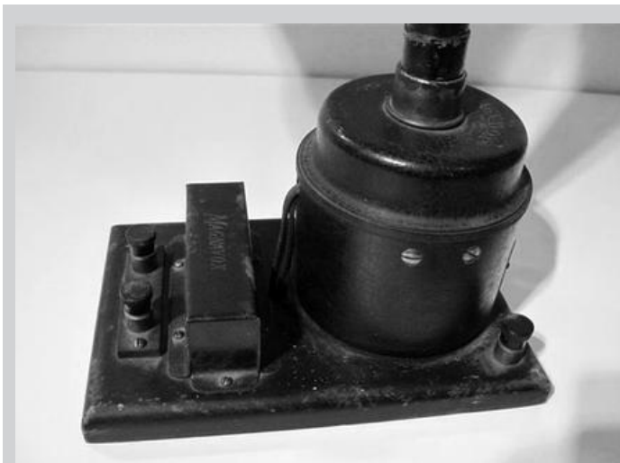
Bild 7: Der Fuß des Trichters mit dem elektrodynamischen System und dem Anpassungstransformator.
