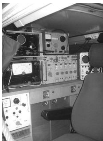
Wichtigster Teil der technischen „Inneneinrichtung“: Panoramaempfänger, Störmessgerät, Frequenzmesser..
