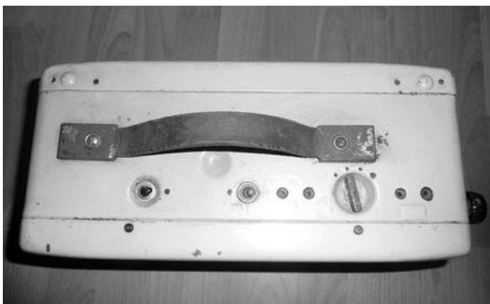
Bild 1: Das Gerät von oben, hier gibt es keine gravierenden Abweichungen, also 2 x Kopfhörer-Anschluss, TA am Schalter blockiert und nicht verdrahtet.
