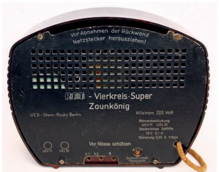
Bild 11: Rückwand des „Zaunkönig“ mit den wesentlichen Informationen. Wenn sie fehlt, droht der Stromschlag!
