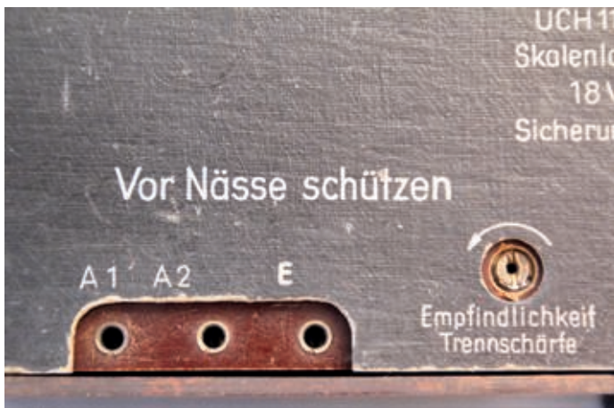
Bild 12: Beim „Zaunkönig“ wurde der Flachtrimmer zum Einstellen von „Empfindlichkeit/Trennschärfe“ (ZF-Rückkopplung) neben den A-E-Buchsen platziert.
