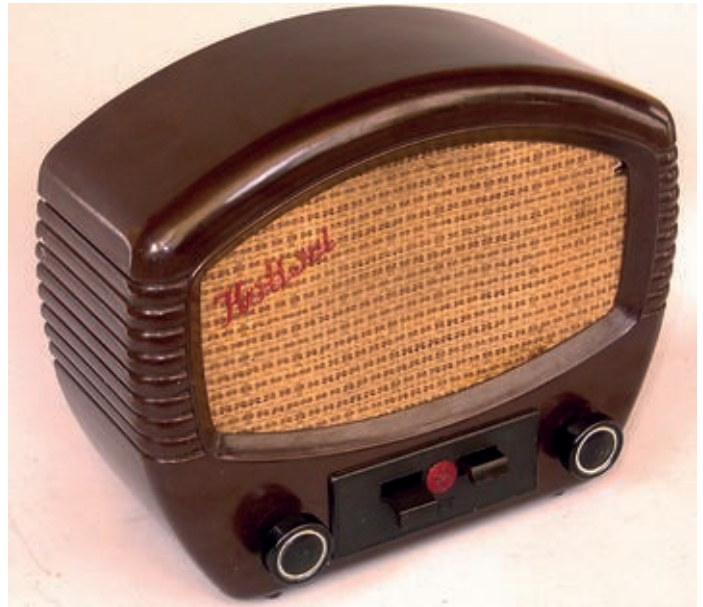
Bild 1: RFT Einkreis-Audion-Empfänger „Kolibri“ von 1953/54 mit zwei Drucktasten zur Wahl fest eingestellter Sender auf MW und LW. Bild: Wolfgang Eckardt, Jena.
