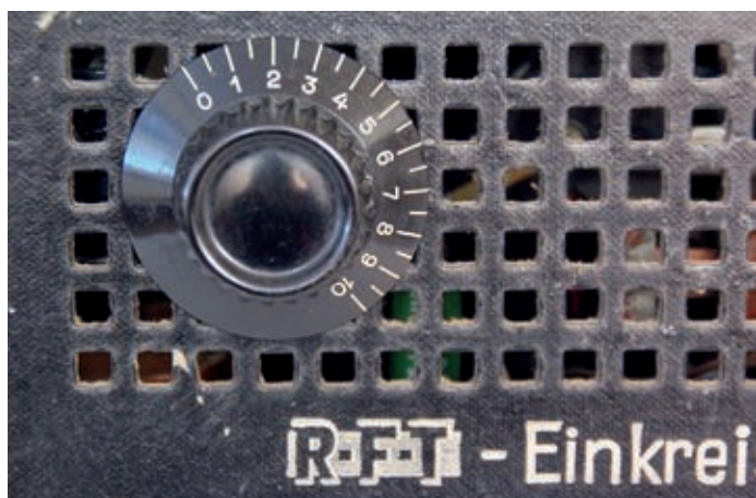
Bild 8: Drehknopf des an der Kolibri-Rückwand nachträglich montierten Flachdrehkos, zuvorderst zum Einstellen von „West-Sendern“.
