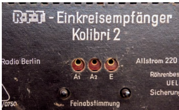
Bild 6: Zwei dünne Spindeln zur Feinabstimmung der fest eingestellten DDR-Sender sind auf der Rückwand des „Kolibri 2“ zu erreichen.
