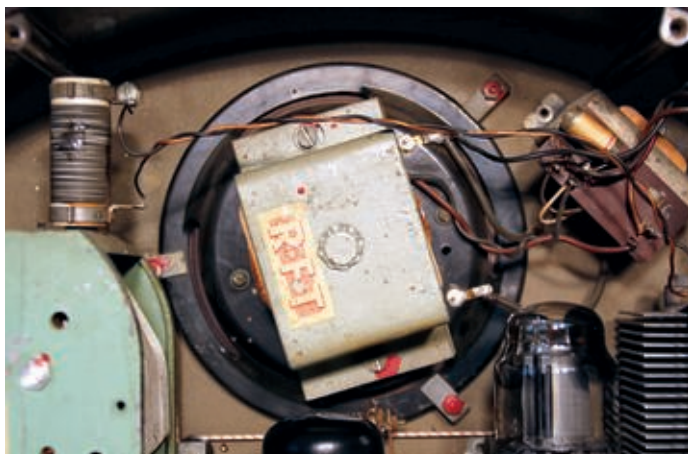
Bild 14: An der Zaunkönig-Schallwand innen befestigter elektrodynamischer Lautsprecher (D = 130 mm) mit zugehörigem Übertrager.
