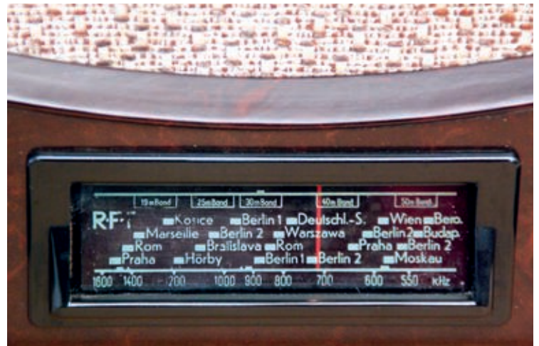
Bild 10: Flucht-Glasskala des „Zaunkönig“ mit MW-Frequenzbereich und Sendernamen sowie fünf KW-Bändern auf nur 94 mm x 27 mm Fläche.
