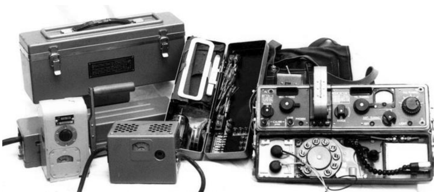
Funkgerät R-353: Links oben Satz 12-Volt-Silber-Zink-Akkus, darunter Transverter-Stromversorgung, Akku-Handlader und Akku-Netzladegerät, Mitte Ersatzteilsatz mit Röhren, Sicherungen, Lämpchen, Magnetband für Codierer, rechts Funkgerät, links oben Empfänger, rechts Sender, Mitte Codier-Tonbandgerät mit aufgesetzter Kassette, unten im Deckel: Ohrhörer, Wählscheibe für Funkprüche, (Zahlen, 0 ... 9), neben der Wählscheibe kleine Handtaste und Lampe, ganz rechts Abstimmtable.
