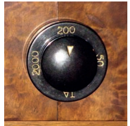
Bild 8: Wellenschalterknopf. Der kleine Knopf dient der gemeinsamen Klangfarbe- und Bandbreite-Einstellung.
