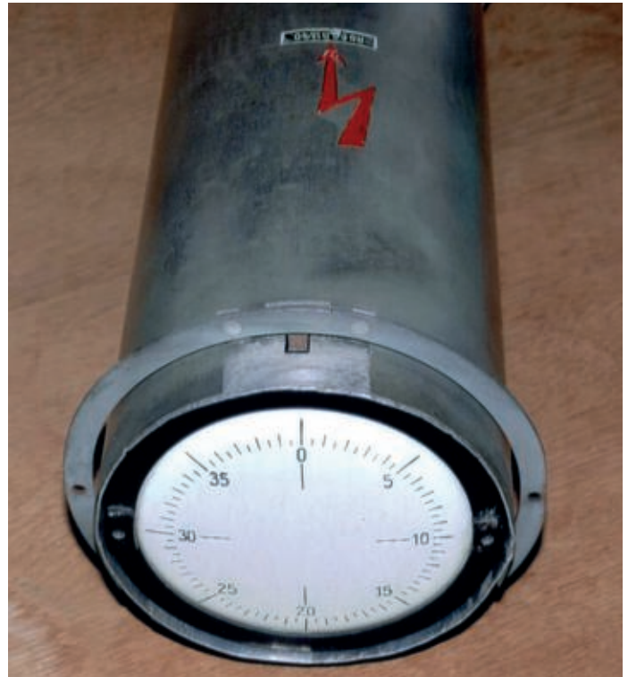
Bild 2: Alle Übersichtsmodule (Codename „Mars“) der FuMG 62-Serie waren mit dieser Polarkoordinatenröhre LB13/40 zur groben Entfernungsmessung der erfassten Ziele ausgestattet. Diese spezielle Braunsche Röhre war eine rein deutsche Entwicklung. Die verschiedenen Röhrenauführungen sind in [5] aufgelistet und gut beschrieben. Eine Versuchsanordnung sowie die Simulation von „Enttrübungsverfahren“ findet man ebenfalls. Die Skalenteilung war bei den Flachschirmen der LB13/40 feiner ausgeführt, mit Einführung des „Emil-Gerätes“ ab 1941 (Phasenschieber-Entfernungsmesser) genügte wahrscheinlich diese Grobeinteilung.
