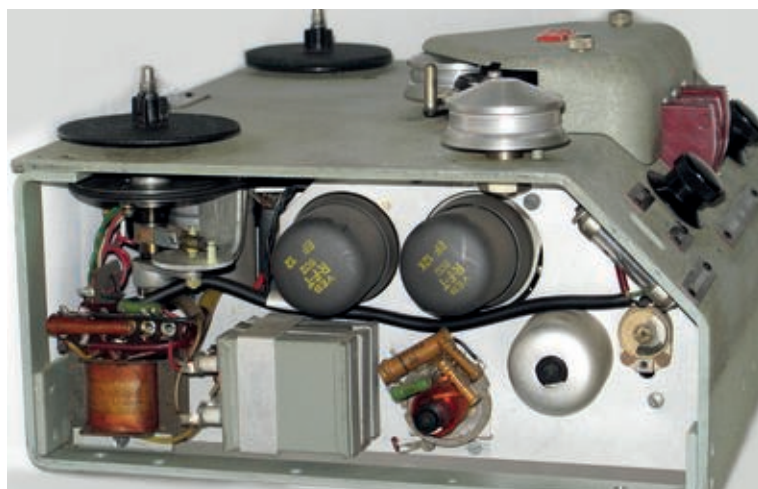
Bild 4: Die zwei Röhren EF12 sind zuständig für die NF-Verstärkung bei Wiedergabe sowie für die Erzeugung der HF-Vormagnetisierung.
