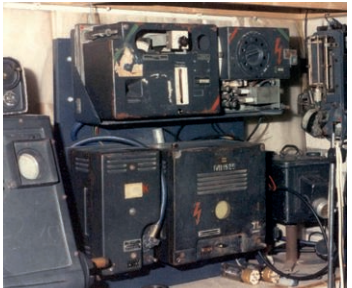
Bild 9c: Weitere Baugruppen des FuMG 62 D. Unten links „Zobel“ = ZF-Verstärker, daneben „Igel“ = Impulserzeugung mit Braunscher Röhre LB1. Oben links Senderüberlagerer Sü62 = „Michael“, daneben Impulssender mit LS180 = „Lokomotive“.
