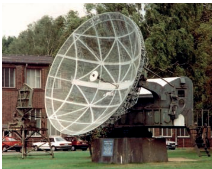
Bild 4a: Standort: Luftwaffenmuseum Uetersen. Während die „normalen“ Würzburg-Geräte einen Metallspiegel von 3 m Durchmesser aufwiesen, wurde zur Steigerung der Entfernung beim „Würzburg-Riesen“ der Parabolschirm auf 7,5 m erweitert. Die Konstruktion übernahmen die Zeppelinwerke in Friedrichshafen am Bodensee, die im stabilen Leichtbau große Erfahrung besaßen (Luftschiffbau). Der Drehstandantrieb stammt von AEG, das Gesamtgewicht betrug etwa 18 Tonnen.
