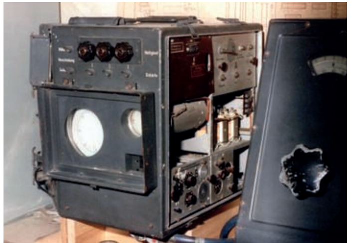
Bild 9a: Hier die Gerätekomponente ANG 62 „Mars“ mit Obersichtsröhre LB13/40 und Peilanzeige-Seite mit der LB1.
