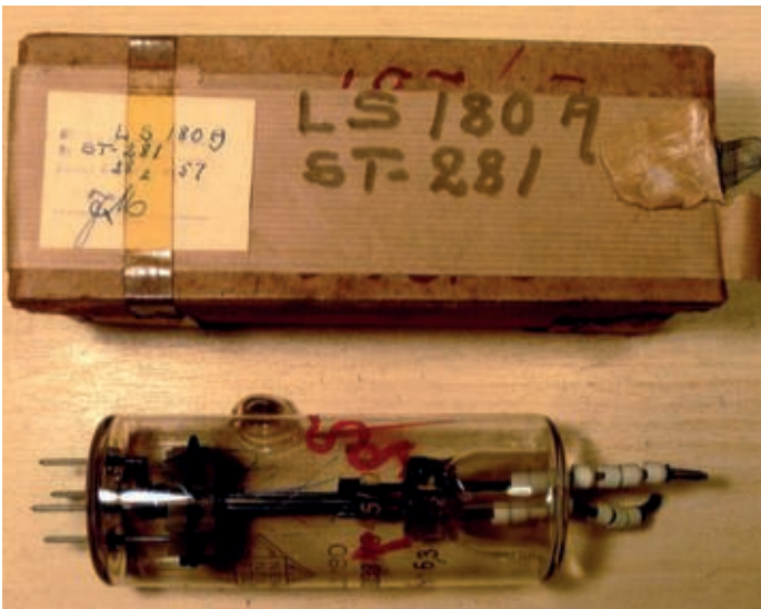
Bild 3: Der Tastsender (Codename „Lokomotive“) des Würzburggerätes war mit der Tastriode LS180 bestückt. Dieses Muster (auf der DNAT Bentheim 1993 erworben) im Karton hat einen Aufkleber in dänischer oder norwegischer Sprache mit dem Datum 28/2/1957 - eventuell noch aus Lagerbeständen der Besatzungszeit. Man erreichte damit eine Impulsleistung von 8 kW. Gegentakt-Tastsender mit zweimal LS180 sollen auch entwickelt worden sein (Bild aus [3], Seite 40).
