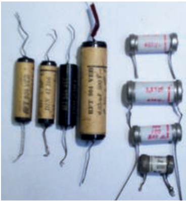
Bild 5: Die „Teerkondensatoren“ wurden durch unverwüstliche Sikatrop-Kondensatoren ersetzt.
