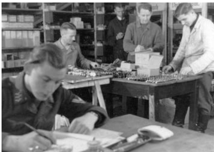
Ersatzteillager. Hier bei der Bereitstellung der Teile für den Umbau der Sichtgeräte zur Vermeidung von „Düppel“-Störungen.
