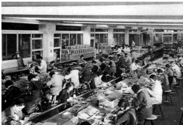
Bild 1: Typische Radioproduktion der 1940er-Jahre: An langen Produktionsstraßen sitzen jede Menge Frauen, die fleißig an Radiochassis schrauben, löten, verdrahten und bestücken, hier bei SABA.
