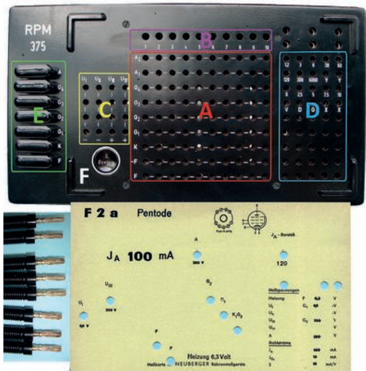
Bild 5. Multifunktions-Einheit (Universal-Schaltvorrichtung) mit Beispiel einer Prüfkarte. (A: Kreuzschienenverteiler, B: Buchsen zu externen Röhrenfassungen, C: Spannungsschaltgruppe, D: Prüfschaltgruppe, E: Einschleif-Kurzschlussstecker, F: Taster für II. System).
