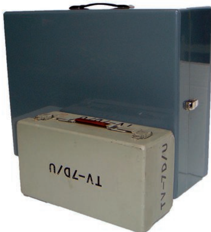
Bild 1. Neuberger RPM 375 im Größenvergleich mit dem amerikanischen Röhrenprüfgerät TV-7D/U. Beide hochqualitativen Geräte stammen etwa aus der gleichen Zeit und sind für einen ähnlichen Benutzerkreis konzipiert. War das RPM 375 (60 x 50 x 23 cm 3 , 30 kg) nur für rein stationären Betrieb ausgelegt, ist das wesentlich kompaktere und nur 8 kg wiegende TV-7D/U portabel. Trotz völlig unterschiedlicher Konzeption und Messprinzipien sind beide Geräte etwa gleich leistungsfähig.
