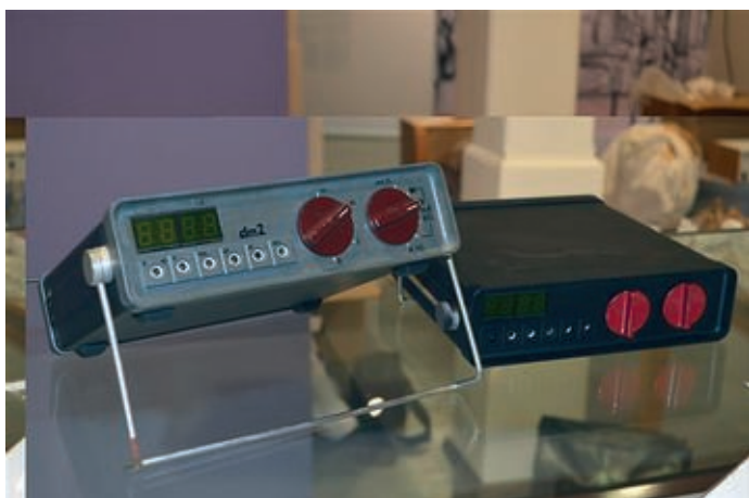
Funktionsmuster eines Multimeters, von dem nur drei Exemplare produziert wurden.
