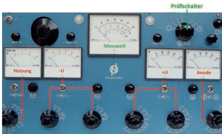
Bild 6: Spannungseinstellung und deren Zuordnung zu den Anzeigeinstrumenten. Während für die Heiz- und die Anodenspannung jeweils ein eigenes separates Instrument vorhanden ist, teilen sich die beiden negativen Gitterspannungsquellen (2. & 3. Schalter/Regler von links) und die beiden positiven Gitterspannungsquellen (4. & 5. Schalter/Regler) jeweils ein umschaltbares Anzeigeinstrument. Oben Mitte: großes Instrument zur Messwertanzeige; oben rechts: Prüfschalter.
