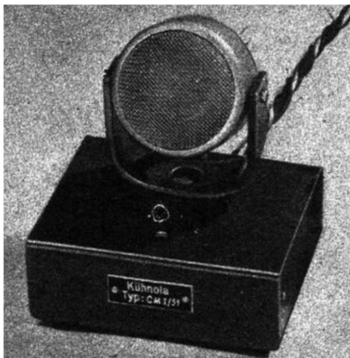
Selbstgebautes zweistufiges Kondensator-Mikrofon mit der Telwa-Kapsel C 6. Quelle: Kühne, F.: Mikrofone, Aufbau, Verwendung und Selbstbau. RPB-Band 11, S. 40 (1951)
