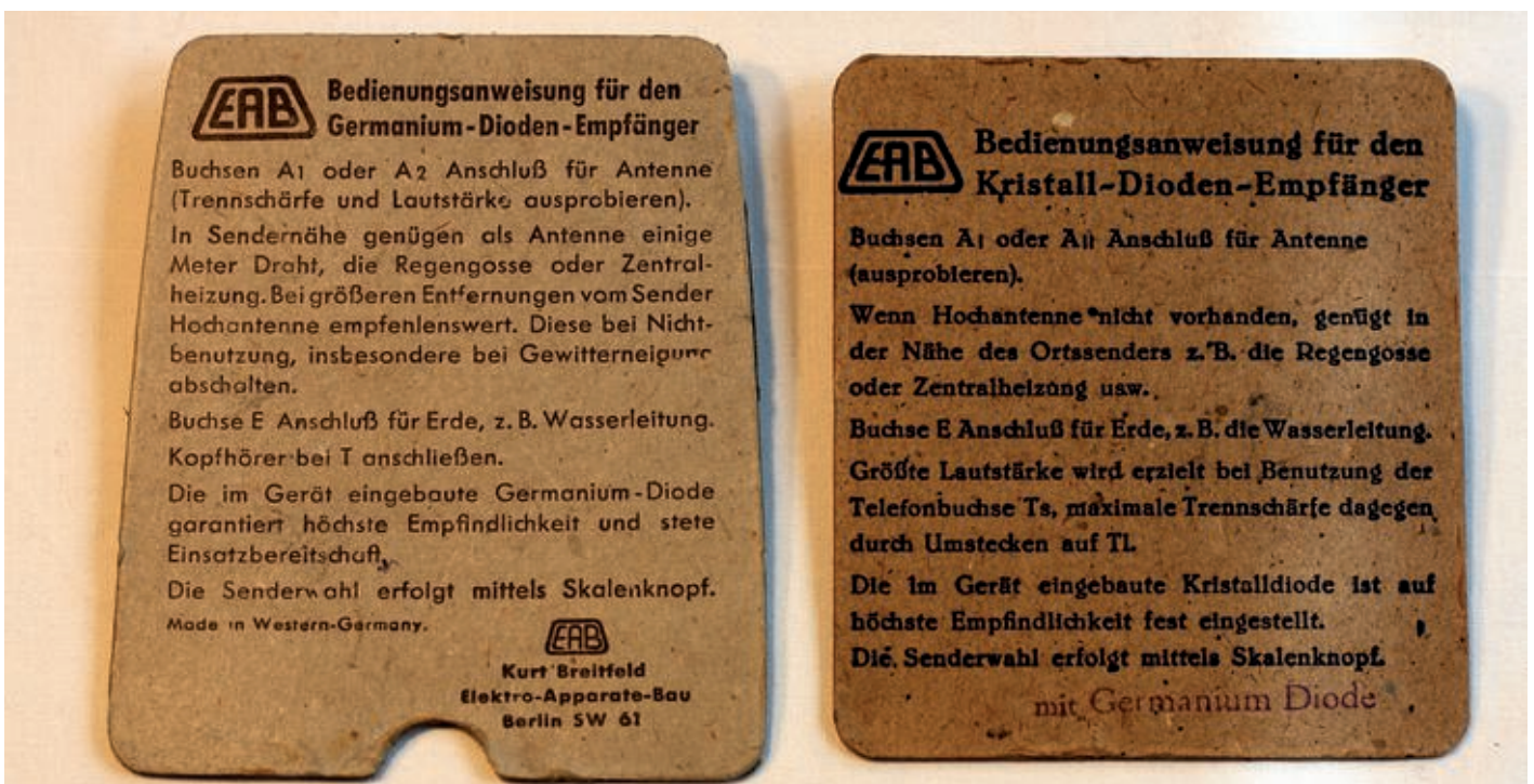
Bild 4: Bodendeckel, jeweils mit EAB-Firmenlogo sowie etwa gleicher „Bedienungsanweisung“. Beim „Delu“ (links) findet man zudem auch den Firmennamen des Herstellers.
