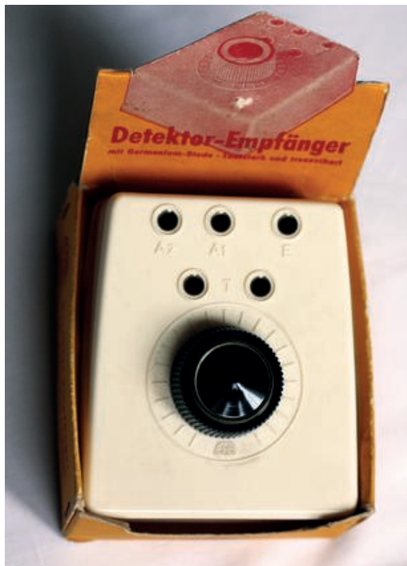
Bild 5: Die Original-Schaupackung mit dem darin aufgestellten EAB-Detektorempfänger „Delu“.
