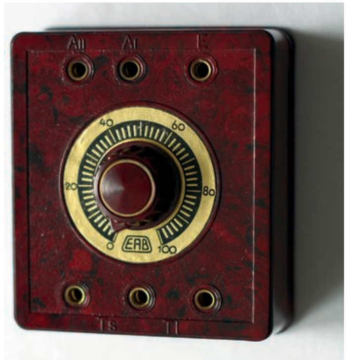
Bild 1: Standardmodell des EAB Detektorempfängers von 1953 im braunen Kunststoffgehäuse, anfangs oftmals mit innerem Kristall-Gleichrichter (Galenit/Bleiglanz?) und kurz darauf nur noch mit Germanium-Diode.
