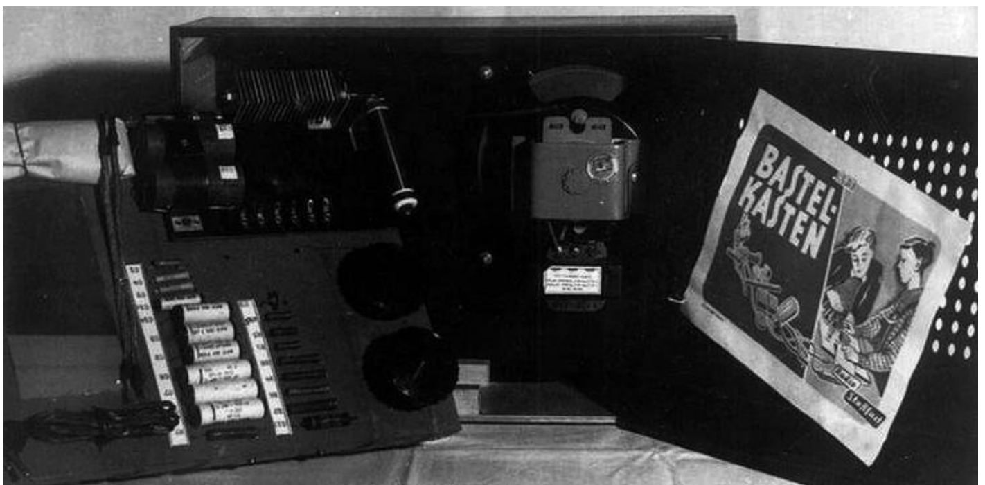
Bild 2. So wurde der „Bastelkasten“ ausgeliefert: Auf der „Aufsteckgruppe“ sind die Teile übersichtlich und mit entsprechenden Bezeichnungen versehen aufgesteckt.
