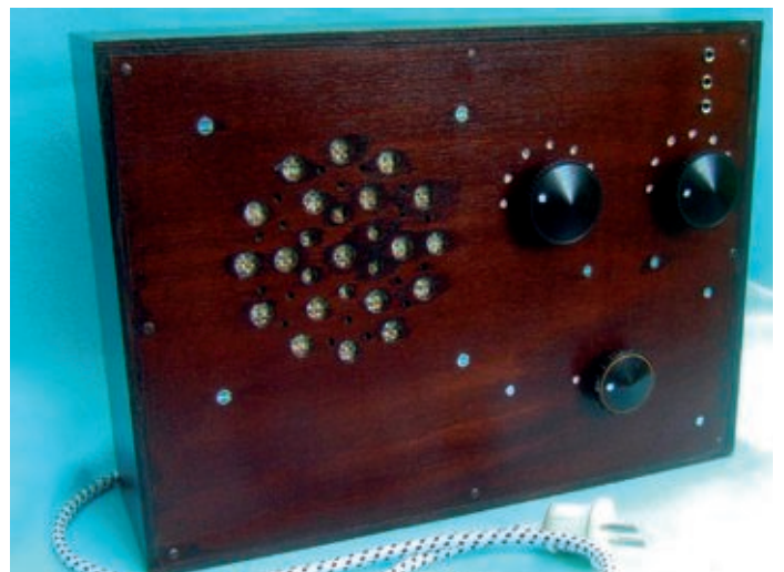
Bild 9. Der Verfasser fertigte sein Gehäuse aus Buchen-Sperrholz, das sich präziser bearbeiten lässt als Pappe. Bild: Peter von Bechen
