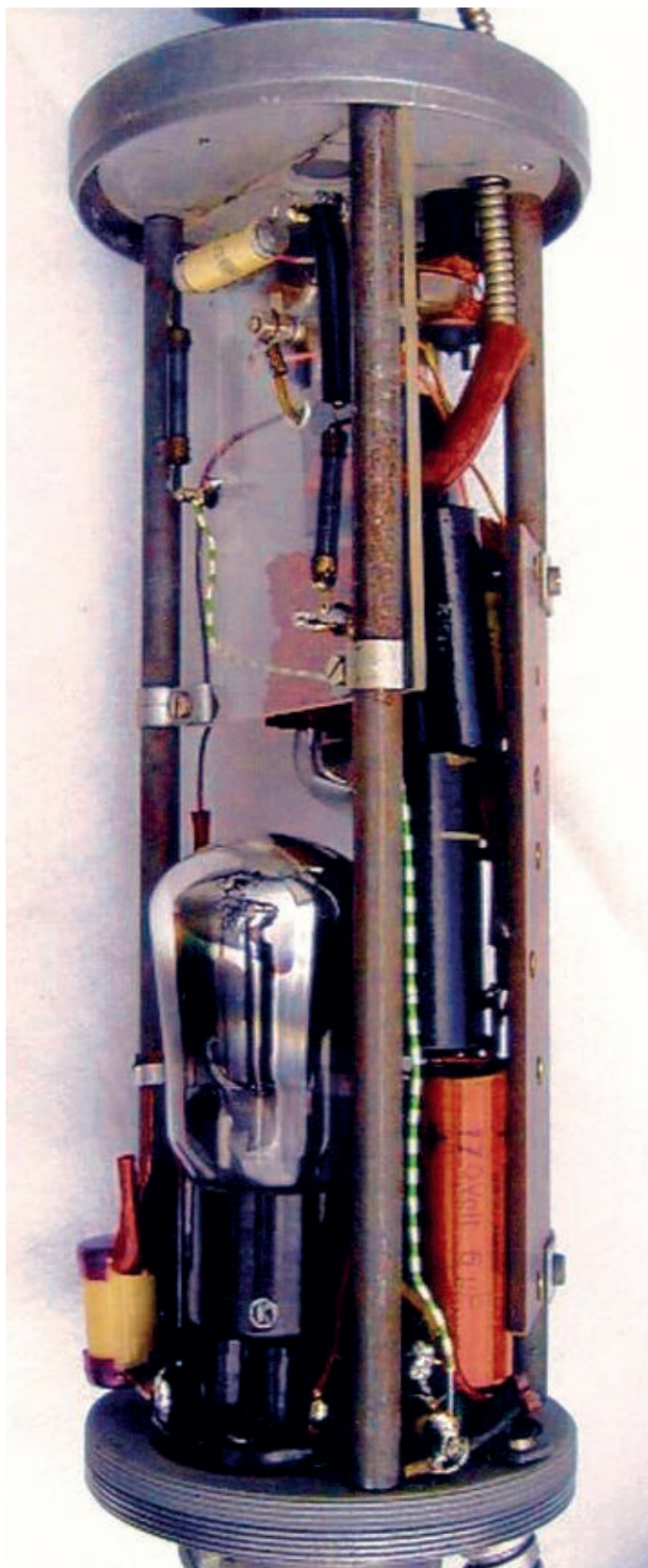
Die Ausgangsstufe mit einer zweiten Valvo-Triode A408k ist hier zu sehen. Drei Distanzstücke bilden das Gerüst für den Schaltungsaufbau mit großen Kondensatoren mit Teervergussmasse. Es kommen aber auch hochwertige Sicutrop-Kondensatoren zur Anwendung. „Originell“ ist auch die Verwendung von Rohrschellen. Die abgeschirmten Leitungen (Kapsel, Stromversorgung, Ausgangssignal) sind mit den damals üblichen Metallschläuchen ausgeführt. Bild: M. Damaschke
