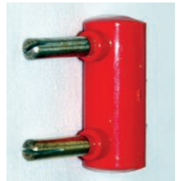
Bild 6: „Kristalldioden-Aufsteck-Detektor“ von EAB um etwa 1955. Die Germaniumdiode ist in die rote Kunststoffkapsel eingeschweißt.
