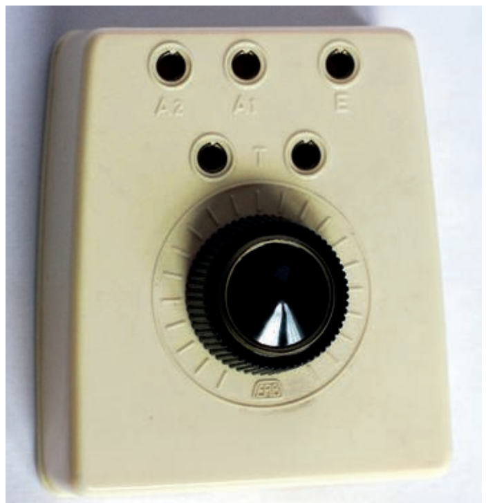
Bild 2: EAB-Detektorempfänger „Delu“ von etwa 1957 im modernen elfenbeinfarbenen Kunststoffgehäuse mit innerer Germanium-Diode.
