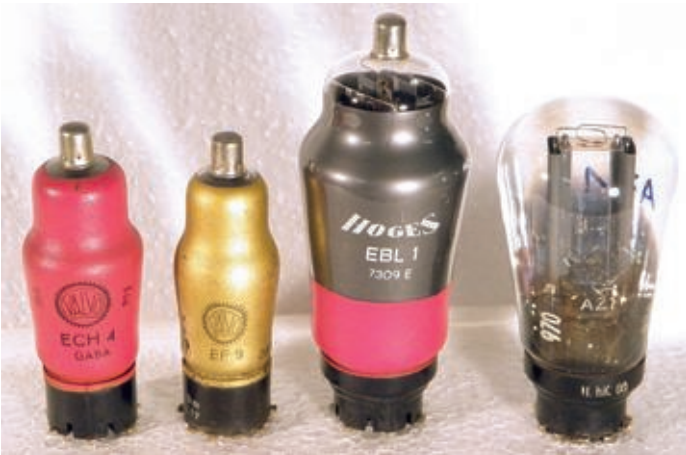
Bild 2: Die im Sender und im Empfänger verwendeten Röhrentypen. Oben von links nach rechts EF14, EF6, LS50, EM4, GR150DA, darunter ECH4, EF9, EBL1, AZ1.
