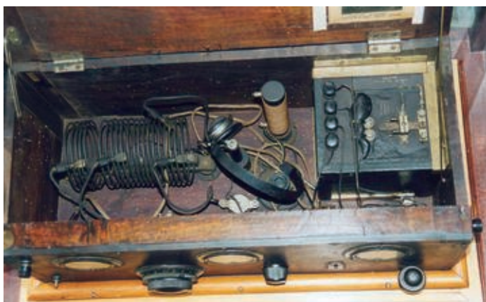
Bild 16. Sender „Ondina campale S“; 30 - 50 m / 5 W HF; 12 kg (Biagi: N° 3 von 6-er Serie). Hersteller: I1MT, Arsenale della Regia Marina Militare di La Spezia, heute im dortigen Marine-Museum. (Ein sehr ähnlicher befindet sich im Museum Caprone, Flughafen Merano I).
