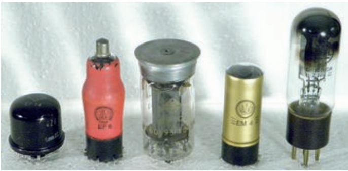
Bild 2: Die im Sender und im Empfänger verwendeten Röhrentypen. Oben von links nach rechts EF14, EF6, LS50, EM4, GR150DA, darunter ECH4, EF9, EBL1, AZ1.
