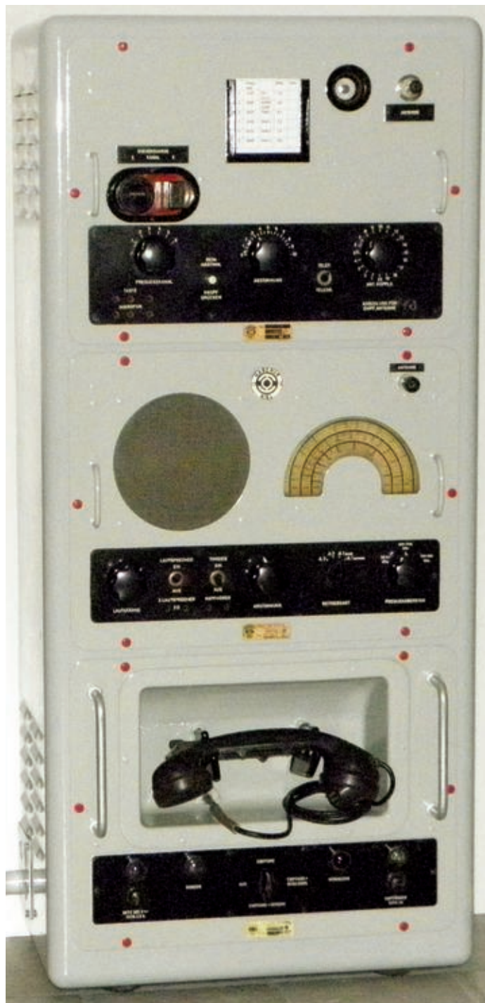
Bild 1: Ansicht der Funkstation. Oberer Einschub Sender, darunter Empfänger, unten Netzteil des Senders mit Halterung für den Handapparat.
