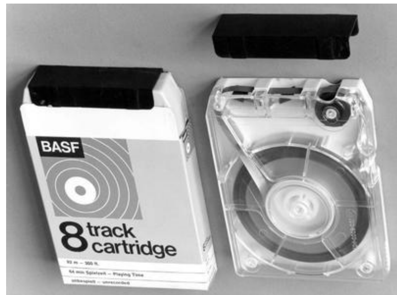
Die Lear-Jet-Cartridge (8-track-Cartridge), hier als Demonstrationsobjekt mit durchsichtiger oberer Gehäuseschale aus BASF-Fertigung. Deutlich sichtbar ist die im Cartridge-Gehäuse gelagerte Andruckrolle.
