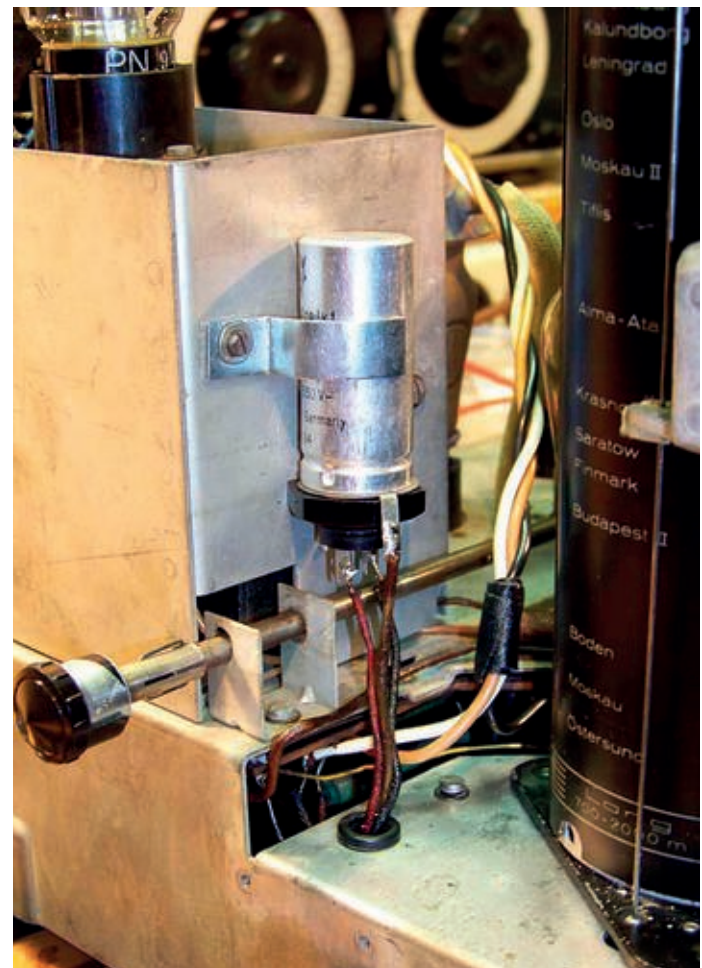
Bild 17. Der neue Netzteil-Elko ist so montiert, dass er jederzeit gegen ein Exemplar in Originalgröße ausgetauscht werden kann.
