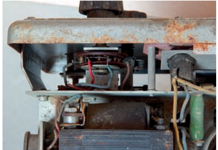
Der Klassiker: verschmutzter Stufenschalter.
