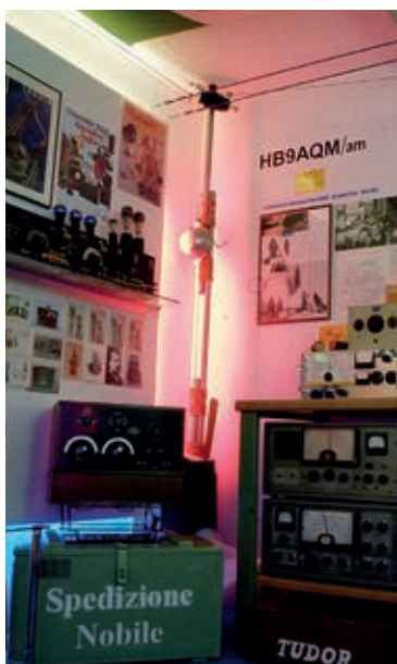
Bild 15. Hinten der nachgebaute Antennenmast und der Notempfänger.
