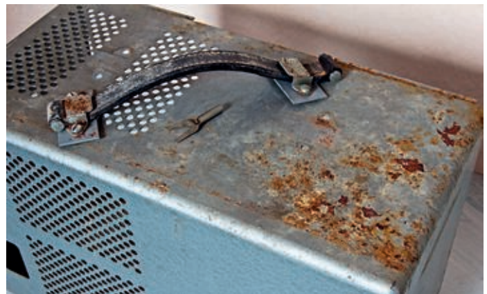
Hier hilft nur Sandstrahlen, Grundieren und Lackieren.
