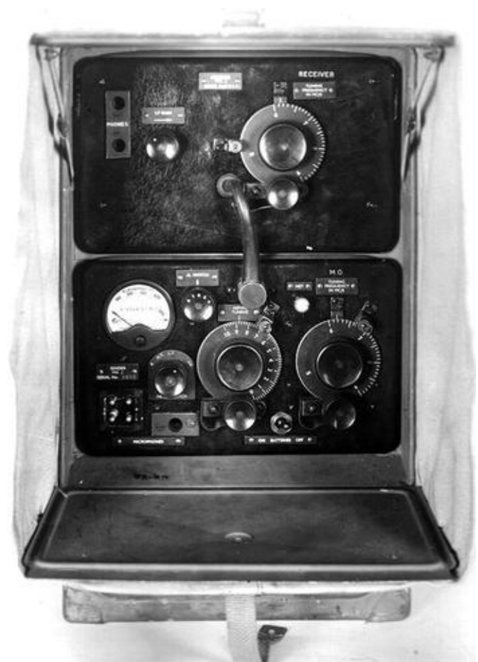
Bild 10: Vielleicht wurde auch bereits der 1940 für die Führungsebenen Bataillon und Kompanie entwickelte „Man-Pack“-Sendeempfänger No. 18 verwendet (6-9 MHz, Sendeleistung 0,25 W, Tast- und Sprechfunk). Derartige Funkverbindungen konnten offenbar von Frankreich aus nicht erfasst werden, auch wäre hierzu ein Fu.H.E. c (3,75-25,8 MHz) erforderlich gewesen.
