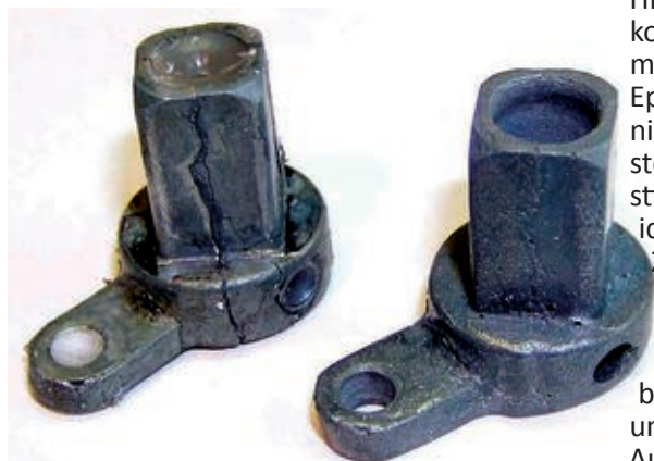
Bild 21. Modell und Nachguss (rechts) des Schaltknebels.
