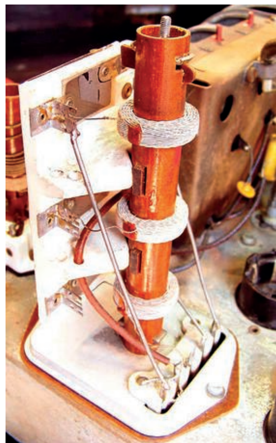
Bild 33. Die erste ZF-Stufe hinter der Mischröhre AH1.
