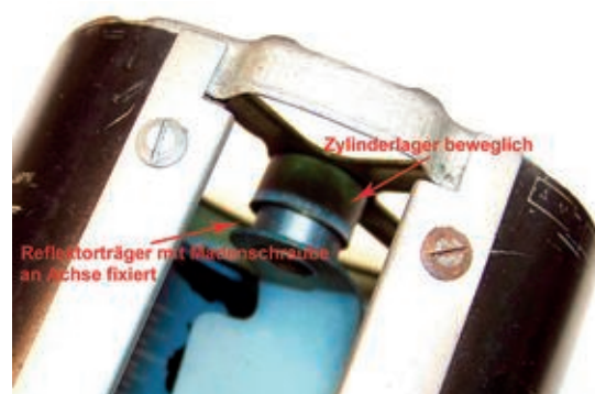
Bild 28. Oberer Teil der Skalenmechanik.
