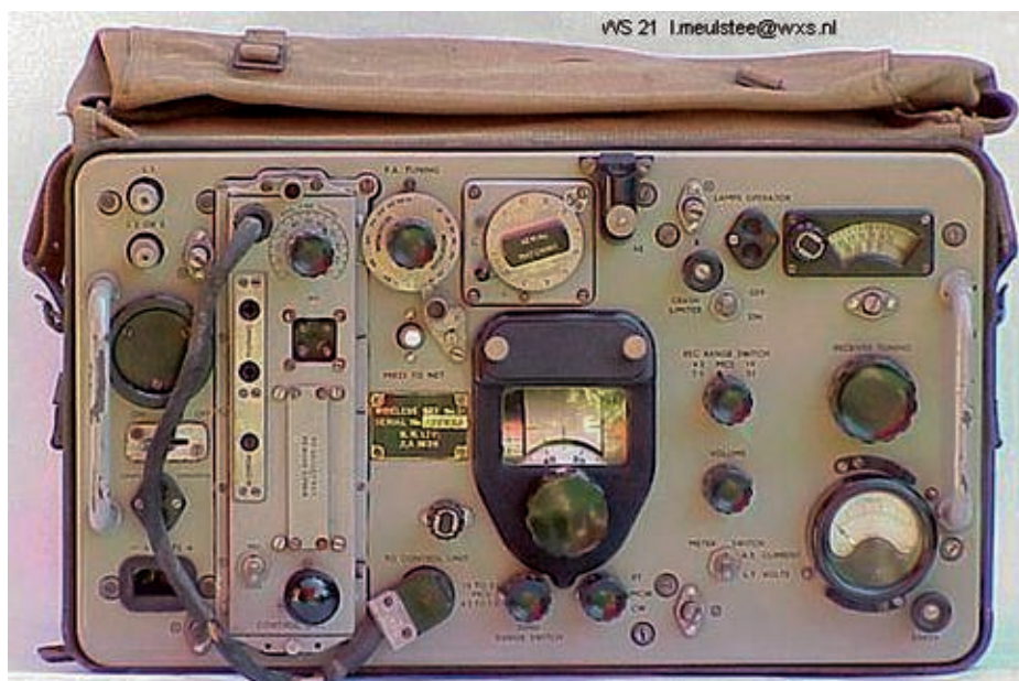
Bild 12 (unten). 1940 wurde als Nachfolger für No. 11 dieses Funkgerät geringer Leistung, No. 21, vorzugsweise für die Ebenen Brigade und Regiment entwickelt (4,2...7,5 MHz, 1,5 W). Das Gerät konnte zugleich im Bereich 19...31 MHz betrieben werden, war also das erste HF/VHF-Sprech- und -Tastfunkgerät. Allerdings soll der VHF-Bereich in der Praxis kaum verwendet worden sein.
