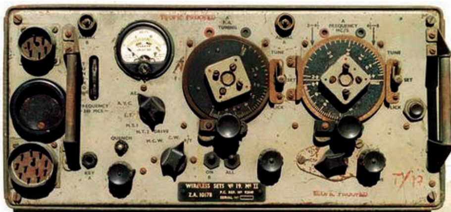
Bild 11 (oben). Vermutlich war das spätere Standard-HF-Funkgerät der Royal Army No. 19 (2...8 MHz, 2,5 - 9 W) noch nicht verfügbar, denn es befand sich 1941 noch in der Entwicklung.
