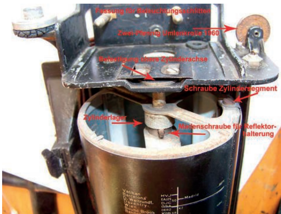
Bild 27. Blick auf die Skalenmechanik von oben.
