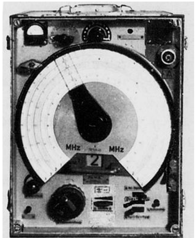
Bild 2. Standard-Horchempfänger der deutschen Nachrichtenaufklärung im 2. Weltkrieg waren der FuHE a (75-875 kHz) und der FuHE b (875-3.750 kHz). Die gegen England aufklärenden Einheiten dürften überwiegend mit diesen Geräten ausgestattet gewesen sein.
