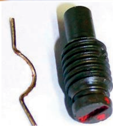
Bild 36. Der Abgleichkern hat ein Gewinde, das nur wenige Umdrehungen umfasst, das Gewinde fasst in einem U-förmigen Draht.
