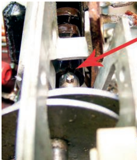
Bild 22. Schäden am Wellenschalter: a: (links) Hier war die Nut für den Mitnehmer ausgebrochen (roter Pfeil), b: (rechts) Der hintere Teil besteht aus Keramik mit Endstücken aus Metall.
