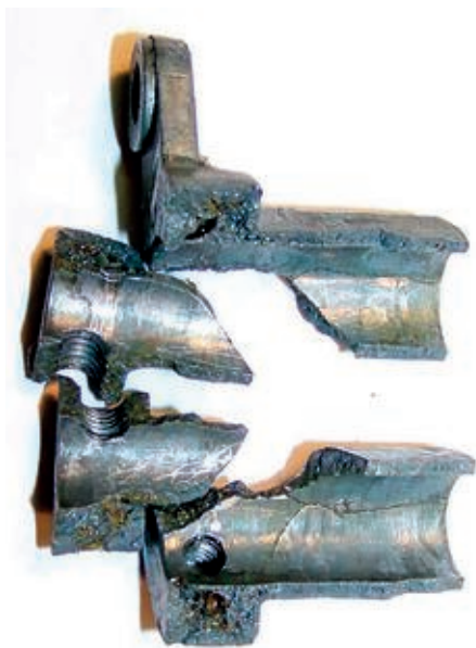
Bild 20. Der zerfallene Schalthebel aus Zinkdruckguss.
