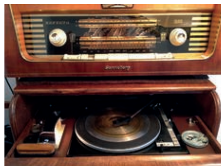
Abspielereinrichtung: Ein modifizierter Plattenspieler für 78 UpM und ein RFT-Radio „Erfurt 4“ – der als Allstromempfänger in einer solchen Situation nur über einen Trenntrafo betrieben werden sollte!
