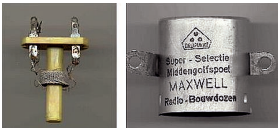
Bild 6. Nachbau der 402, der für den „Pupil“-Empfänger von Maxwell von der deutschen Firma Dreipunkt/Hütter gefertigt wurde.
