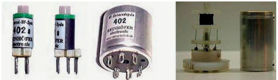
Bild 8. Nachbauten der 402-Spulen: links und Mitte die von Reinhöfer, die noch heute hergestellt werden, und rechts eine selbstgebaute von Jan Rompelberg.
