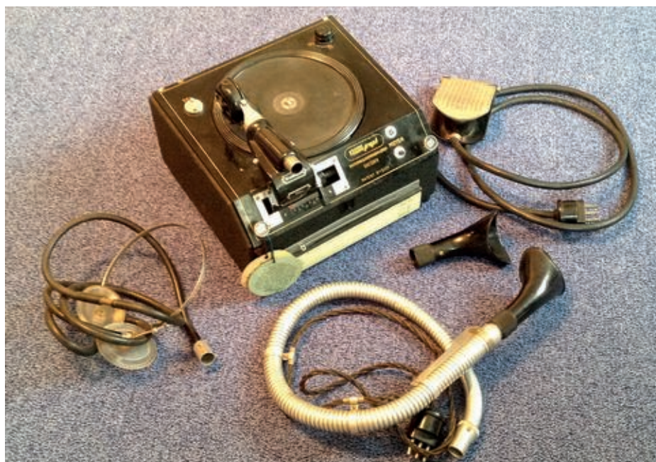
Der „Kosmograph“: Links ein „Luftkopfhörer“ für die Sekretärin. Ebenfalls für diese liegt rechts ein Fußschalter. In der Mitte vorne das Sprechrohr mit Schalter für den Motor. Bilder: Eberhard Schlegel
