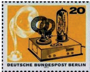
Bild 5: Batterie-Empfänger OE333 mit Dreifachröhre und Lautsprecher (Fa. Loewe, 1926).
