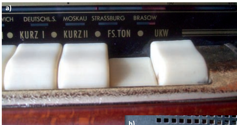
Bild 13. Radio-Modell mit integriertem TV-Ton „Giebichenstein“ von der DDR-Firma Sonata, Niemann & Co. (1956): a. Drucktaste für TV-Ton, b. Der Kanalwählerschalter auf der Geräterückseite, c. Trommelkanalwähler im Gerätechassis, d. Schaltung.
