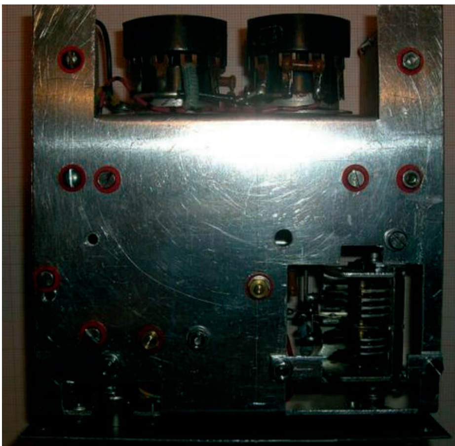
Bild 7. Ansicht von unten. Die Unterseite des Chassis ist fast leer.
