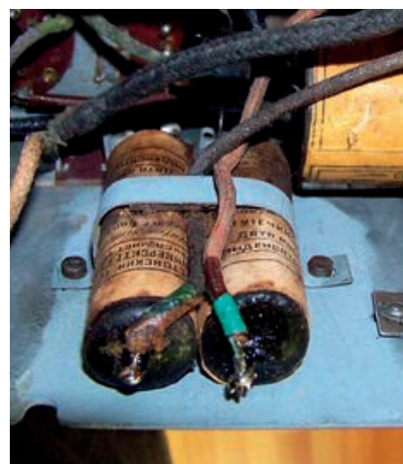
Bild 8. Repariert wurde der eine Elko mit originalgetreuem textilsoliertem Kabel, dessen Enden mit grüner Nähseide abgebunden wurde.
