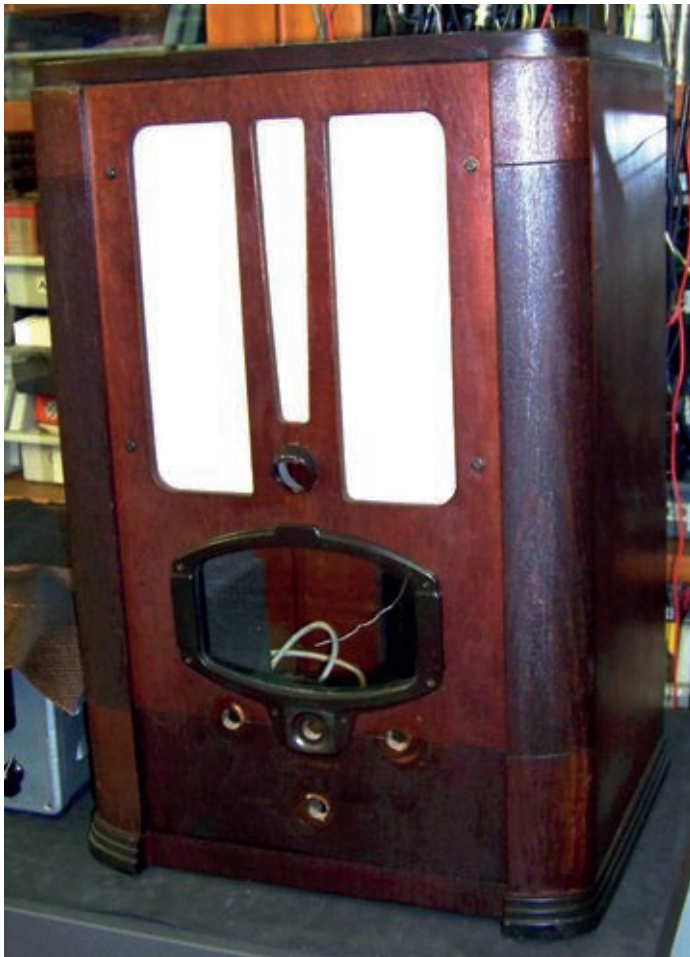
Bild 1. Das Gerät war außergewöhnlich gut erhalten, keine sichtbare Korrosion, und der Lack des Gehäuses war einwandfrei.
