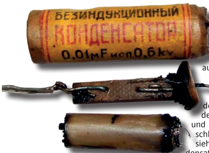
Bild 9. Der Kondensatorwickel ist um ein Pertinaxplättchen als Träger gewickelt.
