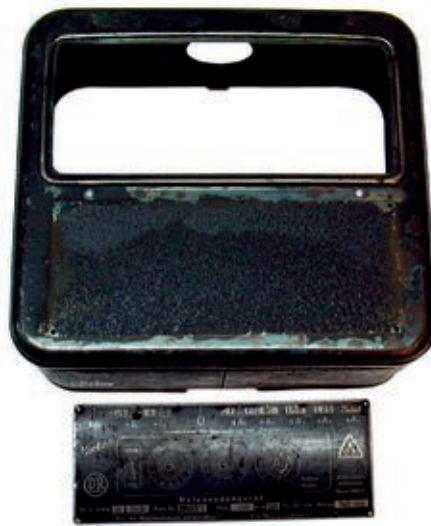
Das Gehäuse war stark verrostet.
