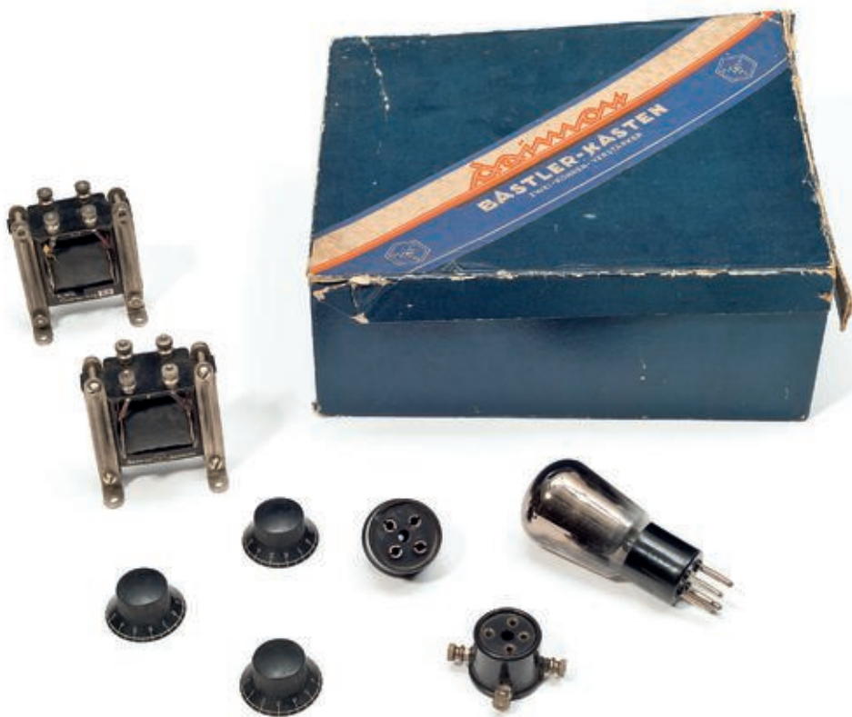
Bild 7. „Bastler-Kasten“ der Firma Daimon zum Aufbau eines NF-Verstärkers von 1926 sowie einige enthaltenen Einzelteile.
