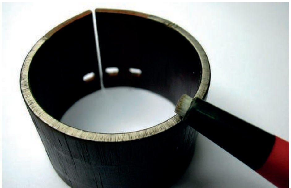
Da es sich beim Widerstandsdraht um lackisolierten Draht handelt, muss vor dem Zusammenbau des Rheostaten die Schleifbahn vom Lack befreit werden.
