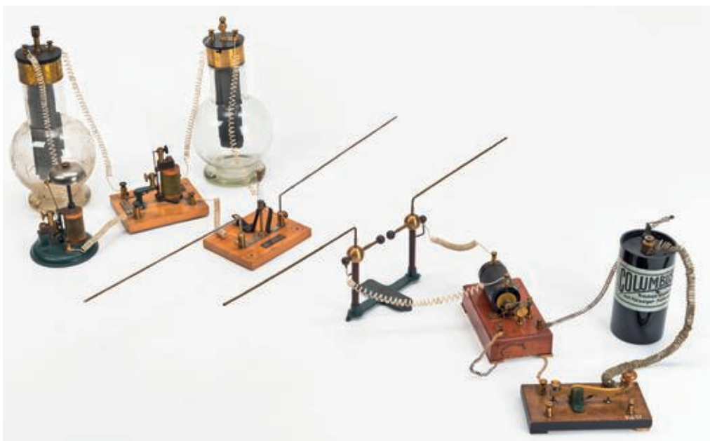
Bild 3. Versuchsanordnung zur drahtlosen Telegrafie von Meiser & Mertig, Dresden, und Bing, Nürnberg, etwa 1910.
