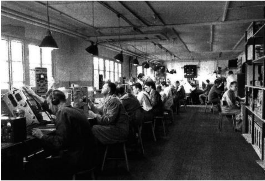
STEG-Instandsetzungsstelle für amerikanische Nachrichtengeräte in Mannheim-Friedrichsfeld. Hier ist gerade der Empfängertyp „E-348“ für die Polizei in Arbeit. Bild aus [1]
