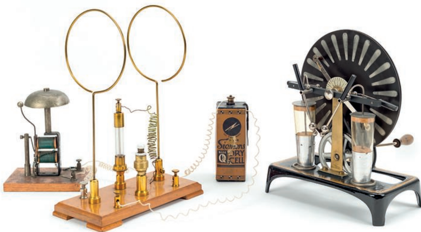
Bild 4. Versuchsaufbau von Dr. C. Richard Schulze, Leipzig, etwa 1911. Rechts die Influenzmaschine als Sender, links der Kohärer-Empfänger.
