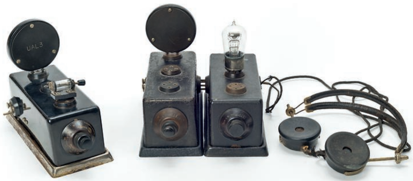
Bild 5. Radio-Experimentiersystem der Firma Kramolin, München, etwa 1924. Links Detektor, rechts Einröhrenempfänger und Kopfhörer.
