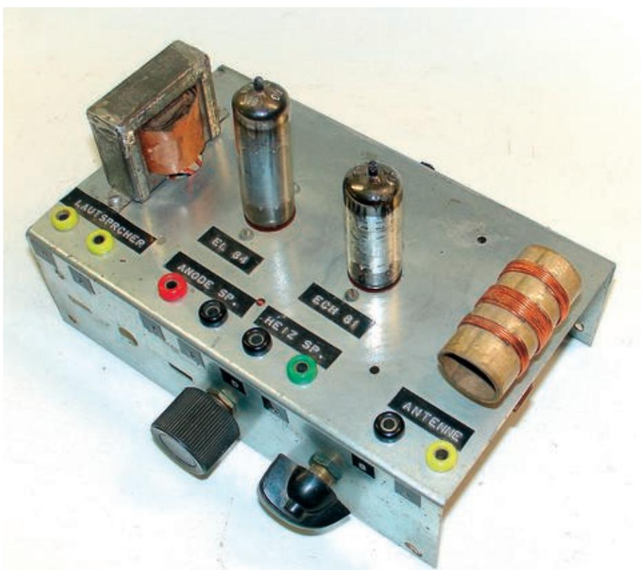
Bild 8: Das Kurzwellenaudio. Aufbau und Schaltung.
