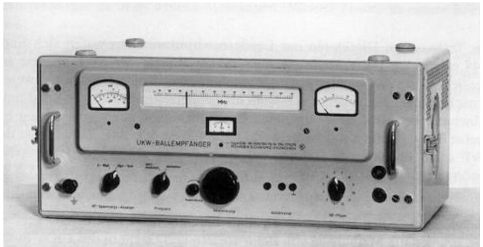
Bild 8 : Rohde & Schwarz ESB, kommerzieller Ballempfänger, wie er wahrscheinlich in Würzburg anfangs genutzt wurde. 1951/52, 16 Röhren, U. Bild aus R. Schneider, Die UKW Story [1].
