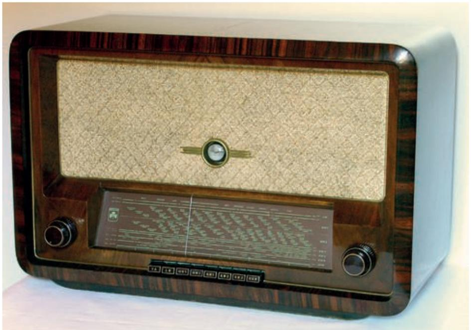
Bild 5: Grundig „495W“, 1950/51, 9 Röhren, 8/10 Kreise, L2M3KU, 519,60 DM (incl. ECF12)
