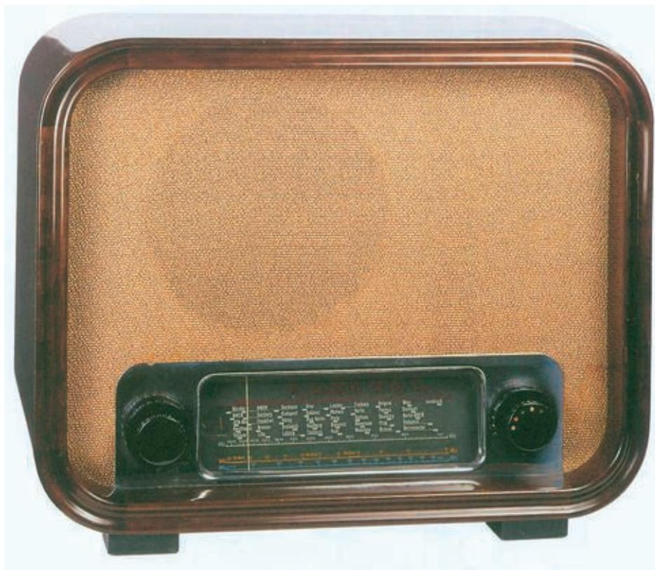
Bild 3: Rohde & Schwarz-Empfänger „ESF“ BN15061, 1950/51, 7 Röhren, 6/8 Kreise, LM2KU, 485 DM. Eigenes Gerät. Bild aus DRM-Archivsammlung.
