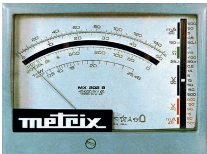
Multimeter Metrix MX 202B (Bild von der Bedienungsanleitung).
