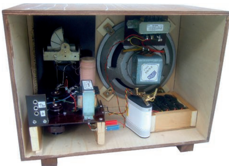
Blick ins Innere des „Neubaus“. Die Spule ist selbst gewickelt auf einer 30-mm-Papprolle.
