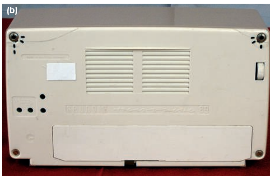
Grundig „Transonette 89“ (a). Bei diesen Geräten muss man nicht schrauben, um die Batterien auszutauschen, sondern einfach die Schublade auf der Rückseite (b) herausziehen.
