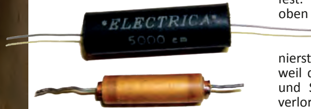
Bild 8. Die Kondensatoren lassen sich leicht aus der Hülle entfernen und gegen neue austauschen.
