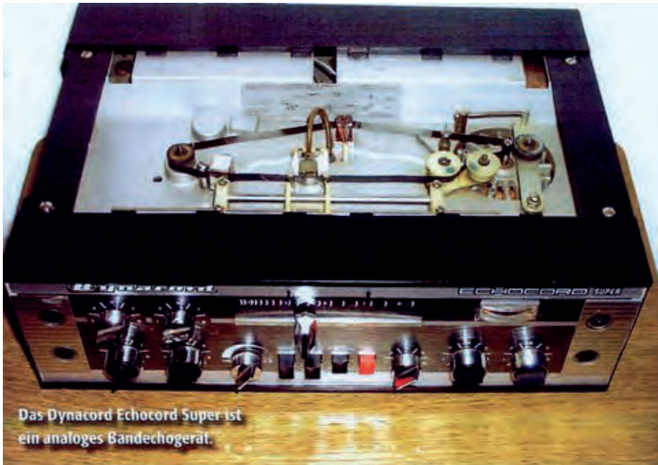
Bild 4. Das Bändergerät „Echocord Super“ von Dynacord hat einen von außen verschiebbaren Hörkopf zur Einstellung der Verzögerung des NF-Signals. Bild aus Recording 2010, Heft 6 „Das doppelte Stimmchen“
