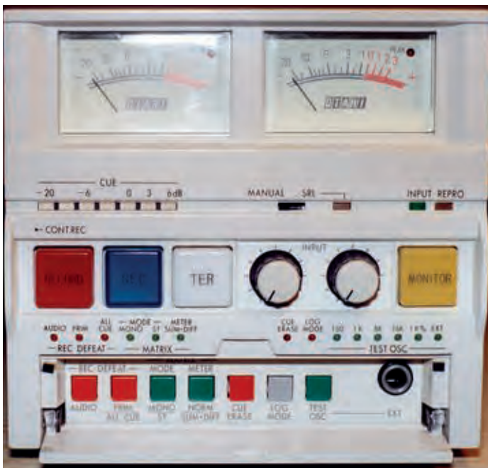
Bild 8. Das Recorder-Modul „CTM-10R“ von Otari. Die Stereosignale werden über zwei XLR-Buchsen eingespeist und können auf der Frontplatte eingepegelt werden. Wie zu erkennen ist, sind zahlreiche LED-Anzeigen vorhanden, die alle möglichen Optionen oder Tests anzeigen. Zahlreiche Tasten unter einer Klappe machen die Bedienung nicht gerade leicht.
