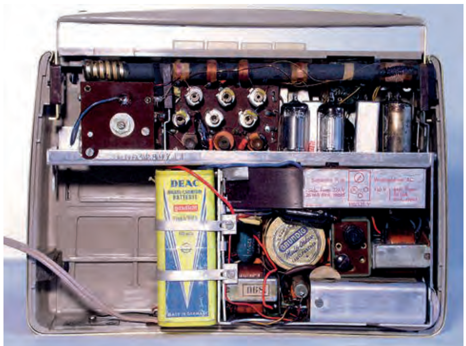
Bild 7. Grundig „Transistor-Boy L“, Innenansicht. Rechts unten der transistorisierte DC/DC-Wandler im abgeschirmten Gehäuse.
