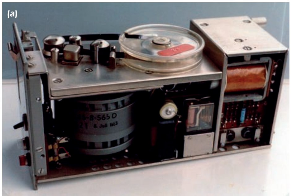
Bild 6. Das Kennmodulationsgerät „R 52“: (a) Zu erkennen sind der starke Andruckrollen-Magnet, Kammrelais und Verstärkerplatine sowie ein eigenes Netzteil. Links neben der Endlosspule die Lichtschranke, dann der mit Mu-Metall abgeschirmte Tonkopf auf einer Taumelplatte. (b) Die Schaltung des „R 52“.
