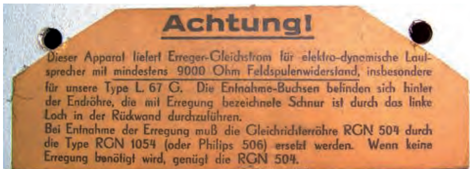
Bild 15. Hinweisschild zum Anschluss des Lautsprechers auf der Rückwand.
