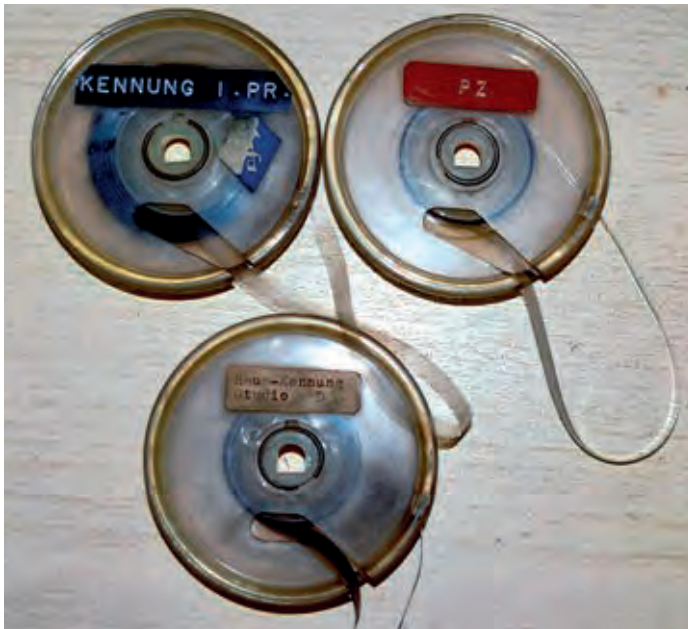
Bild 7. Drei Exemplare von einfachen Endlosspulen für die Aufnahme-/Wiedergabe-Geräte vom Typ „R 51“ / „R 52“. Links oben die mit „KENNUNG I. PR.“ enthalt den Text: „Sender Freies Berlin – Deutsches Fernsehen – 1. Programm“, rechts „PZ“ ist ein Pausezeichen, unten „Raumkennung – Studio D“ enthält die Ansage „Sender Freies Berlin – Studio D“, es sind jeweils weibliche Stimmen zu hören.
