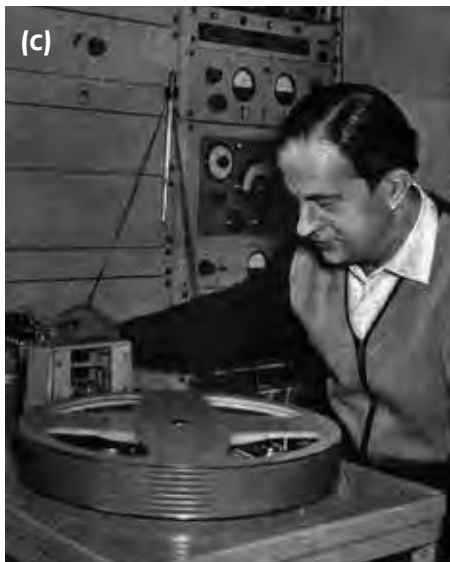
(c) Pausenzeichengerät des RTI. Das Magnettonband ist spiralförmig auf einen Zylinder aufgewickelt. Der Hörkopf gleitet in einem fahrluhartigen Schlitten während der Umdrehungen des Tellers mit dem Magnettonband auf und ab (Aufn. dpa)
