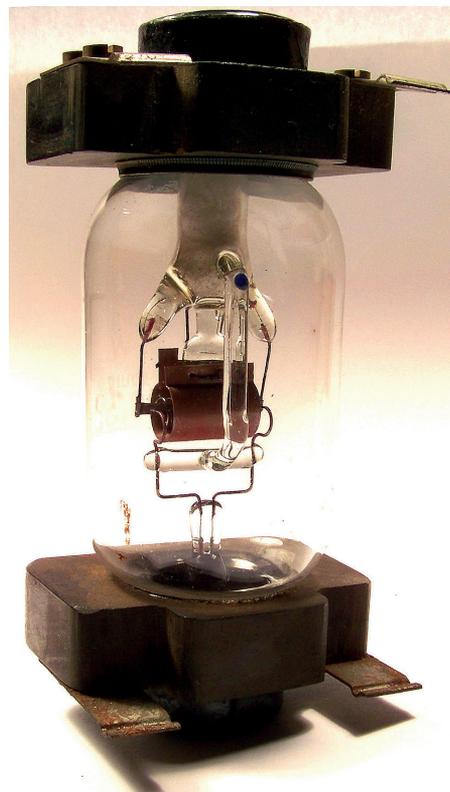
Bild 15. Röhre mit koaxialem System mit verbesserter Verstärkung vermutlich zum Ersatz von Siemens-/AEG-A-Röhren.
