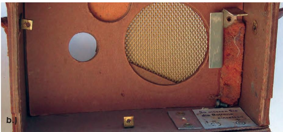
passenden Unterlegscheiben für den Schwaiger-Drehko und den Lautsprecher). Der Stabilisierungswinkel passte deshalb nicht und musste entfallen, sein Befestigungsblech im Gehäuse wurde nicht bestückt. Es wurde die alte „Winkelbefestigungsmethode“ wieder genutzt.
