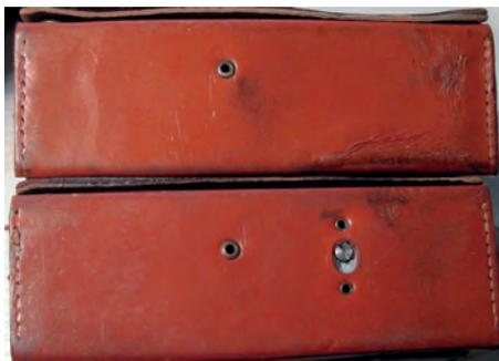
Bild 5. Ansicht des Gehäusebodens: frühe Version (oben), spätere Version mit Alu-Befestigungswinkel (unten). Die Platine wurde ursprünglich an zwei genieteten kleinen Winkeln im Gehäuse festgeschraubt. Am unteren Winkel wurde später nicht mehr geschraubt, die Platine lag hier nur noch auf. Der neue Platinen-Befestigungswinkel wurde mit seinem Fuß an dem durch zwei Nieten im Gehäuse befestigten Blech verschraubt.
