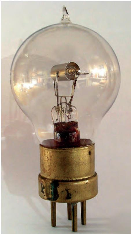
Bild 2. TM-Röhre der Firma Metal, Frankreich. (eigenes Foto)
