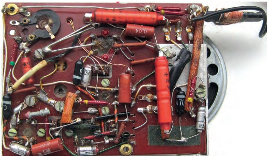
Bild 8. Übergangsgerät: Wie „Peggie S“, aber mit alter Platine noch ohne angepasste Bohrung für das aufragende Rotorlager des Schwaiger-Drehkos. Hier wurde, um genügend Freiraum zu schaffen, die Platine etwas höher gelegt.
