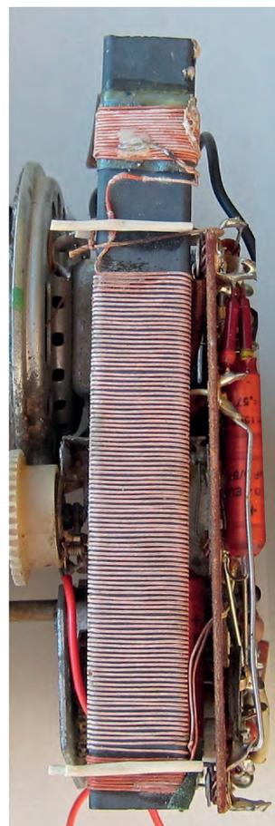
Bild 6. Spätere Variante der „Peggie A“: die Ferritantenne wurde nun anders bewickelt. Mit der Teilwicklung rechts konnte man bei montierter „Peggie“ auch die Startfrequenz des MW-Bandes bequem auf maximale Empfindlichkeit abgleichen.
