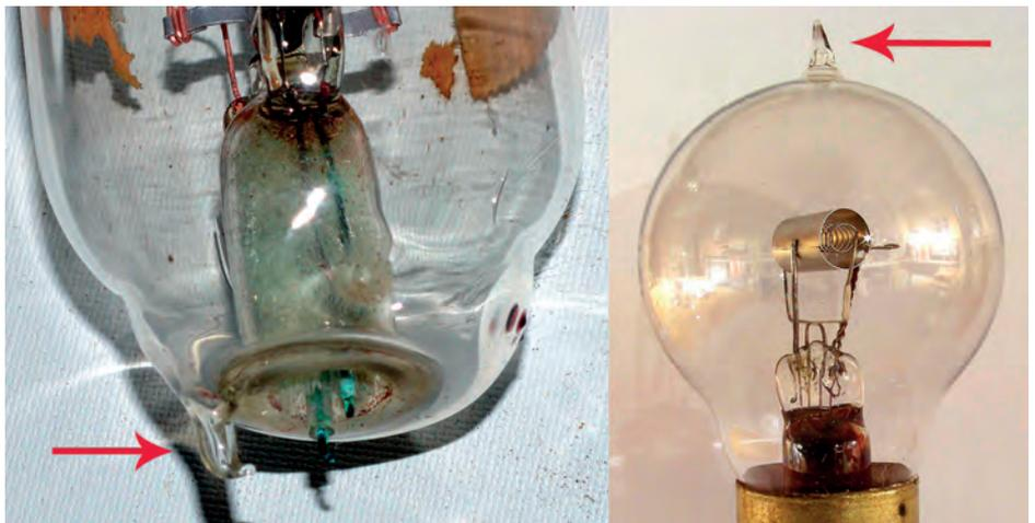
Bild 4. Ungesockelte Seddig-Röhre mit Pumpstutzen in der Einschmelznaht im Vergleich zu Französischer TM nach Glühlampenbauart.
