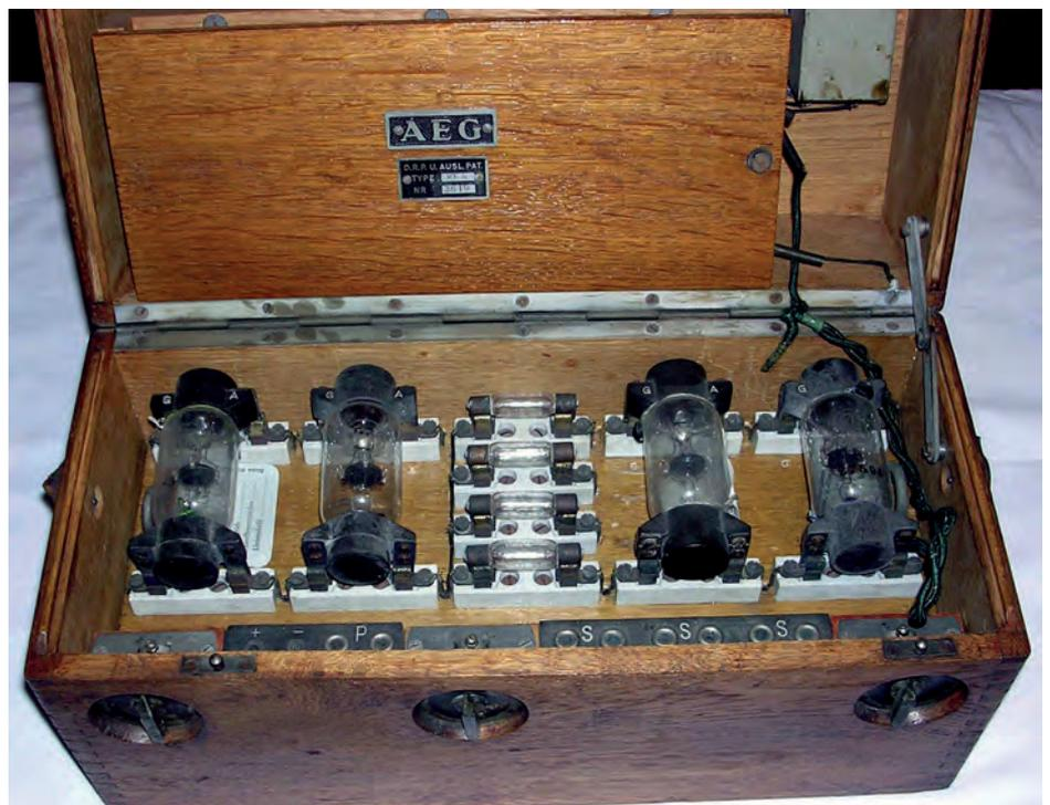
Bild 10. Vierstufiger AEG-Verstärker KF4 auch im Inventarverzeichnis der R.I.W. aufgeführt. (eigenes Foto)
