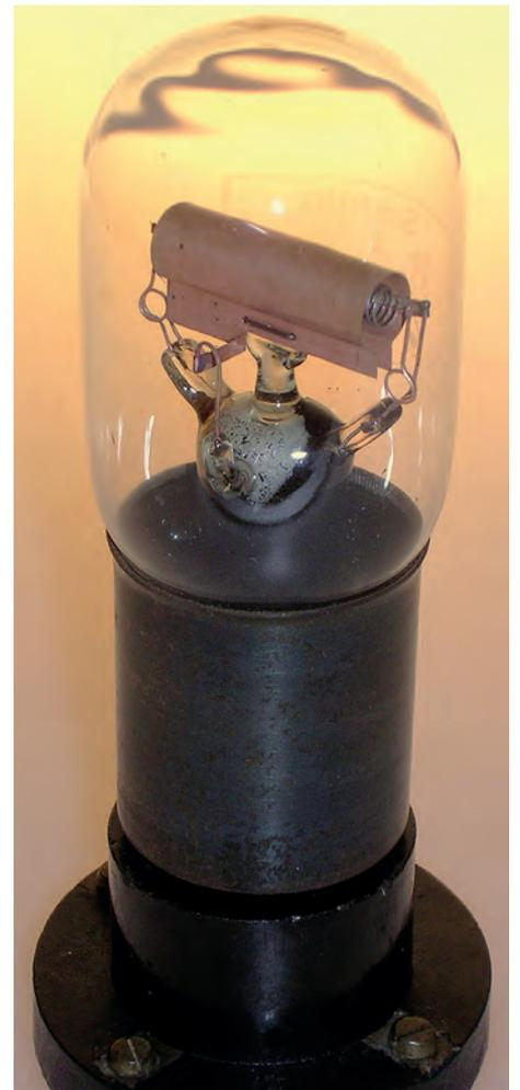
Bild 16. Seddig-Röhre. Vermutlich Versuchsexemplar zu Erhöhung der Emission mit verlängerter Anode und zwei Heizfäden.
