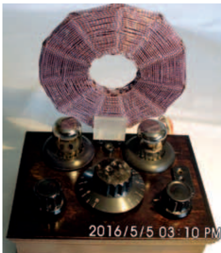
Das 12-Volt-Radio mit zwei Röhren 12Ж1Л.
