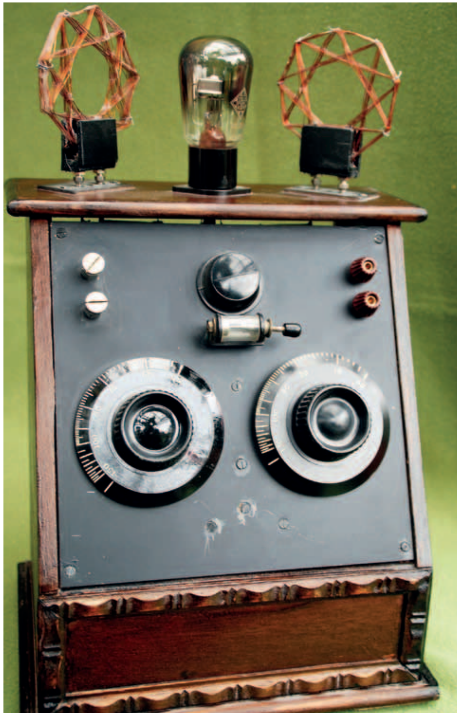
Bild 2c. Moderner Nachbau des Krüger-Reflexempfängers von GFGF-Mitglied R. Winkelmann (Sammlung P. v. Bechen).
