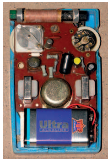
Bild 14b. Das miniaturisierte Innenleben des Zwei-Transistor-Reflexempfängers.
