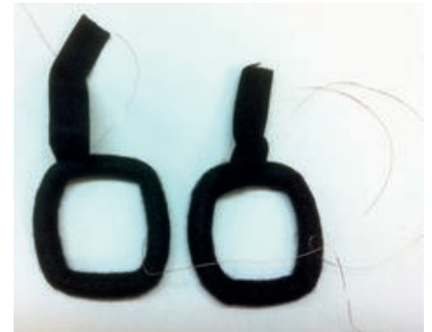
Bild 9. Die Wicklungen sind fertig zum Einbau.
