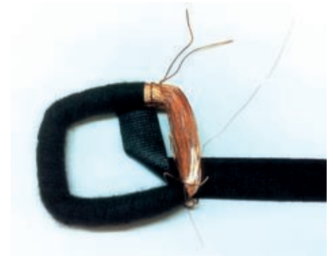
Bild 8. Die Wicklungen werden mit Baumwollgewebeband umwickelt.
