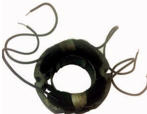
Bild 10. Der Stator ist wieder zusammengebaut.
