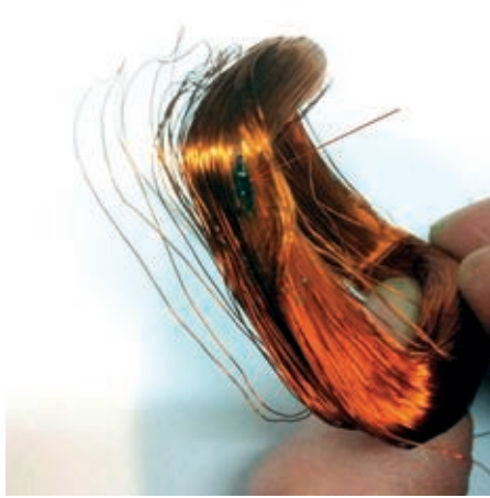
Bild 4. Jetzt wurde die Stelle sichtbar, an der die Wicklung defekt ist.
