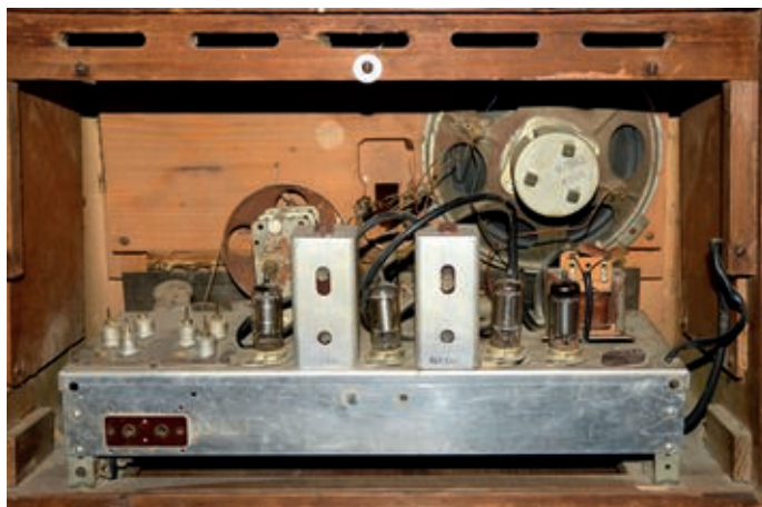
Bild 4. Das Minerva-Gerät von hinten: Kein Netztrafo, aber Batterieröhren.
