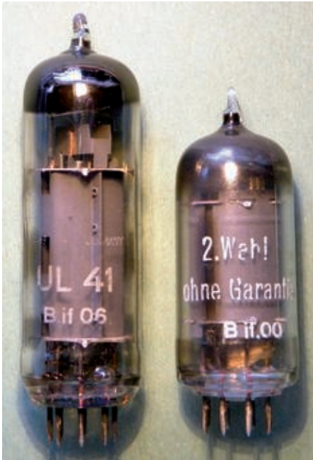
Bild 8. Zwei der im eigenen Gerät vorgefundenen Röhren (UL41 und UF41).
