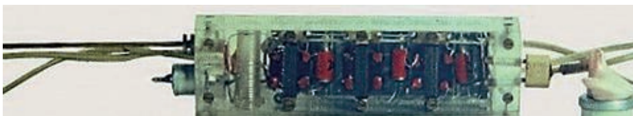
Bild 17. Bühnenmonitor-Empfänger im Plexiglasgehäuse (Mataré-Archiv/R. Herzog).
