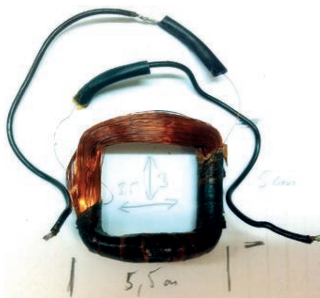
Bild 3. Wicklung, nachdem das Gewebband abgewickelt wurde.
