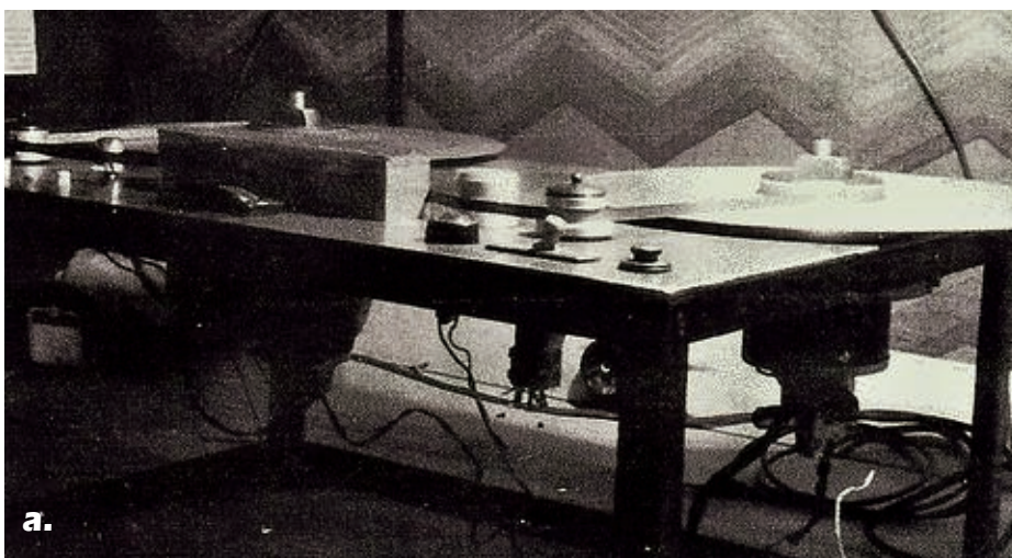
Bild 3. Fortschritte beim Bau des Laufwerks, noch ohne die Pabst-Motoren und mit unlackierter Eisenplatte. Für die AEG-Bobbies (anfangs mit 70 mm Durchmesser) mussten ferdergestützte Verriegelungen angefertigt werden (Siemens-Lehrwerkstatt). Die Tellerantriebe waren Staubsaugermotoren. Das Vierfach-Drucktastenaggregat stammte aus einem amerikanischen Batterieempfänger. a. Seitenansicht, b. Frontansicht.
