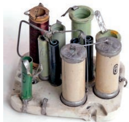
Bild 19. Kondensatoren zur Temperaturkompensation im FuG10-KW-Sender „S10K“ (Bild A. O. Bauer).
