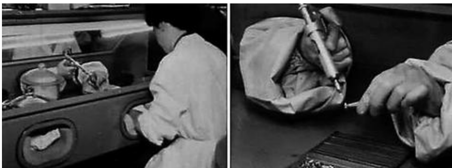
Bild 47. Manche Operationen wurden in einer Handschuhbox durchgeführt, um empfindliche Teile vor der Atmosphäre zu schützen.
