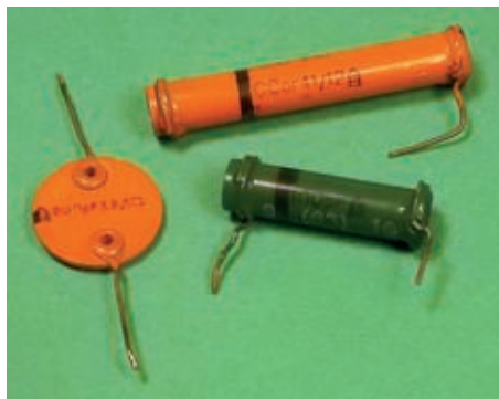
Bild 9. HESCHO-Rundfunkkondensatoren, links ältere Ausführung mit genieteten Anschlüssen (Bild H. P. Bölke).
