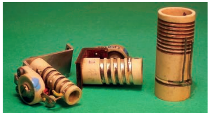
Bild 6. Keramikspulen mit aufgebrannten Windungen (Bild H. P. Bölke).
