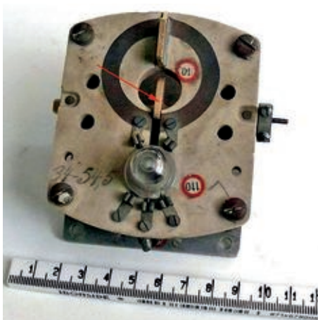
Bild 24. Empfängeroszillator eines „Seetakt“-Radargerätes mit „dielektrischem Drehkondensator“ (Bild A. O. Bauer).
