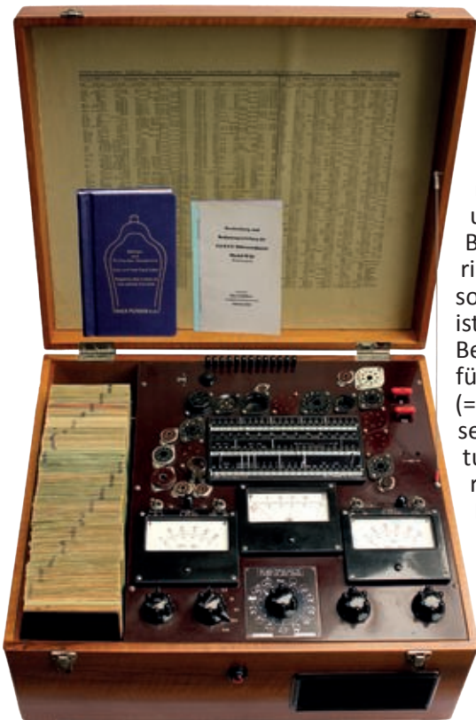
Bild 2. Gerät mit geöffnetem Deckel (SN 27858), mit Prüfkartensatz, Bedienungsanleitung, Prüfkartenverzeichnis (= sogenanntes „Blaues Buch“), Auszug aus dem Prüfkartenverzeichnis als Einkleber im Gerätedeckel.
