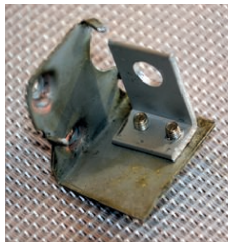
Bild 5. So wird der Befestigungswinkel für den neuen Miniatur-Kippschalter montiert. Anschließend wird der Schalterhalter wieder an den Tastensatz angeschraubt.
