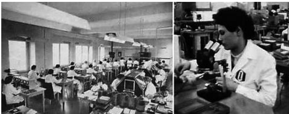
Bild 45. Empfindliche Operationen wie Lötvorgänge zu Transistorlegierungspunkten wurden mit Hilfe von binokularen Mikroskopen durchgeführt.
