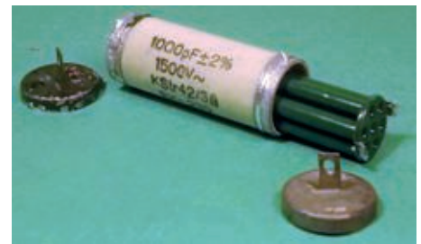
Bild 13. Tropenfester Kondensator geöffnet (Bild H. P. Bölke).
