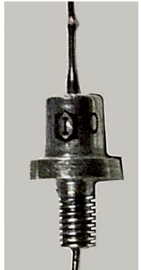
Bild 34. Eine Explosionsdarstellung einer kompletten Diode ist links gezeigt [37] und rechts eine Siliziumdiode OY6041 von Intermetall[38].
