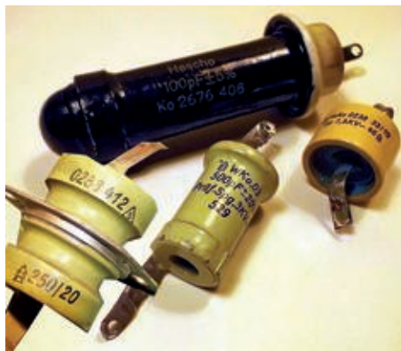
Bild 11. Kondensatoren für Sender (Bild H. P. Bölke).
