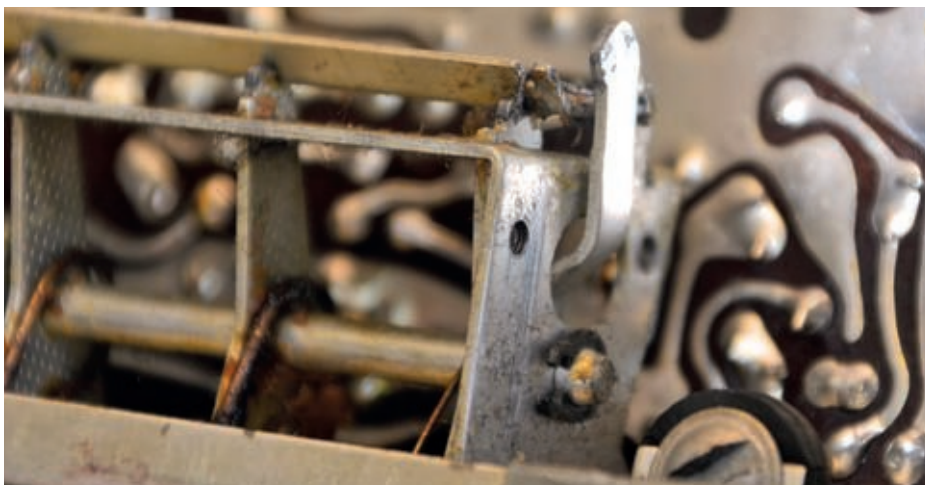
Bild 6. An den Betätigungshebel (verzinktes Eisenblech) lässt sich ein starker Kupferdraht löten, der den Schalthebel betätigt. Es ist darauf zu achten, dass die Lötstelle weder mit dem Tastensatz noch mit dem Schalterhalter kollidiert.
