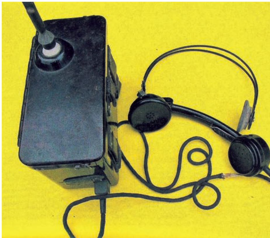
Bild 1. „Liliput“ (Rückseite) mit Handapparat.
