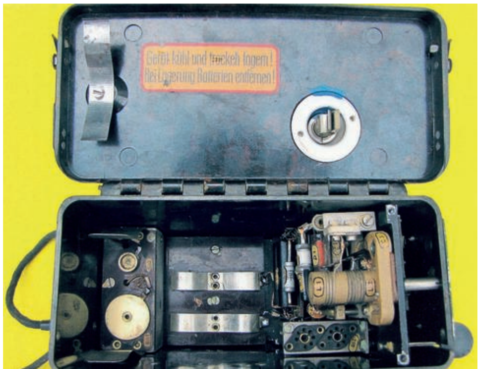
Bild 3. „Liliput“ geöffnet. Links: Fach für Heizbatterien, Mitte: Fach für zwei Anodenbatterien, rechts: Geräteeinschub (Röhren DL192 entfernt).
