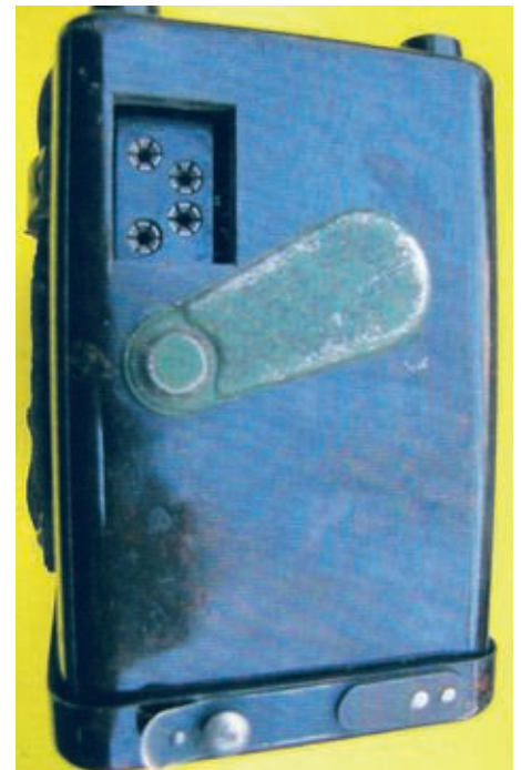
Bild 4. „Liliput“ von hinten. Hier sind die Anschlüsse für den Handapparat.
