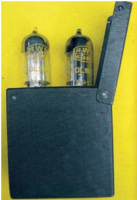
Bild 5. Holzkästchen mit zwei Ersatzröhren DL192.
