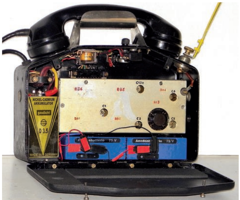
Bild 2. Ansicht bei geöffneter Gehäuseklappe. Im Gehäuse montiert sind Batterieschalter, Lautstärke-Potentiometer, Sende-Empfangs-Relais und eine 10polige Tuchel-Buchsenleiste. Heizakku und Anodenbatterien sind Nachbildungen.
