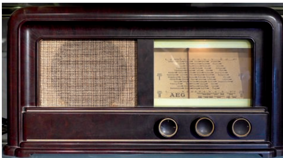
Bild 8. Röhrenradio AEG „29W“, ein Wechselstromgerät mit Netztransformator und Gleichrichterröhre AZ11.
