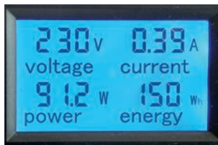
Bild 8. Anzeige beim Anschluss einer Glühlampe, die einen rein Ohm'schen Widerstand darstellt.
