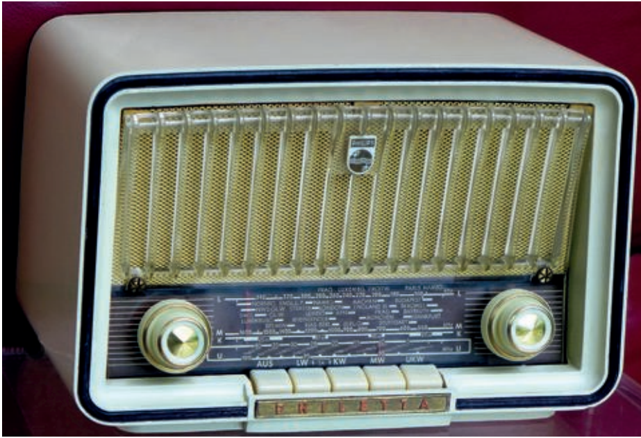
Bild 11. Philips „Philetta BD254U“. ein Allstromgerät mit Röhrengleichrichter.
