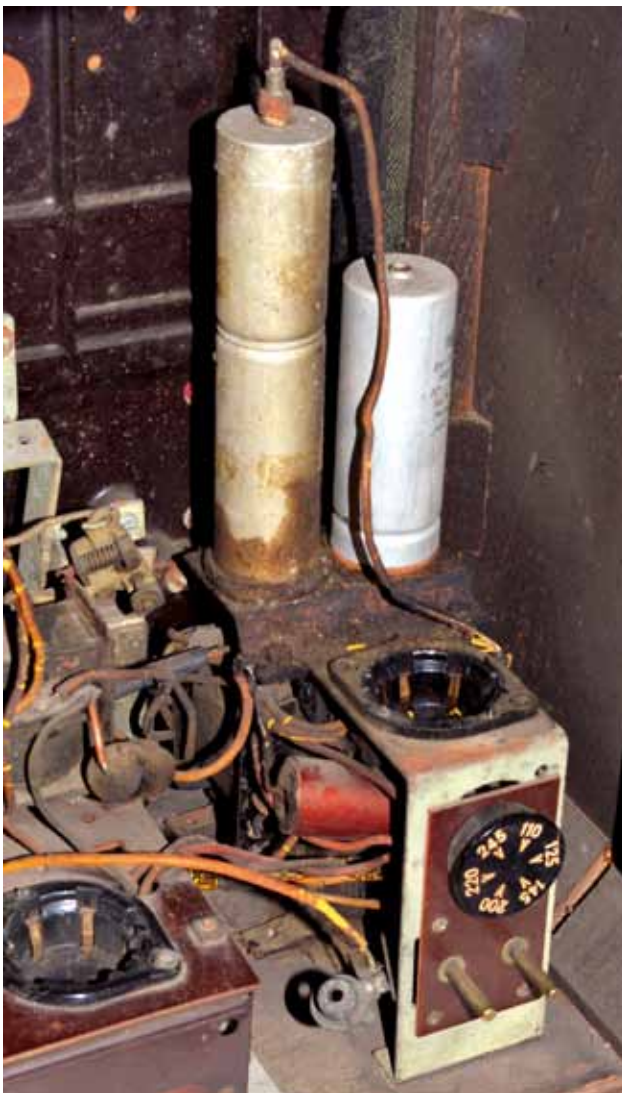
Bild 13. Das Netzteil. Der rechte Becher-Elektrolytkondensator war bei einer späteren Reparatur eingebaut worden.
