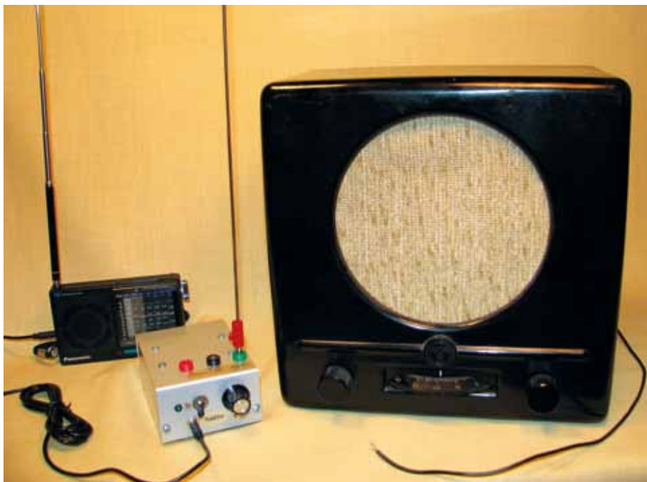
Bild 1. Der DKE38 empfängt das UKW-Programm. Alle Bilder außer Bild 2: H. P. Bölke
