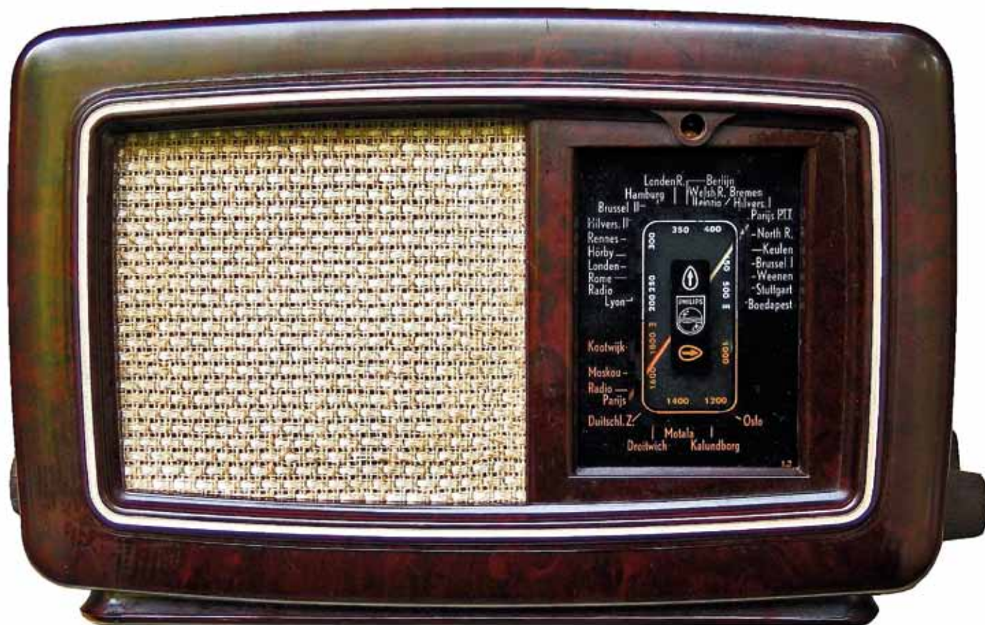
Bild 3. Zwergsuper Philips 203U, worauf ein Teil der Verlagerungsgeräte basiert. Nur das Gehäuse wurde ein wenig geändert, wie im zweiten Teil des Artikels beschrieben und gezeigt wird.
