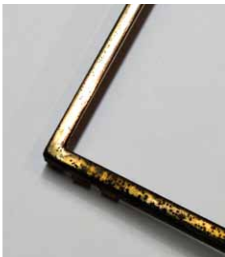
Bild 5. Der korrodierte Messingrahmen auf der Gerätefront.
