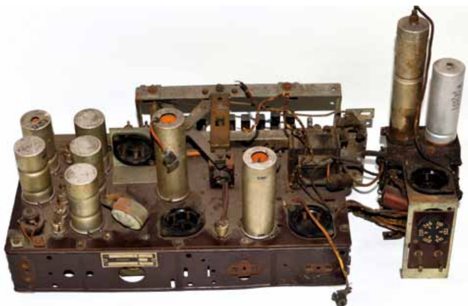
Bild 3. Netzteil und Empfänger-Chassis sind über einen Kabelbaum verbunden.
