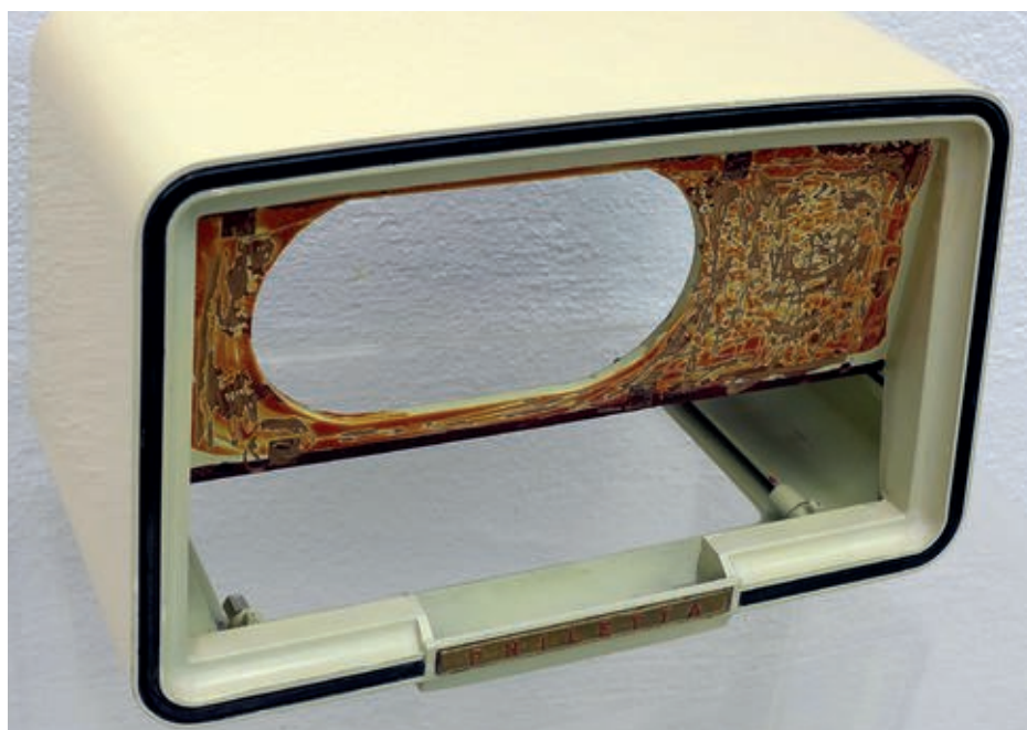
Bild 10. Oberseite und Seitenteile des Gehäuses wurden nach vorsichtigem Anschleifen mit Spraylack Deco-Color Ivory RAL1015 gespritzt.
