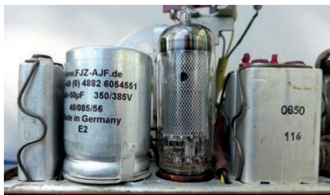
Bild 19. Der ausgetauschte Becher-Elko.
