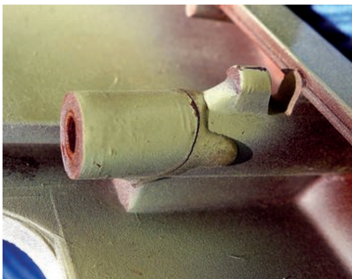
Bild 5. Die abgebrochene Bakelit-Aufnahme der Schraube zur Befestigung des Chassis links konnte mit 2K-Kleber wieder fixiert werden.
