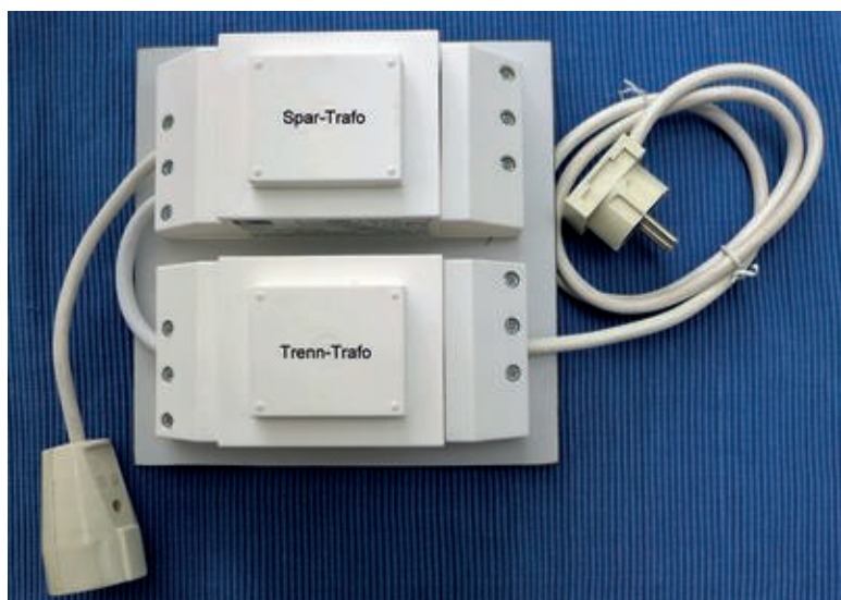
Bild 26. Das restaurierte Radio wird unter optimalen Bedingungen mit einer Kombination aus Trenn- und Spartrafo sicher vom Netz getrennt und mit 220 V Spannung betrieben.
