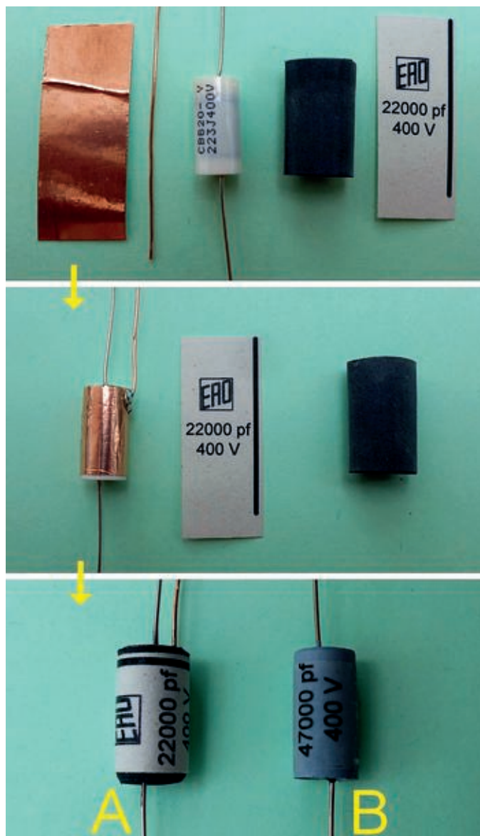
Bild 17. Die abgeschirmten Kondensatoren wurden nachgebaut.
