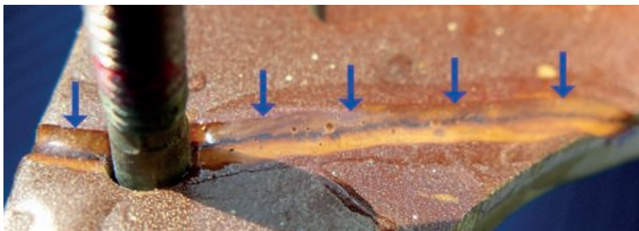
Bild 7. Der Riss an der Vierkantschraube der Lautsprecherbefestigung wurde halbkuelförmig ausgefräst und mit 2K-Kleber verfüllt.
