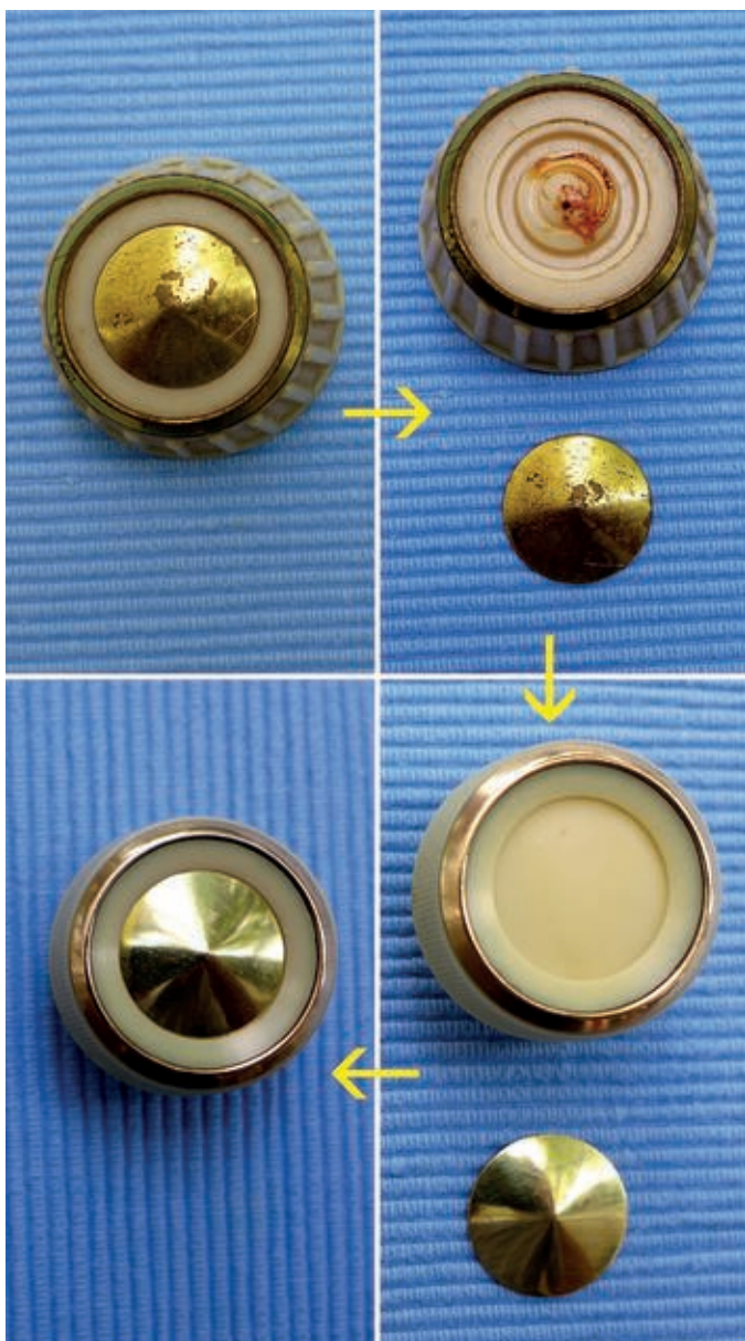
Bild 12. Die fehlenden Messingeinlagen der Philetta-Knöpfe wurden ersetzt.
