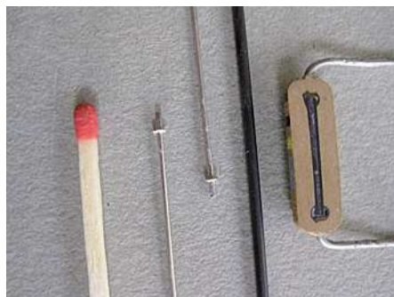
(b) die Einzelteile und ein mittig angeschliffener Widerstand.
