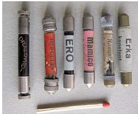
Bild 29. Beispiele für Widerstände verschiedener Hersteller zum Einklemmen in Widerstandshalter, 2. Hälfte der 1920er-Jahre (a), und Widerstandshalter mit Schraubanschlüssen (b).
