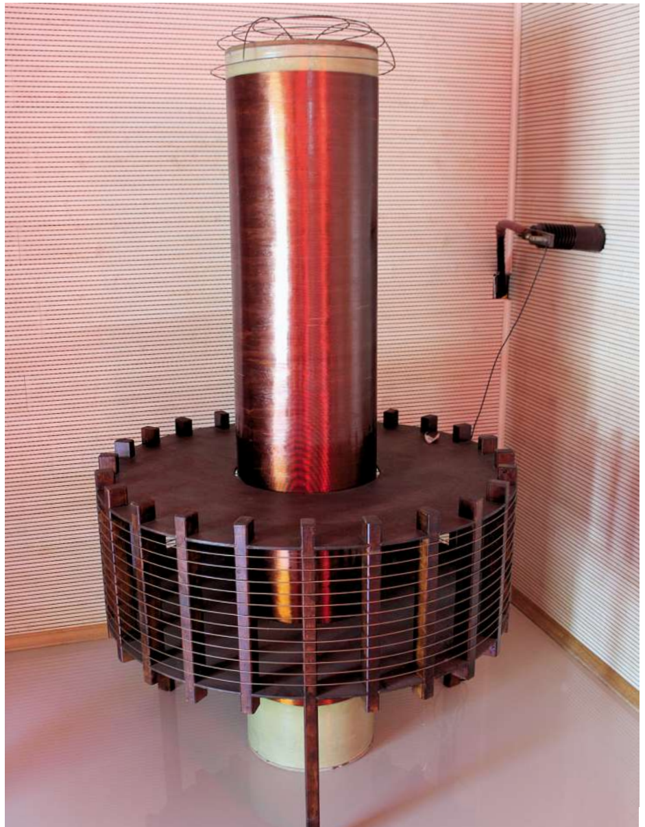
Bild 9. „Tesla-Transformator“ zur Hochspannungserzeugung. (Dieses Exemplar steht im Tesla-Gedenkzentrum in Smiljan/Kroatien.)
