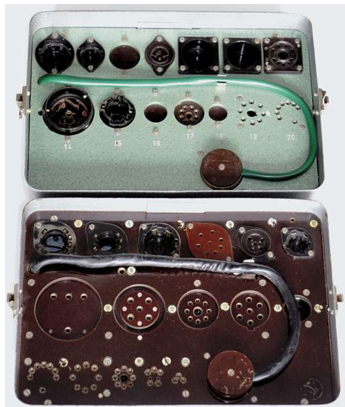
Bild 11. Optionale Deckel mit Zusatzfassungen: oben W18N, unten W26.
