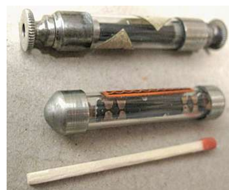
Bild 25. Weitere frühe Kohleschichtwiderstände. Oben Fabrikat Minkowid, 1MΩ, unten Fabrikat Mountford, 7 MΩ.
