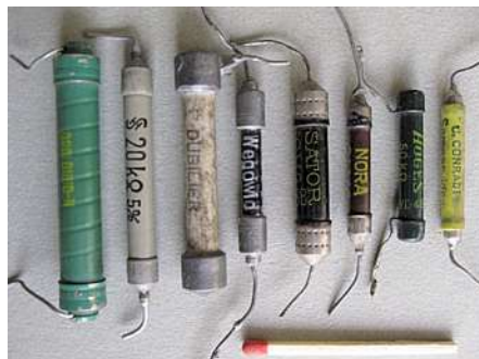
Bild 30. Verschiedene Widerstände mit Anschlussdrähten zum Einlöten ab ca. 1930.
