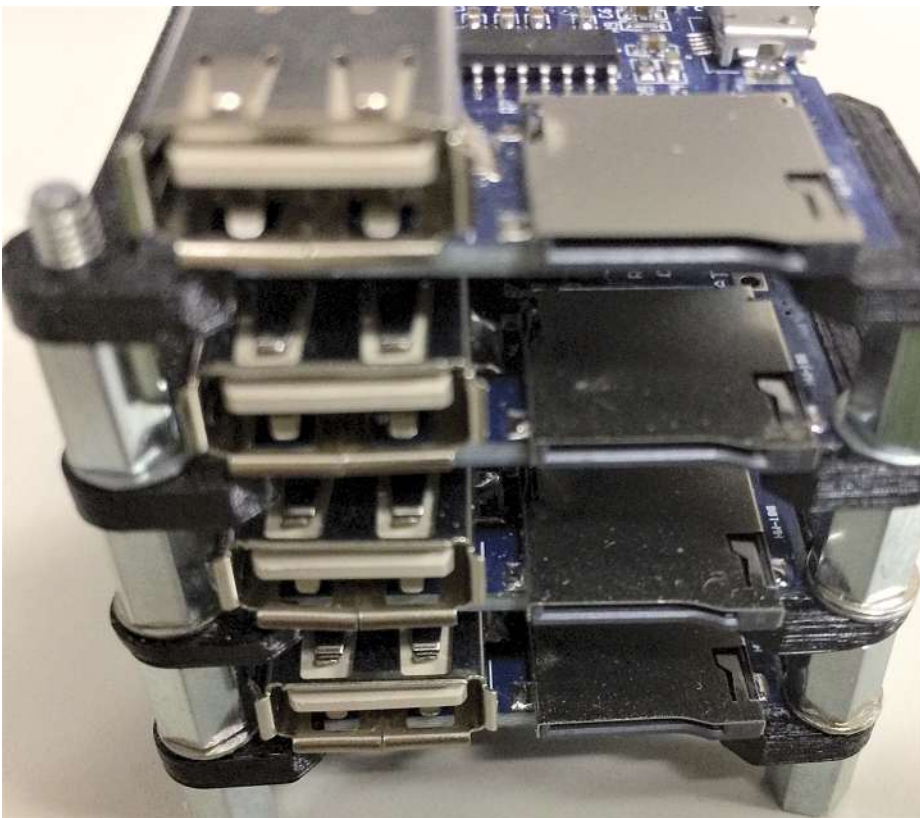
So kann man einen kompakten „Player“ mit gedruckten Abstandhaltern aufbauen.
