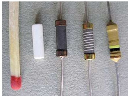
Bild 32. Werdegang eines Kohleschichtwiderstandes, ca. 1970er-Jahre.
