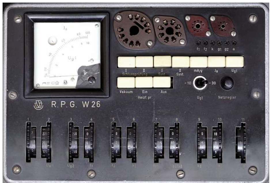
Bild 4. W26. Links oben befindet sich das 2. Instrument für den Netzspannungsabgleich.
