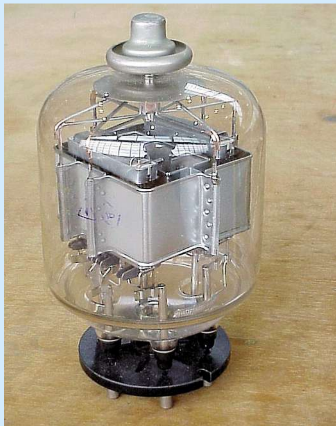
Schaltröhre einer sowjetischen P-15-Flat-Face-Radaranlage. Röntgenstrahlung entsteht beim Auftreffen der Elektronen auf die Innenseite der Anode (quadratisch gebogenes Blech).
