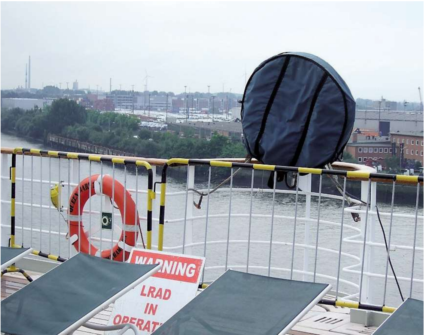
Bild 20. „Long Range Acoustic Device“-Installation auf dem Luxusship RMS „Queen Mary 2“. Damit sollen Piratenangriffe abgewehrt worden sein.
