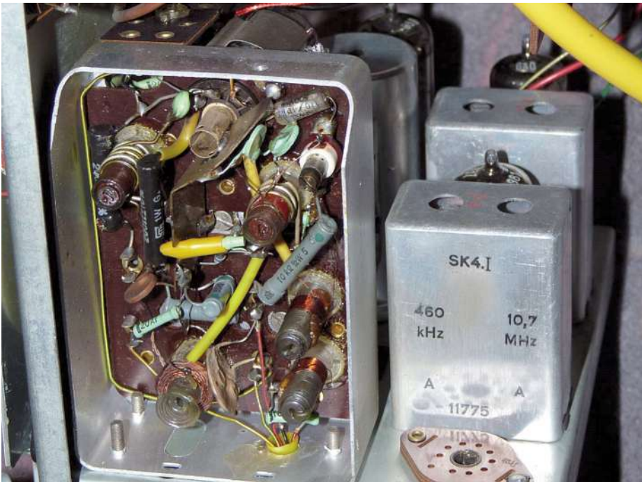
Bild 13. Detailansicht mit offenem UKW-Teil im Originalzustand. Oben die ECC85, unten links die MW-Oszillatorspule. Die erste EF89 (rechts) ist entfernt.
