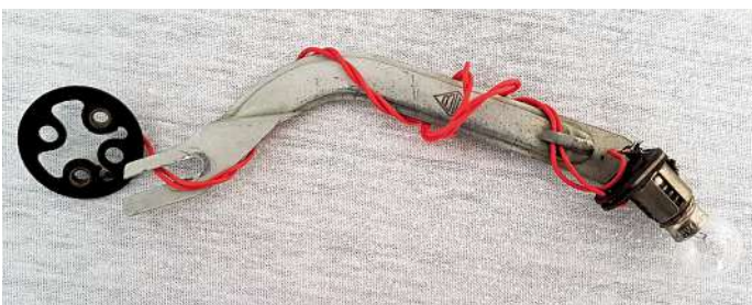
Bild 5. Nachträglich einzubauende Beleuchtung für den „VE301W“.
