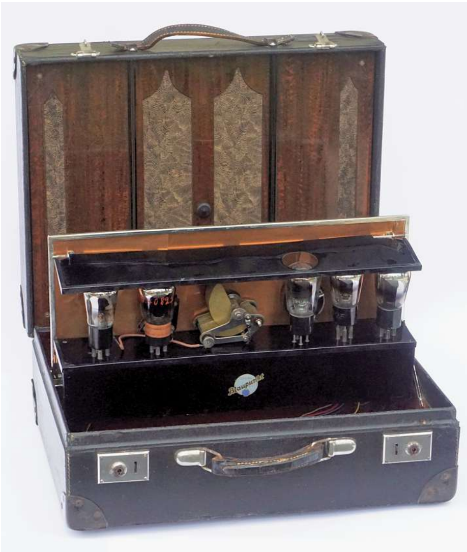
Bild 3. „KS5“ mit hochgeklapptem Chassis.
