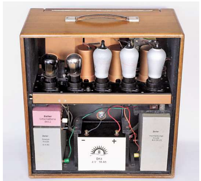
Bild 8. „TS5“-Rückansicht mit Batterienachbildungen.
