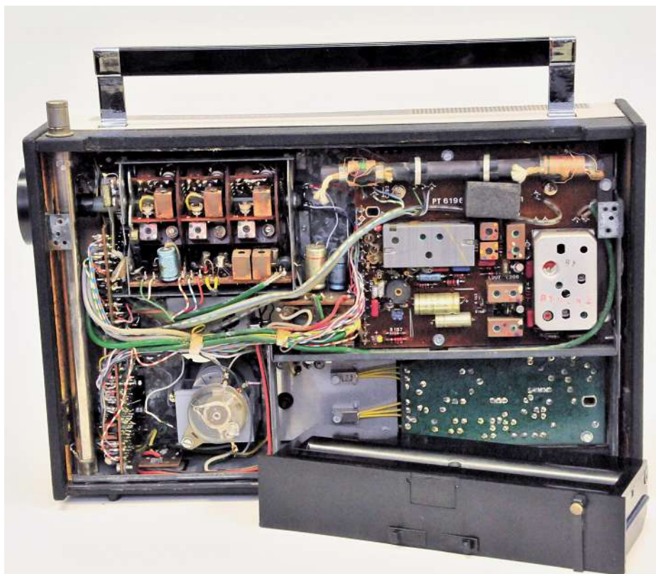
Bild 3. Geöffnete Rückseite mit Batteriekasten.
