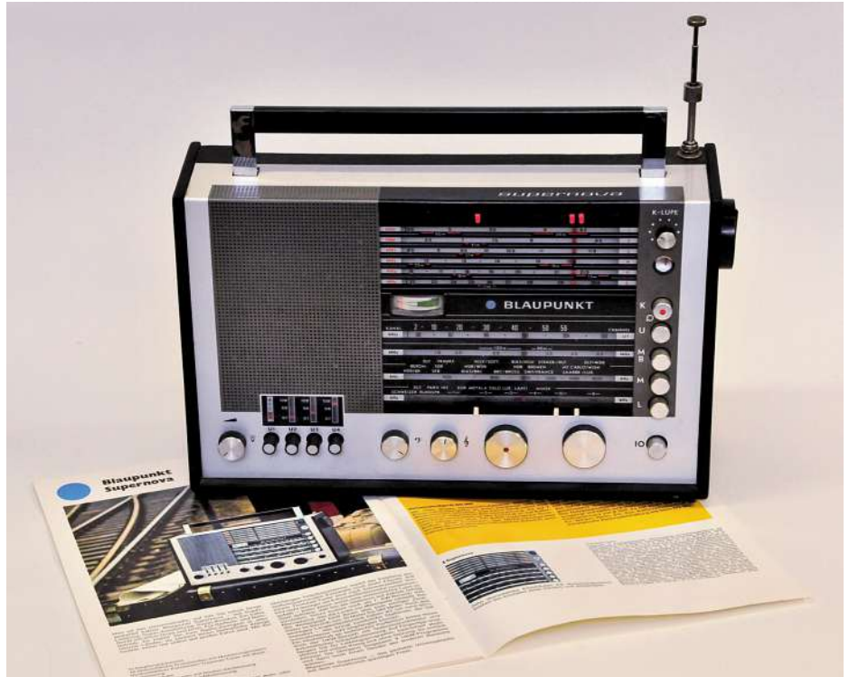
Bild 1. Blaupunkt „Supernova“. Die Antenne lässt sich in zwei Stufen ausziehen.
