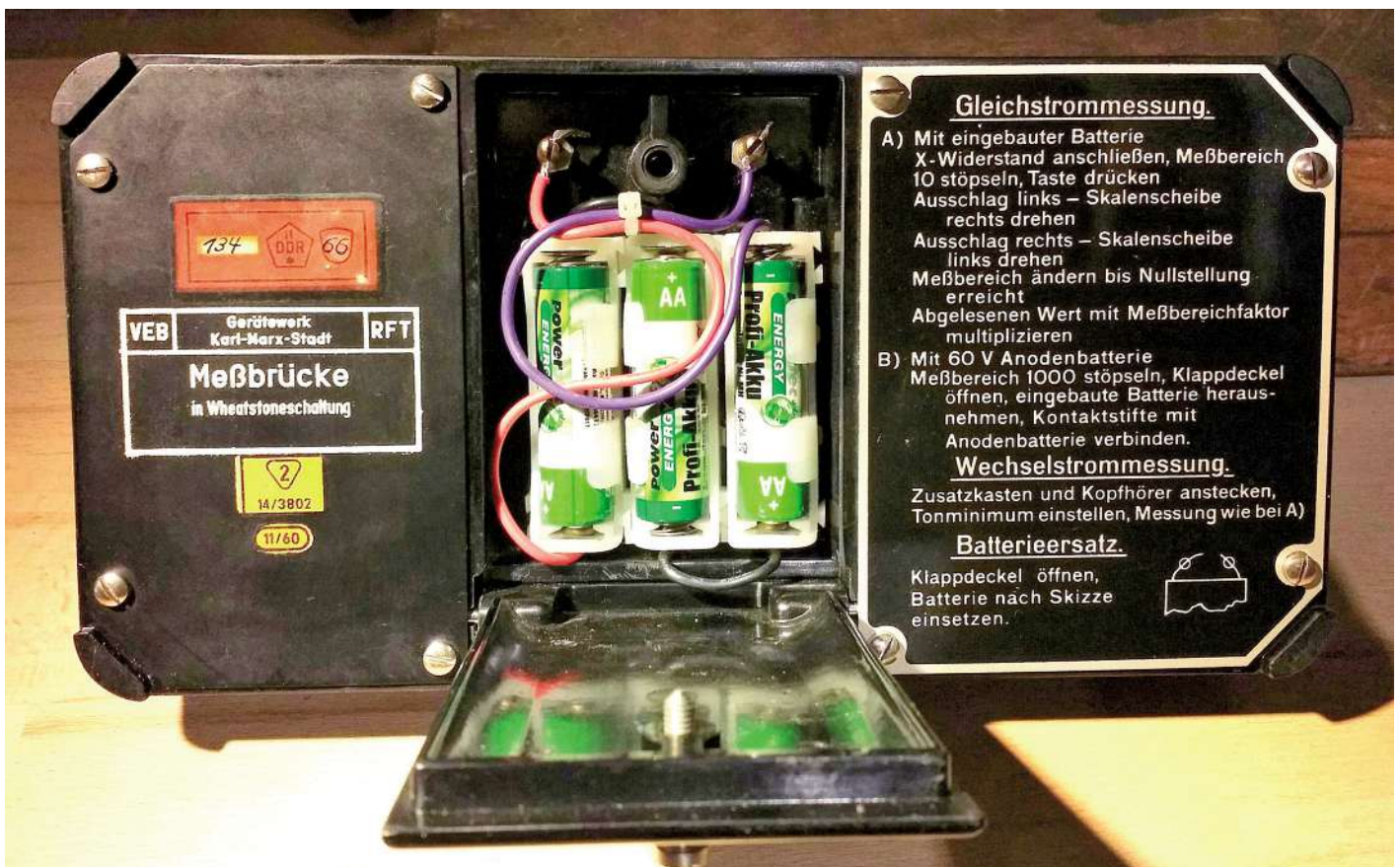
Bild 2. Unterseite mit Kurz-Bedienanleitung und Stütze für pulartige Schrägaufstellung.
