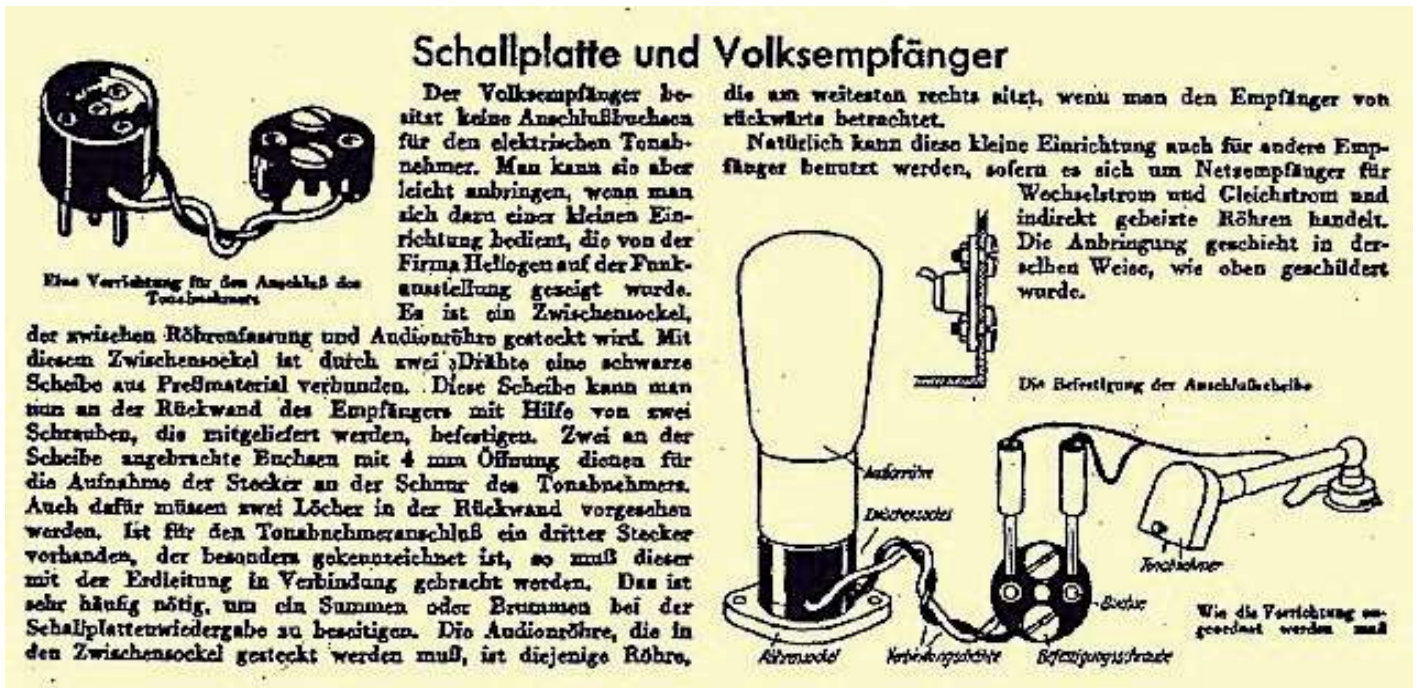
Bild 10. Schallplattenspieler-Anschluss am „VE“.
