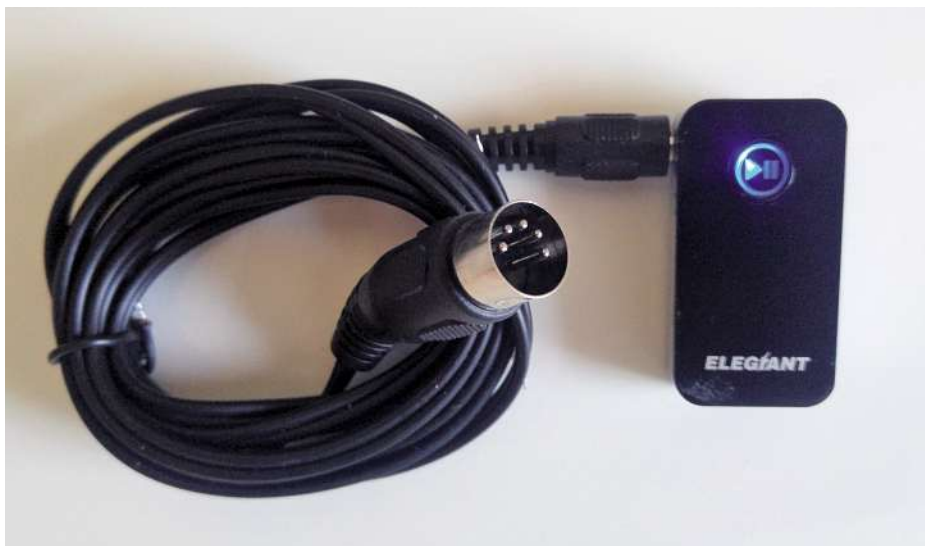
Bild 2. Adapter „Diode-Klinke“ mit Bluetooth-Empfänger.
