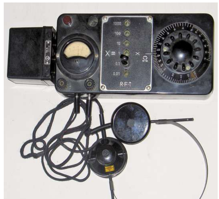
Bild 5. Kompletter Messaufbau mit Summer und Kopfhörer.
