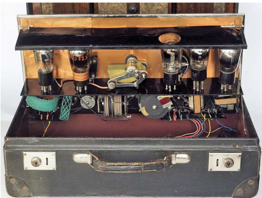
Bild 4. Das „KS5“-Chassis ohne Verkleidung.
