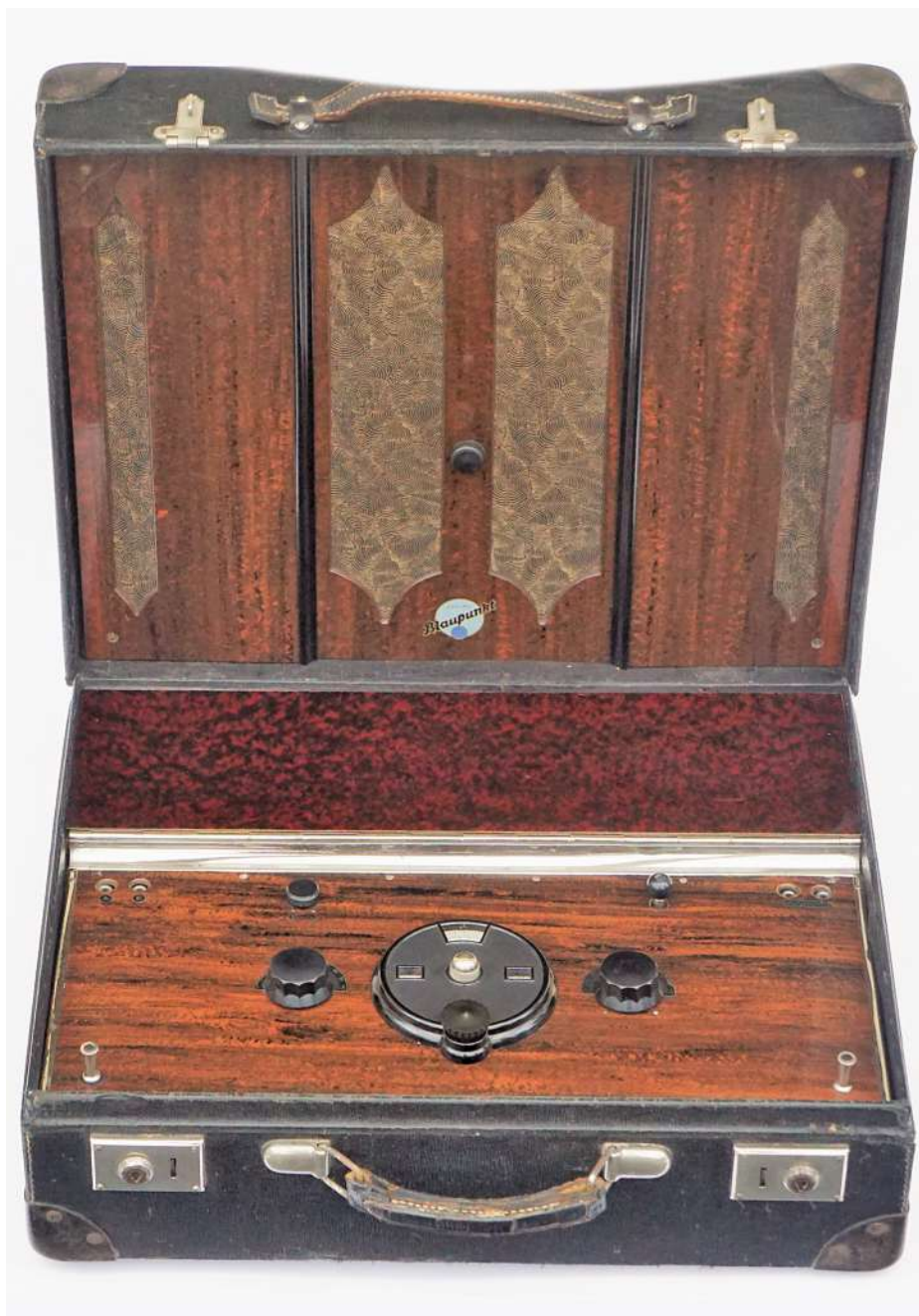
Bild 2. Der geöffnete „KS5“-Koffer (die dunkle Batteriefachabdeckung ist nicht original).
