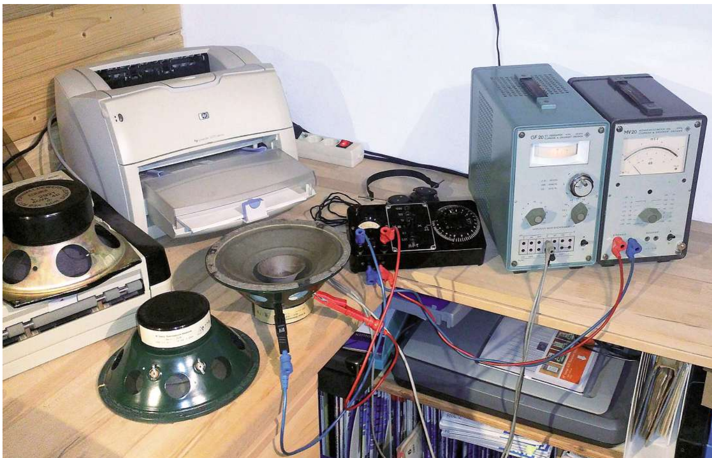
Bild 5. Messaufbau für Scheinwiderstandsmessung der Lautsprecher „KSP215“. „MV20“ als Kopfhörer, „GF20“ als Summer.
