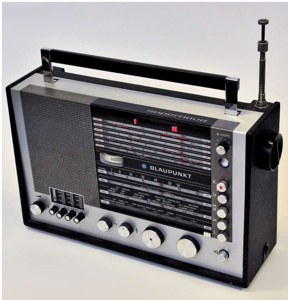
Bild 5. Seitlich sitzender Trommelschalter zur KW-Bereichswahl.
