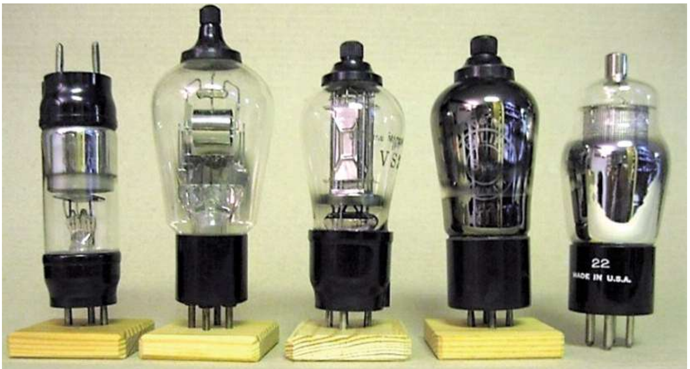
Bild 10. Schirmgitterröhren mit direkter Heizung: „S625“, Marconi-Osram, 1927; „RES044“, Telefunken, 1928; „VS24“, Marconi Genova, um 1928; „B442“, Philips, ca. 1927; „22“, USA, ab 1927.
