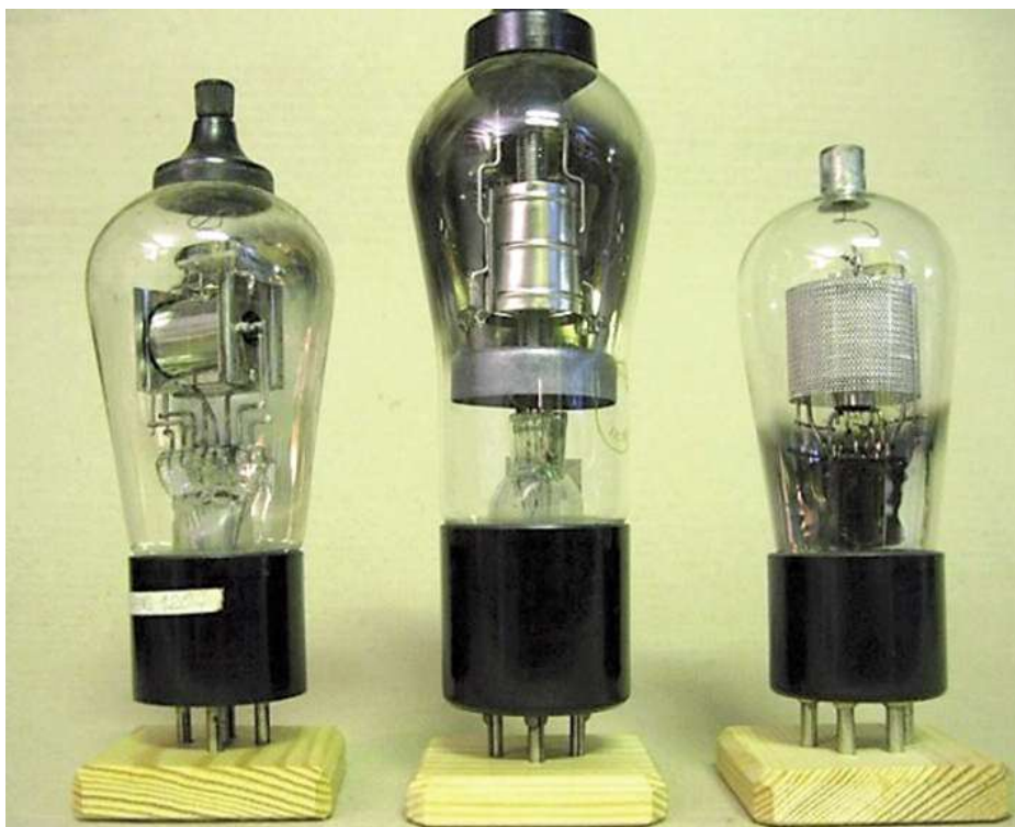
Bild 11. Schirmgitterröhren mit indirekter Heizung: „RENS1204“, Telefunken, diese 1930, mit entfernter Metallisierung; „CO149“, russische Fertigung, diese 1937; „UY224“, RCA, seit 1929.
