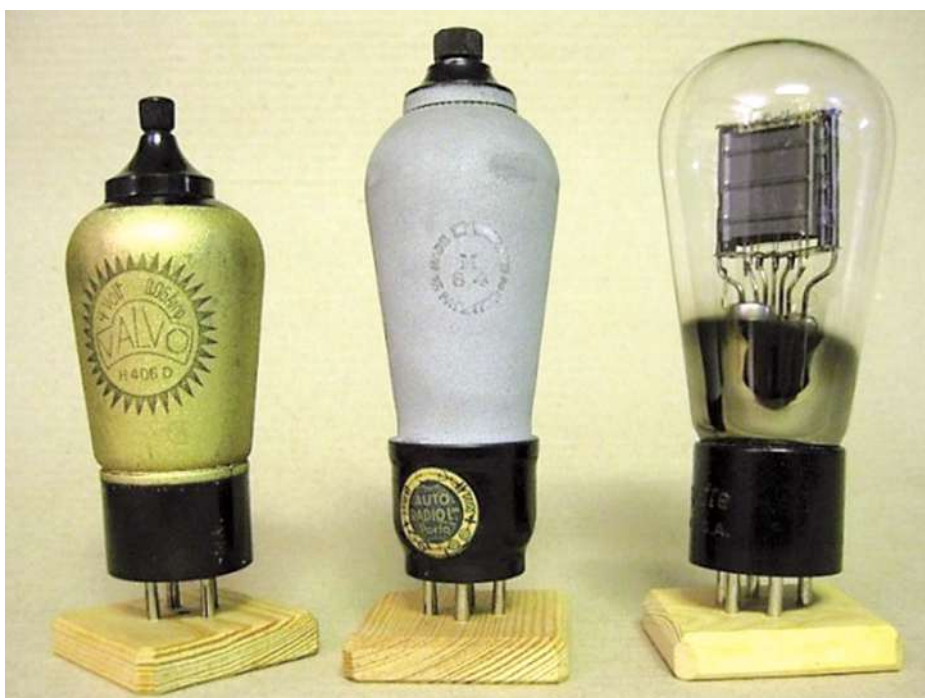
Bild 12. Abgeschirmte Röhren: „H406d“, Valvo, ab 1928; „MS 4“, Marconi-Osram; daneben: „46“, ab 1932, diese von Lafayette, die vermutlich einzige Schirmgitterröhre, die als Lautsprecherröhre gedacht war.
