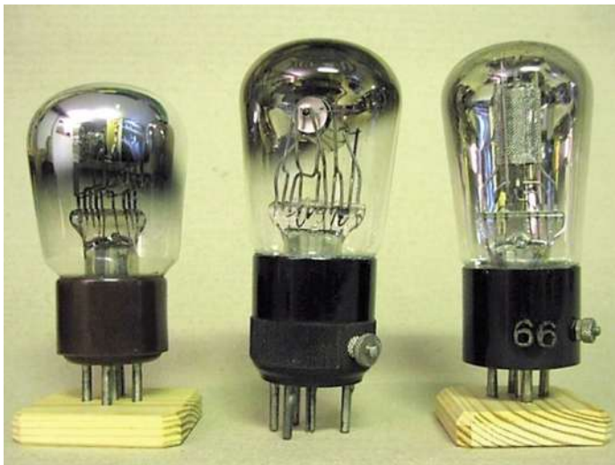
Bild 8. Raumladegitterröhren mit indirekter Heizung: „E441“, Philips, 1928; altes kastenförmiges System, aber mit Kathode statt Heizfaden; „Bigrille“, ca. 1928, altes rundes System mit Kathode statt Heizfaden; „RE704d, Telefunken“, 1929, neu konstruiertes System.
