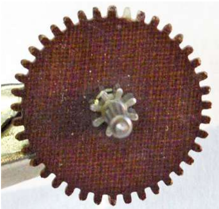
Bild 16. Repariertes Zahnrad des Synchronuhrwerks.
