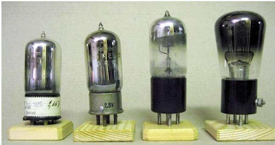
Bild 6. Raumladegitterröhren von Telefunken: „RE82“, 1925, thoriertem Faden; „RE212“, 1925, thoriertem Faden; „RE073d“, thoriertem Faden, 1927; „RE074d“, ab 1927, diese mit Bariumfaden, 1932.
