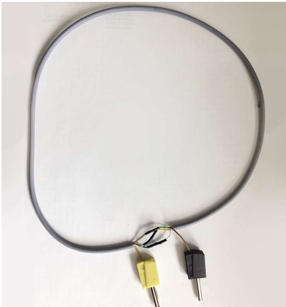
Bild 2. Aufbau einer Hilfsantenne.
