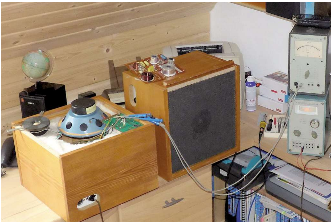
Bild 1. Messanordnung zum Ermitteln der Übergangs-Frequenz der Lautsprecherbox „TH215M“.
