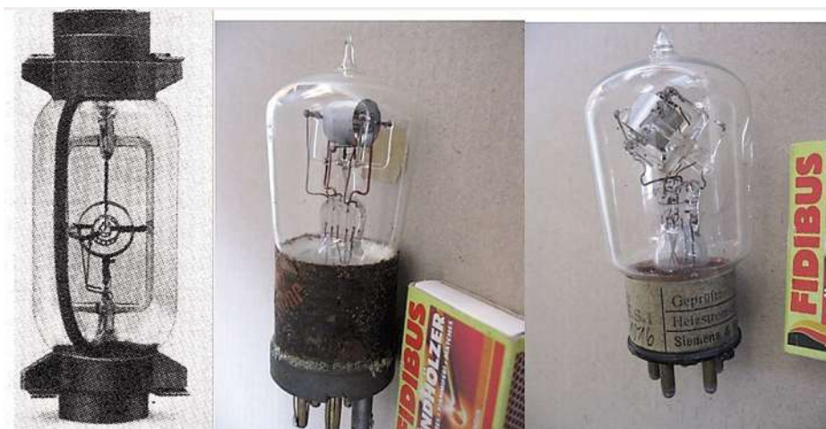
Bild 3. Frühe Schirmgitterröhren, von links: Röhre „SS“, liegend mit Messerkontakten, 1917, Verwendung in hochverstärkenden Zwei-Röhren-Verstärkern [9]; „SSI“, ältere Ausführung 1918; „SSI“, neuere Form (hier: Systemhalter gebrochen) mit Postsockel.
