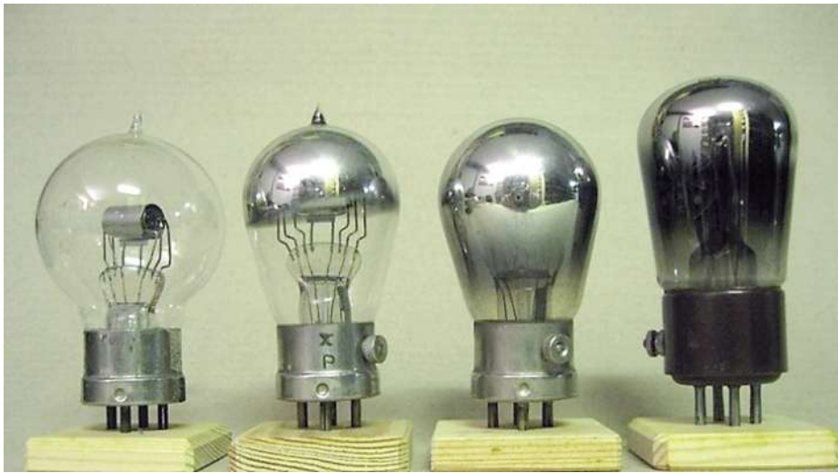
Bild 5. Raumladegitterröhren von Philips: „Q“, Wolframfaden, 1921; „B VI“, thoriertem Faden, 1924; „A 141“, thoriertem Faden, 1926; „A 441“, Bariumfaden, 1927.
