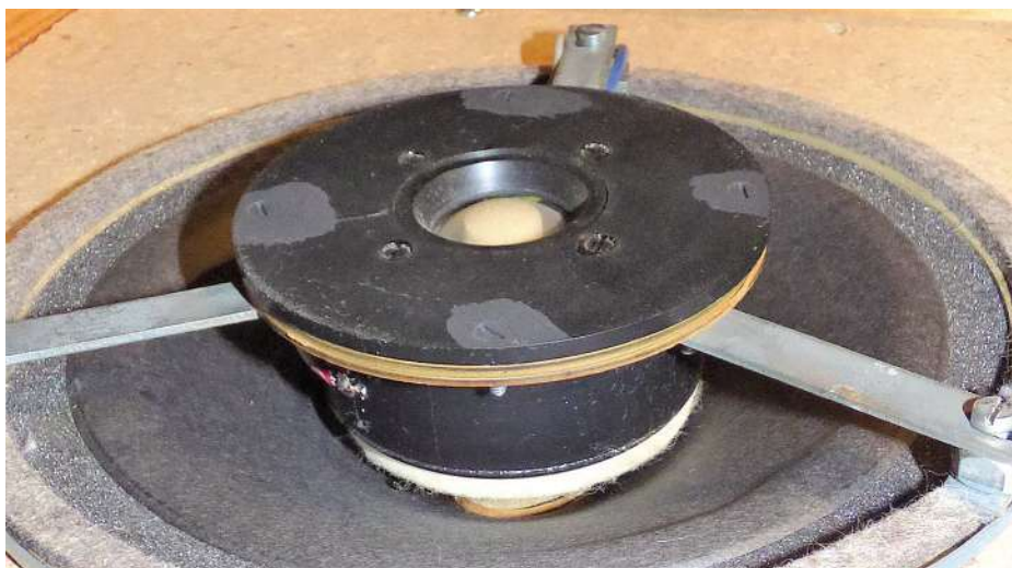
Bild 7. Axialmontage in der Box „TH215M“.
