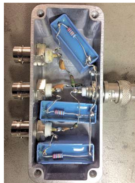
Bild 5. Aufbau einer Kopplung von drei Empfängern.
