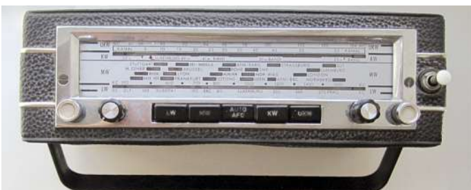
Bild 16: Universum-Autokoffer TR 754 AFC Typ 969354 mit Klangstellern (mittlere Knöpfe nicht original)
