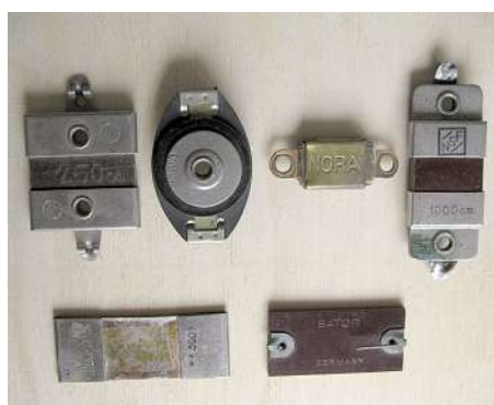
Bild 13: Glimmerkondensatoren der 1920er Jahre, von links oben: Fabrikat Saba (Schwarzwälder Apparatebau), Seibt, Nora, NSF (Nürnberger Schraubenfabrik), Agil, Sator
