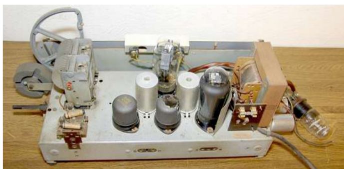
Bild 9: Chassis des Olympia 502 WM, einem Standardgerät, 1950
