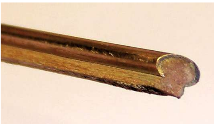
Bild 8: Messingzierleiste mit Holzkern
