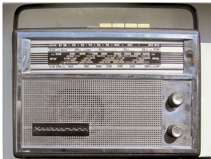
Bild 3: Neckermann 918911 mit Klangtaste (290 mm x 210 mm x 110 mm, 2,5 kg mit Batterien)
