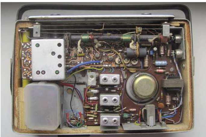
Bild 15: Zehn-Transistor-Autokoffer Simonetta 102984 mit senkrechter Zusatzplatine rechts auf der Tastenschalterplatine, Autohalterungsbuchse unten mitte links
