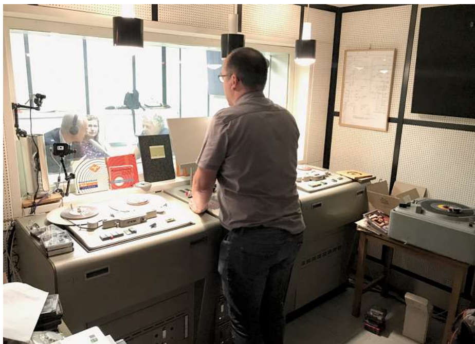
Bild 5: Musik vom Band oder von der Platte. Zwei Bandgeräte Telefunken M5, ein Phonogerät EMT 930, ein Otari-Cart-Player (beide nicht zur Originalausstattung von 1965 gehörend), zwei Mikrofone MD421 Fotos: Hans Neuhaus (2)
