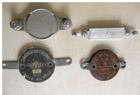
Bild 14: Glimmerkondensatoren der 1920er Jahre, von links oben: Fabrikat Ducati (Italien), französische Fabrikate Wireless, Simplex, Le Mikado
