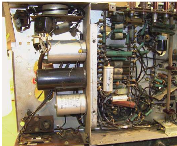
Bild 15: Chassis von unten, Detailaufnahme der Netzelkos
