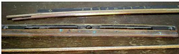
Bild 4: Messingblende der Tastatur vor der Restauration
