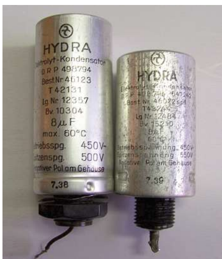
Bild 17: Vergleich der Elkos T 898 (links) und D 770 WKK (rechts)
