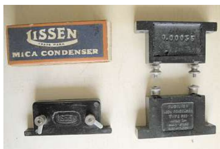
Bild 15: Glimmerkondensatoren der 1920er Jahre nach Dubilier, englische Fabrikate. Links Lissen mit Verkaufsverpackung; rechts: Fabrikat unbekannt, Ober- und Unterseite
