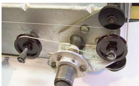
Bild 19: Antriebsachse des Skalenseilantriebs
