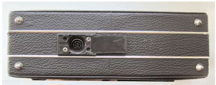
Bild 7: Anschlussbuchse für die Autohalterung (mit offenem Plastikschieber)
