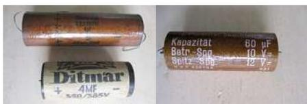
Bild 31: Gewickelte Elektrolytkondensatoren in Rohrform, etwa 1930er Jahre. Links Hochvolttypen für Netzteile, rechts Niedervolttyp zur kapazitiven Überbrückung des Kathodenwiderstandes einer Endröhre
