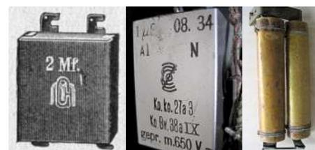
Bild 23: Wickelkondensatoren für die Telefontechnik. Links von Mix & Genest, etwa 1914 [10]; mitte Kondensator in einem Telefonapparat W28 der Firma Zwietusch, 1934; rechts offene Wickel, vermutlich um 1910
