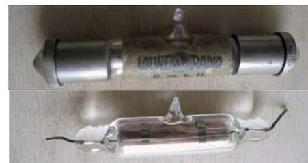
Bild 18: Wickelkondensatoren von Loewe aus Kupfer und Glimmer 1926 [23], oben mit Anschlüssen zum Einzelverkauf, unten zum Einbau in Mehrfachröhren
