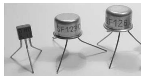
Bild 8: HFO-Si-Planartransistoren. a) Herstellung im Reinraum in Halle 6; b) Si-Transistoren Miniplast, SF 123 und SF126
