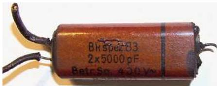
Bild 23: Doppelkondensator zur Entstörung
