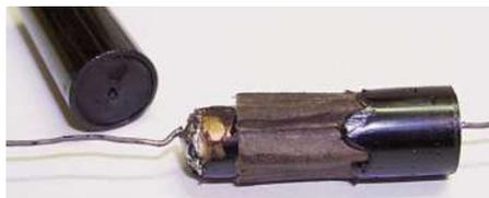
Bild 24: Kondensator aus dem Glasröhrchen entfernt mit Stopfen. Daneben das Glasröhrchen, in dem der andere Stopfen verblieben ist. Man beachte die dicken Anschlussdrähte
