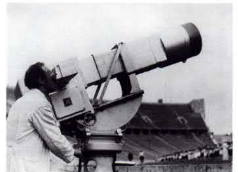
Bild 7: „Fernseh-Kanone“ von Telefunken während der Olympischen Spiele, 1936
