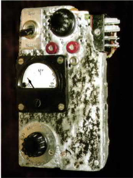
Bild 17: Korrosionsschäden an der Frontseite des Messmoduls
