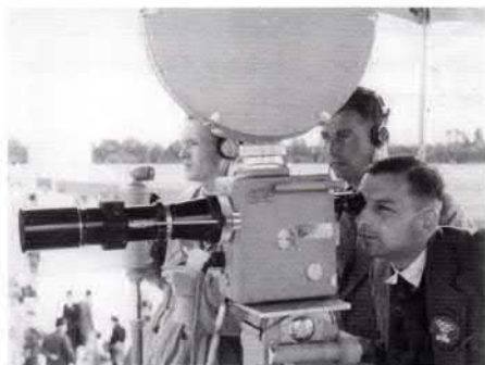
Bild 4: Zwischenfilmkamera. Die Filmrolle enthält den beschichteten Rohfilm, das belichtete Material wird in die Entwicklungskammer geführt
