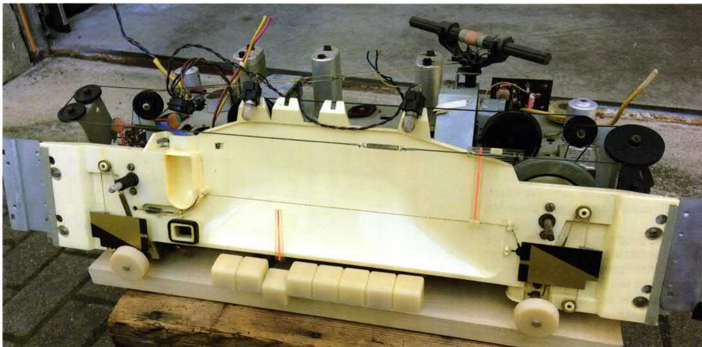
Bild 3: Ausgebautes Chassis mit Kunststoffteil als Skalenhintergrund
