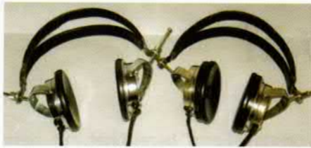
Bild 14: Einfacher BTA-Kopfhörer (links, um 1925/26) und pseudostereofonische Ausführung (rechts, um 1927/28)
