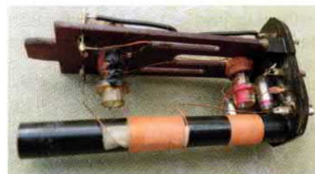
Bild 5: Recht einfach aufgebautes Bandfilter
