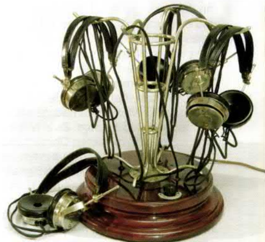
Bild 7: Hörvorrichtung mit Ständern für vier Doppelkopfhörer
