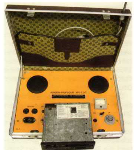
Bild 4: Servicegerät KPG 0247 für den Außendienst zum Testen der Autoradios
