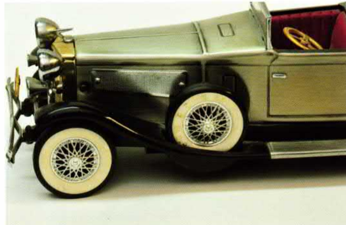
Bild 16: Senderwahl und Lautstärke werden an den beiden Ersatzrädern bedient
