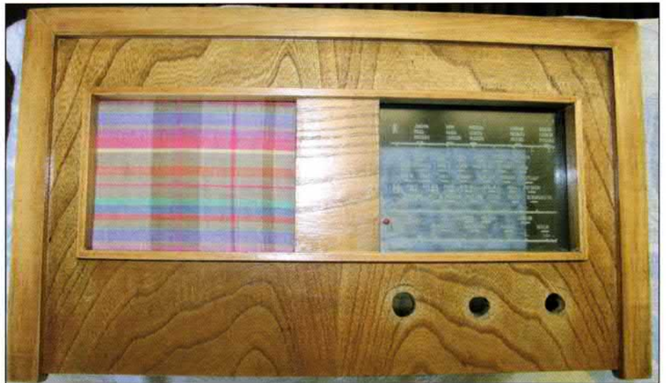
Bild 7: Gehäuse nach Montage des Lautsprecherrahmens und der Senderskala
