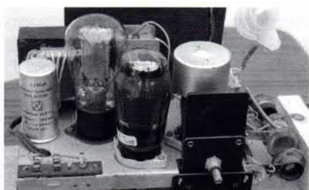
Bild 11: „Heinzelmann W“ von 1948 mit Blechchassis
