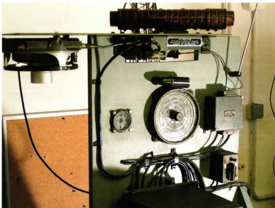
Bild 2: Holzbrett mit den Komponenten des PeilGe6; in der Mitte der Rahmendrehschalter, links das Anzeigeelement AFN2
