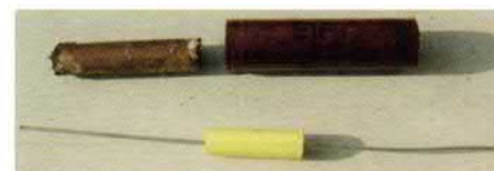
Bild 6: Restaurierung des Kondensators. Links der aus der Hülse geschobene Kondensatorwickel, rechts die Papphülse und darunter ein neuer MKP-Kondensator zum Einbau in die Papphülse.
