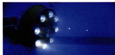
Bild 5: Hi-Vision-Unterwasserkamera mit großem Scheinwerferkranz. Wegen der Stromversorgung ist (noch) eine Kabelverbindung zum Begleitschiff nötig Foto: NHK
