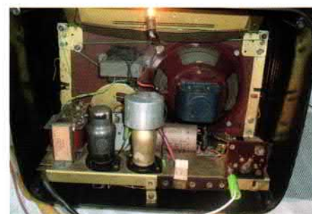
Bild 15: Innenansicht eines „Heinzelmann 126 W“ mit E-Röhren
