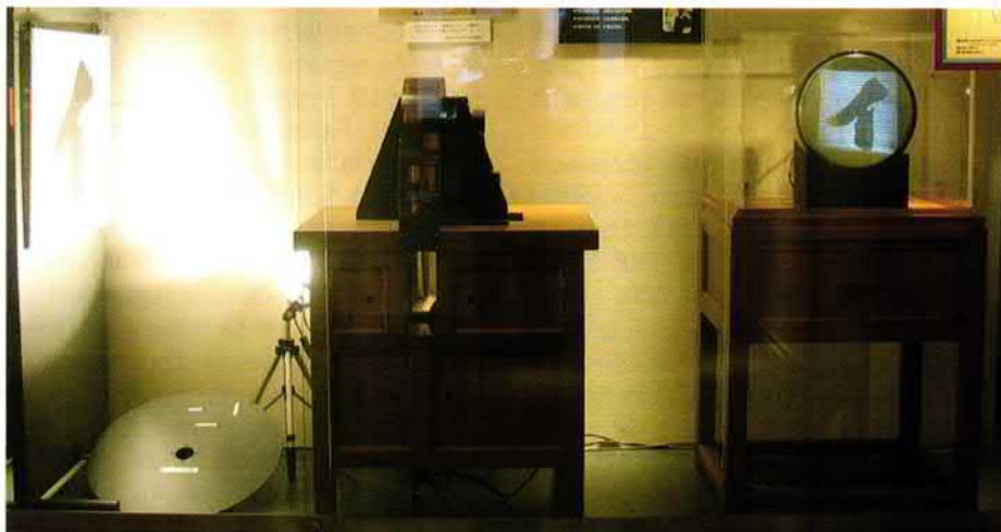
Bild1: Nipkowscheibe mit Photozelle auf der Aufnahme- und Braunschwerer Röhre auf der Wiedergabeseite. Im NHK-Museum ist der Blick in die Vergangenheit recht spannend Foto: NHK
