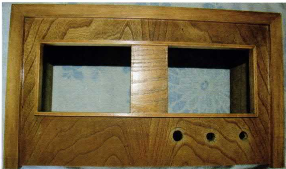
Bild 4: Das Gehäuse nach dem Aufarbeiten
