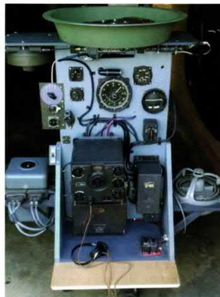
Bild 6: Vorderansicht der Patin-Kurssteuerung um der Peilgerät PeilGe6 herum gebaut
