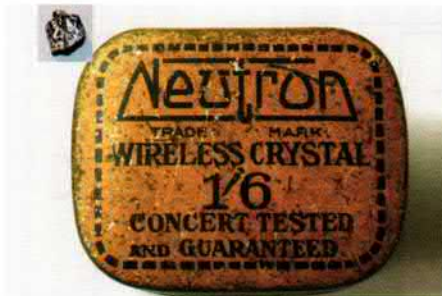
Bild 4: Aufbewahrungsbox für einen Detektor-Kristall aus Bleiglanz, der Kristall ist im Bild oben links zu sehen
