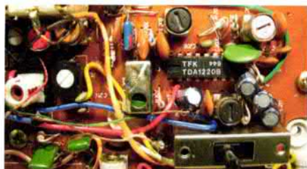
Bild 16: AM/FM-Schaltkreis TDA1220, der im Grundig-Kofferradio Music Boy 60 verwendet wurde Bilder 13 bis 15: Archiv Infineon
