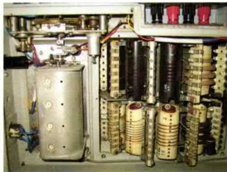
Bild 10: Die Unterseite mit Spulensätzen und Drehkondensator
