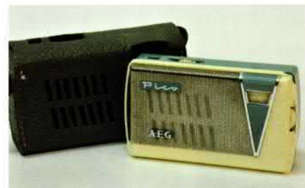
Bild 15: AEG Pico um 1960, baugleich mit Telefunken Mini-Partner mit Telefunken-Transistoren, auch kein Japaner
