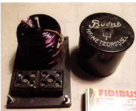
Bild 27: Hochfrequenz-Netzdroßspule zur Störunterdrückung, Fa. Budich, 1930er Jahre
