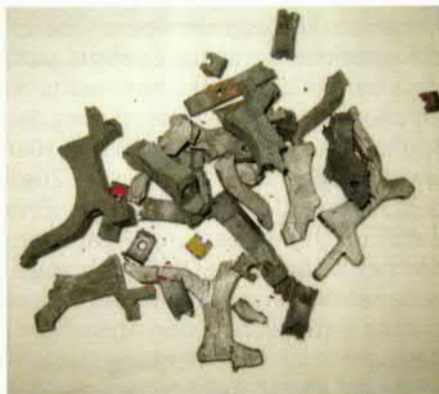
Bild 4: Die Spulenhalter aus Aluguss zerlegen sich
