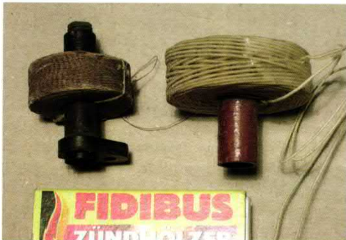
Bild 23: Kreuzwickelspulen: rechts Spulensatz eines Gerätes um 1930, mit „Käfigspule“; der Käfig sollte als Abschirmung wirken
