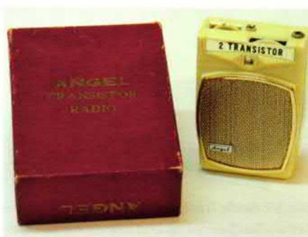
Bild 6: Angel TR-25, ein typisches Boy's Radio mit 2 Transistoren und Anschlüssen für Ohrhörer und Wurfantenne, hergestellt in Japan für Arrow Trading New York, um 1959
