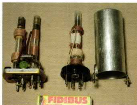
Bild 25: Bandfilter mit Kreuzwickelspulen der 1950er Jahre
