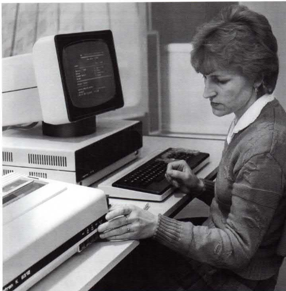
Bild 8: PC 1715, das Standardgerät der 80er Jahre, technisch vergleichbar einem 8086 (XT) Personalcomputer
