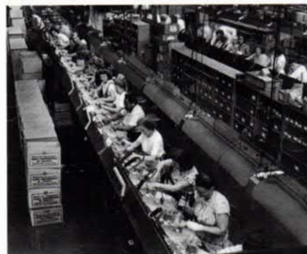
Bild 10: Fernsehgerätefertigung bei RCA in den Jahren 1946/47
