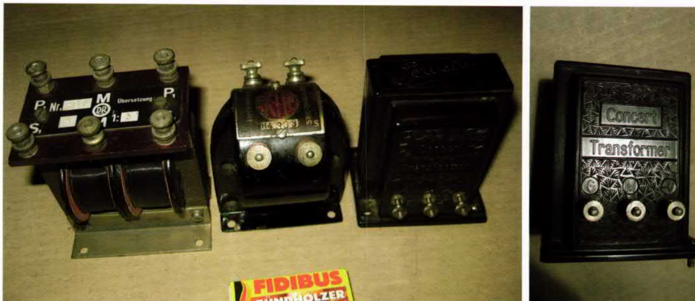
Bild 28: Niederfrequenz-Koppeltransformatoren der 1920er Jahre; man beachte die Bezeichnung „Concert Transformer“ auf dem Trafo von Budich
