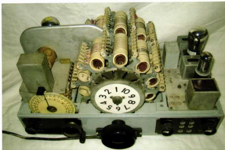
Bild 1: So sieht mein H2L/7 ohne Gehäuse aus
