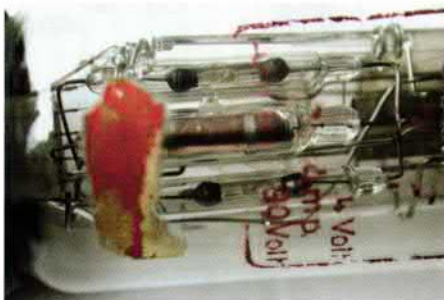
Bild 11: Gut sichtbar sind die eingeschmolzenen Widerstände und Kondensatoren
