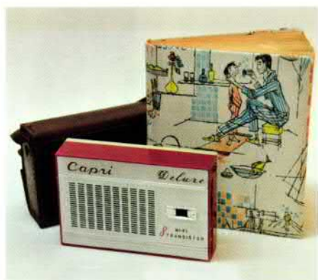
Bild 11: Transistorempfänger mit Lederhülle, Capri deluxe Hifi DMS-801A, Dia Musen Sangyo Tokyo 1959
