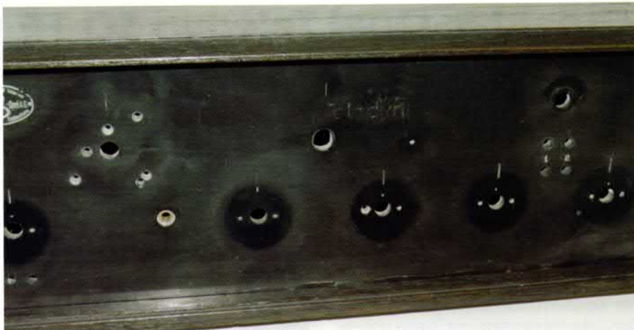
Bild 11: Frontplatte des Teledyn mit extra Bohrungen
