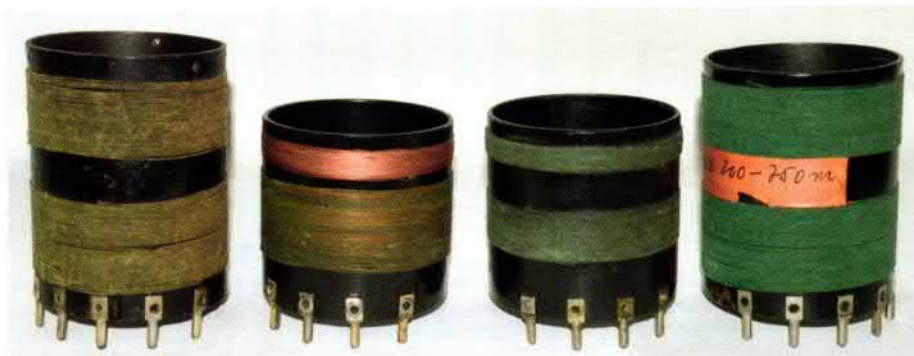
Bild 15: Mittelwellen-Spulensätze. Die zweite von links ist die Replik
