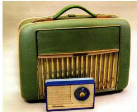
Bild 14: Größenvergleich, Röhrenkofferradio Bajazzo (1956) und 6-Transistor-Radio TR86 von Crown (1958)
