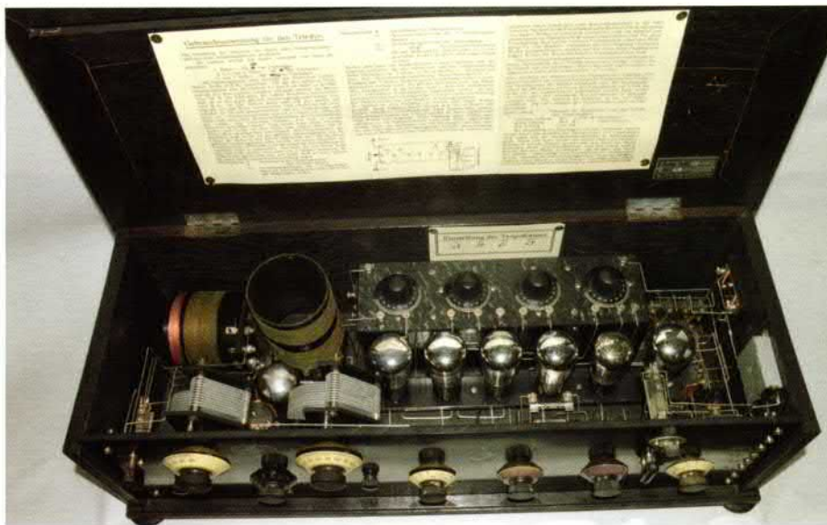
Bild 16: Fertig verdrahteter und bestückter Teledyn Nr. 103
