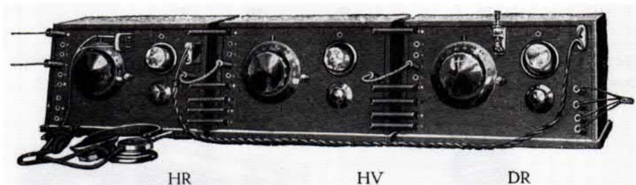
Bild 6: Der Rundfunkempfänger Arcon bestand aus drei Stufen (HR, HV und DR) mit je einer Röhre, ca. 1925 [4]
