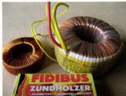
Bild 16: Ringkerndrossel und -transformator aus den 1970er Jahren
