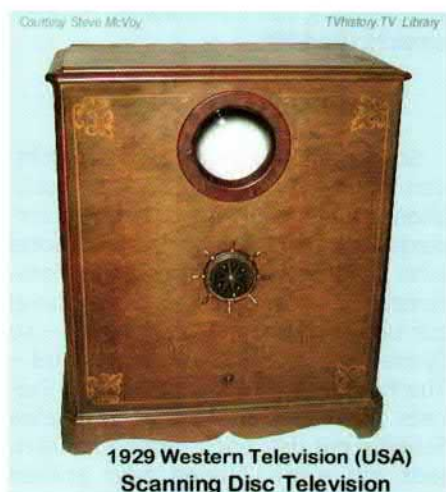
Bild 4: „Scanning Disc Television“ von Western Television aus dem Jahre 1929 Foto: Steve McVoy/TVhistory.TV Library
