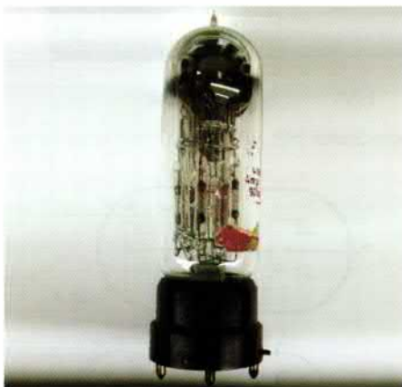
Bild 10: Diese Mehrfachröhre 3NF (4V Heizspannung und 90V Anodenspannung) ist heute noch funktionsfähig
