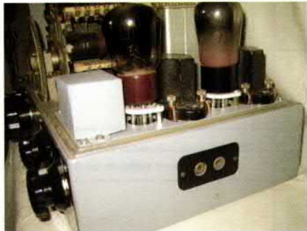
Bild 9: Die rechte Seite mit Röhren und Übertragern
