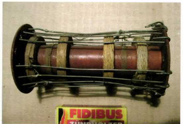
Bild 23: Kreuzwickelspulen: rechts Spulensatz eines Gerätes um 1930, mit „Käfigspule“; der Käfig sollte als Abschirmung wirken
