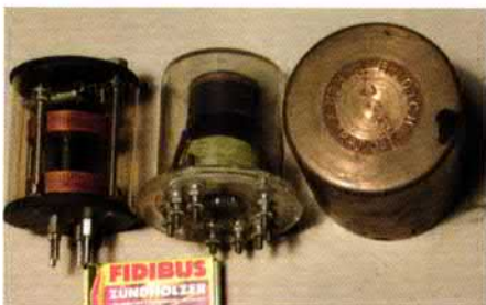
Bild 24: Bandfilter der 1930er Jahre, links steckbar, englisches Fabrikat, rechts mit Kontaktschrauben und Abschirmbecher der Fa. Budich.
