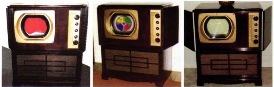
Bild 12: Das CBS-Columbia-Farbfernseher-Modell 12CC2 mit einer 12-Zoll-Röhre kann neben 525/60 monochrom auch Farbe mit 405 Zeilen Foto: Early Television Museum, Hilliard, OH
