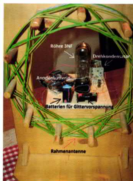
Bild 17: Nachbau des Ortsempfängers Loewe OE333 mit Anodenbatterie, Batterien für die Gittervorspannung, Rahmenantenne, Drehkondensator und Übertrager in fliegender Verdrahtung
