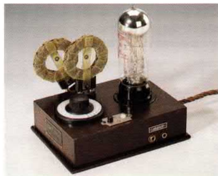
Bild 8: Rundfunkortempfänger Loewe OE333 mit der Dreifachröhre 3NF commons.wikimedia.org/w/index.php?curid=16952322
