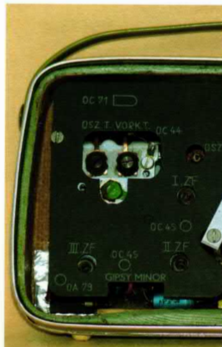
Bild 14: Falscher Aufdruck auf der Platinenabdeckung: der Aufdruck GIPSY MINOR vom Vorgängermodell ist im neuen Modell gelandet
