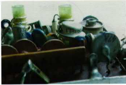
Bild 7. GT 313 und GT 322 in einem UKW Tuner vom Antennenwerk Blankenburg von 1975
