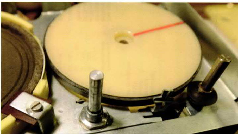
Bild 4: Der Skalentrieb nach dem Umbau auf Reibradantrieb
