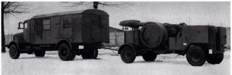
Bild 7: Richtverbindungsgerät Stuttgart: Fahrzeug mit Anhänger marschbereit Bilder 5 bis 7: Firmenbeschreibung 75/803 des Richtfunkgerätes FuG 03 Stuttgart der Firma C. Lorenz AG vom September 1944; Archiv W. Thote
