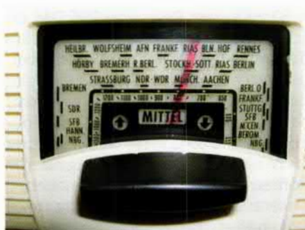
Bild 5: Die MW-Skala und der Kaugummidrehknopf Bild: GFGF Archiv
