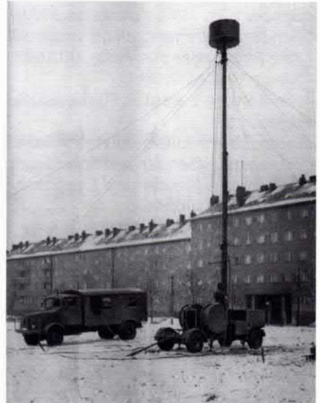
Bild 5: Das betriebsfertig aufgebaute Richtverbindungsgerät Stuttgart mit nur halb ausgefahrenem Mast und Antenne
