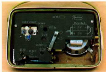
Bild 16: Boy 6 Innereien mit Platinenabdeckung: ein Transistor eingespart
