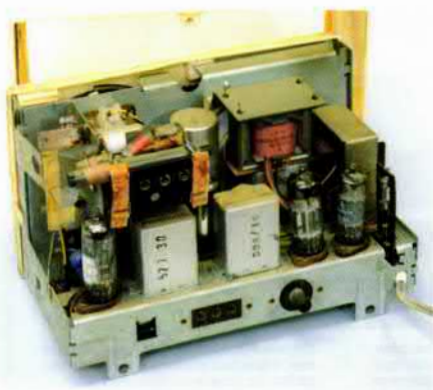
Bild 10: Das komplette Innenleben lässt sich mitsamt der Frontplatte herausziehen
