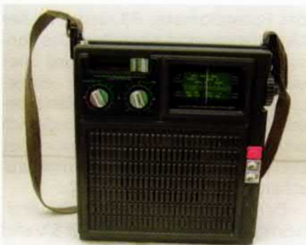
Bild 5: Stern Garant R2130 mit Trageriemen im Military-Look; die Skala war ein bewegliches Band aus Folie, das Teil hatte einen geteilten Mittelwellenbereich
