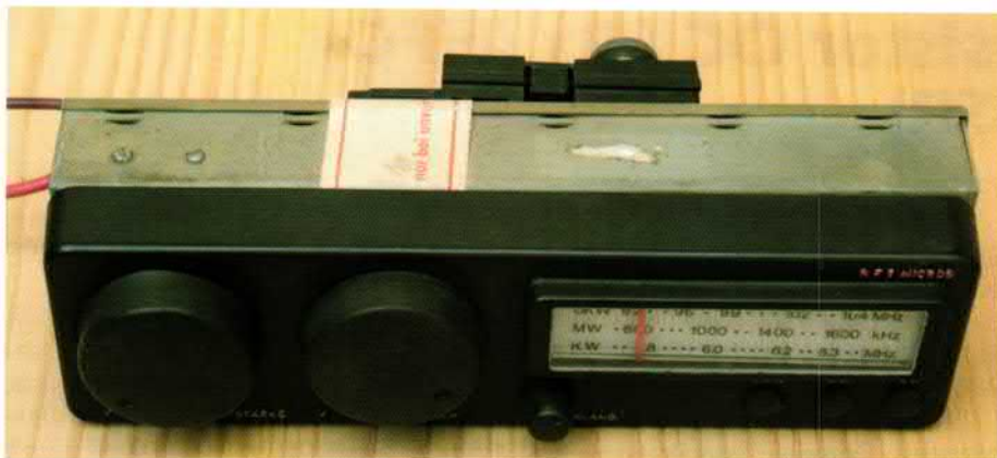
Bild 8: Autoradio A 150 MICROS mit nur 45 mm Einbautiefe
