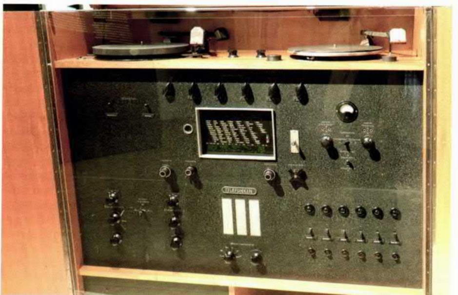
Bild 4: Für Propaganda: Betriebsempfänger Ela Z 793. Telefunken 1941
