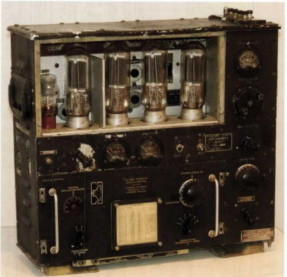
Bild 8: Sender BC-191-F, hergestellt von General Electric, ohne Abdeckung Röhrenfach. Dieser Sender wurde nach 1945 mit italienischer Beschriftung als Trasmittore BC-191-F betrieben. Röhrentypen (von links) 10Y, VT-4C, VT-4C, VT-4C, VT-4C
