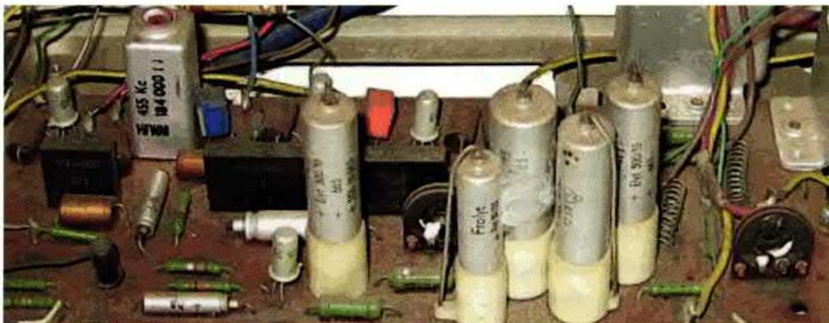
Bild 7: KME3 im Bellatrix (drei schwarze Blöcke) - die blauen und orangen Würfel sind die Piezofilter
