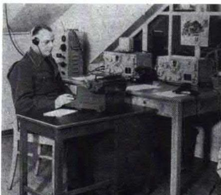
Bild 2: Arbeitsplatz in einer Polizeileitfunkstelle. Auf dem Tisch zwei Empfänger E-348, im Hintergrund ein Sender S-191-A (entnommen [1])
