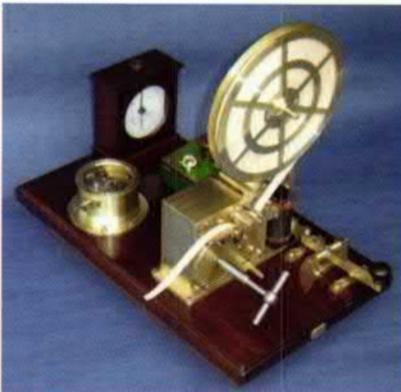
Bild 10: Morse-Drucker von Siemens Halske, ein späteres Modell von 1872
