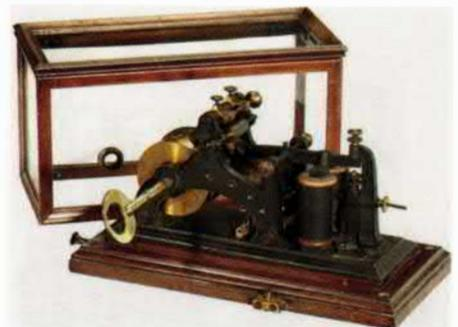
Bild 9: Drucker zum Empfang der Morsesignale, wie er bei der Bahn in Deutschland verwendet wurde
