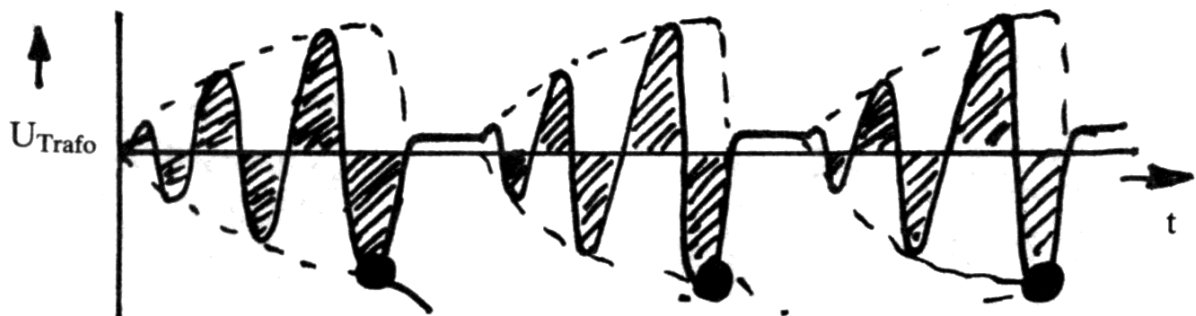
Spannungsverlauf der NF-Schwingung am Resonanzübertrager
