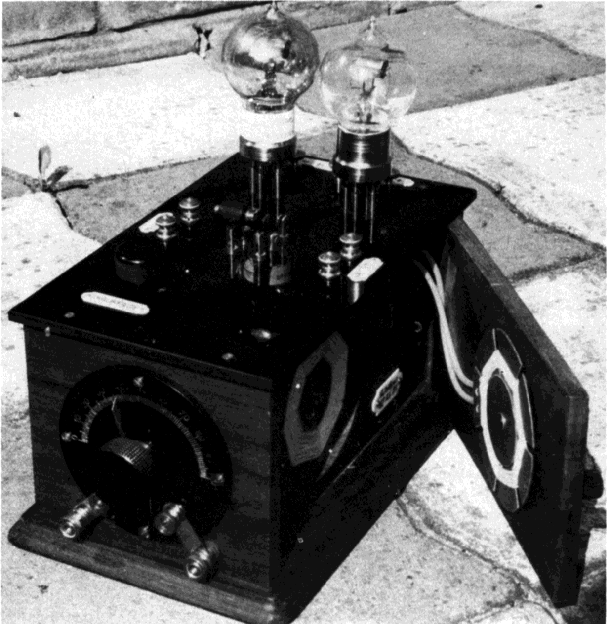
Bild 2: Ansicht des nachgebauten Autodyne Reflex-Empfängers
