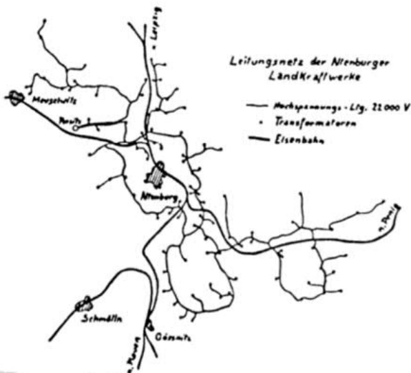
Bild 2: Im Leitungsnetz der Altenburger Landkraftwerke fanden 1924 die ersten Versuche statt.
