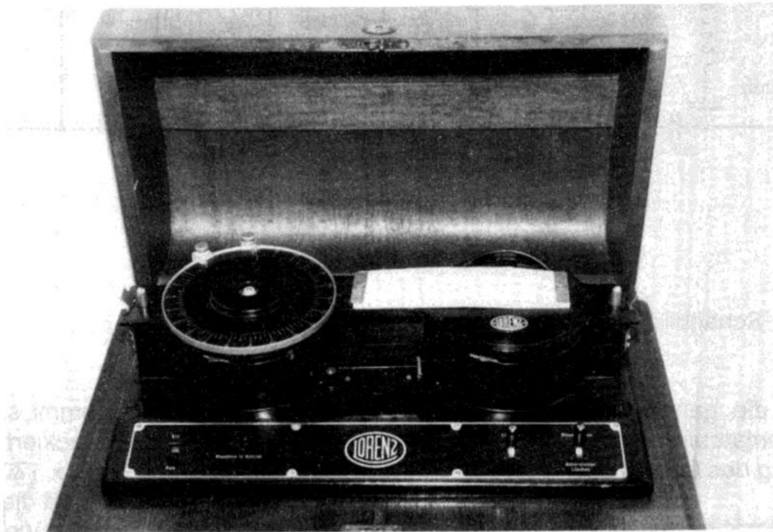
Bild 1: Drahttongerät von oben (Deckel geöffnet), Bedienteil mit Drahtspulen
