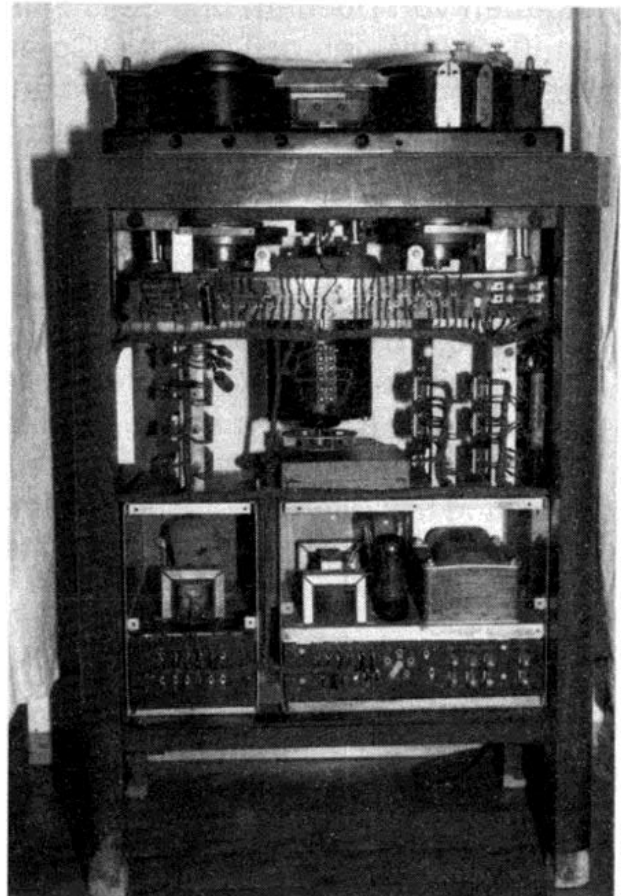
Bild 4: Rückansicht mit Verstärker, Netzteil und Relaissteuerung
