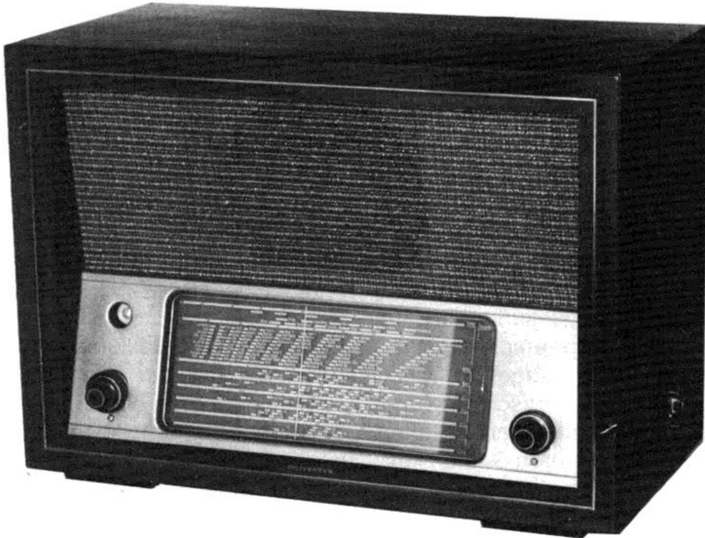
Bild 1: Telefunken T166WK, Baujahr 1941- 44. K, M, L und 5 gedehnte Kurzwellen-Bereiche für das 13, 16, 25, 31 und 49 m Band. Abstimmung der gedehnten KW- Bereiche mittels Veränderung der Induktivität. Röhren: ECH11, EBF11, EF11, EL11, AZ11, EM11.
