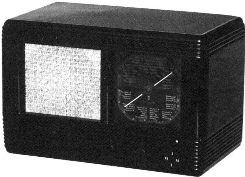
Bild 2: Lorenz 10 A, Baujahr 1941-42, K, M, Röhren: UCH11, UBF11, UCL11, UY11.
