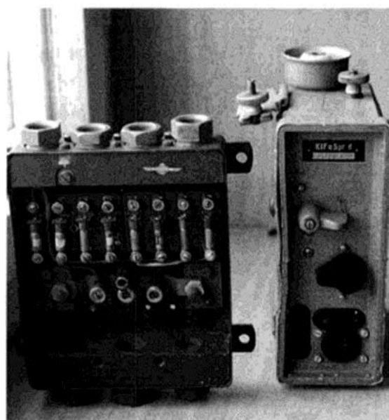
Bild 11: Kleinfunksprecher d "Do-rette" und Sicherungskasten für Pz.-Fahrzeuge
